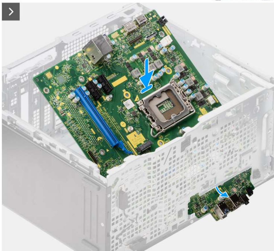
Obrázek 88. Montáž základní desky
