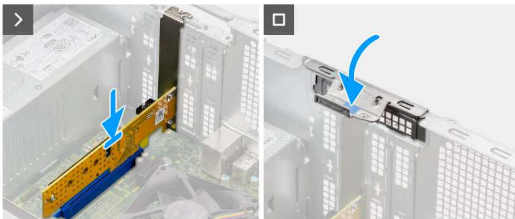
Obrázek 30. Montáž karty Dell Ultra Speed Drive 3. generace
