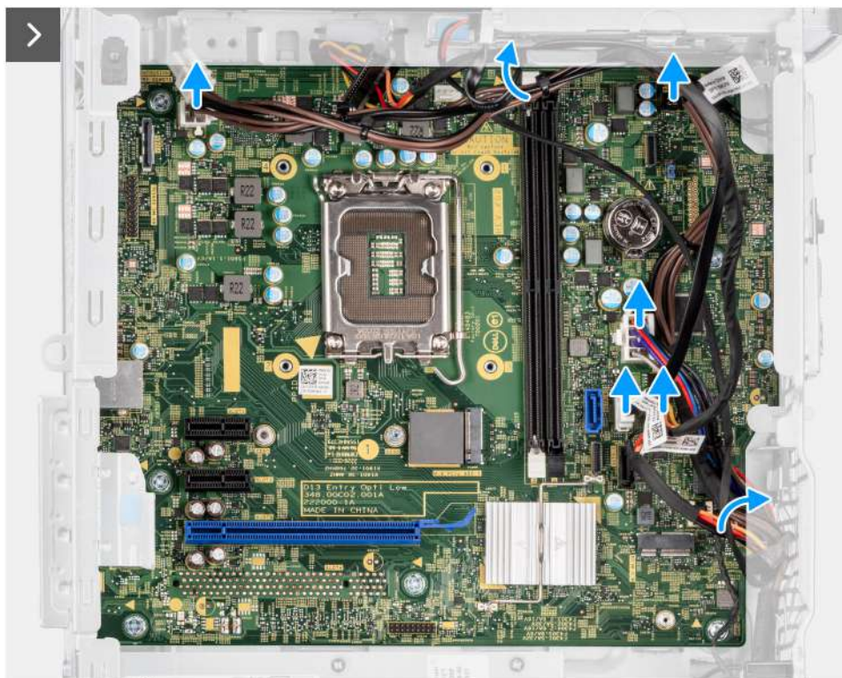
Obrázek 84. Demontáž základní desky
