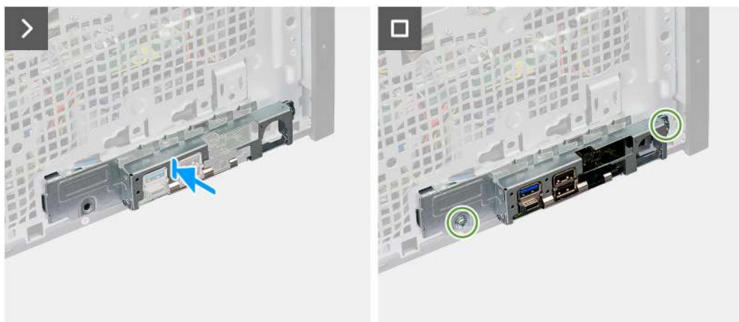
Obrázek 91. Montáž základní desky
