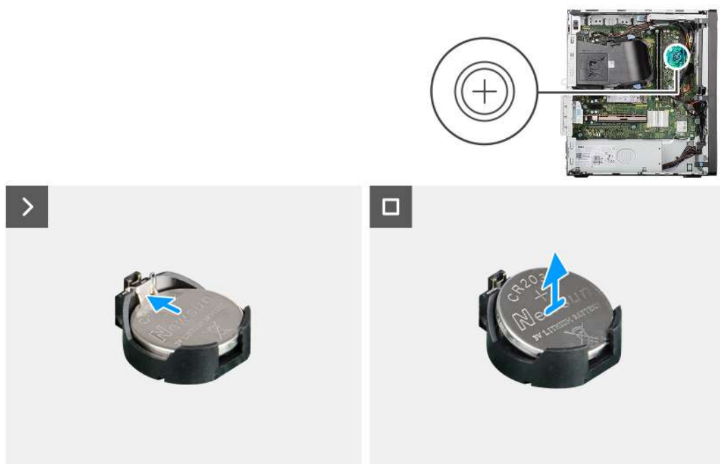
Obrázek 13. Vyjmutí knoflíkové baterie
