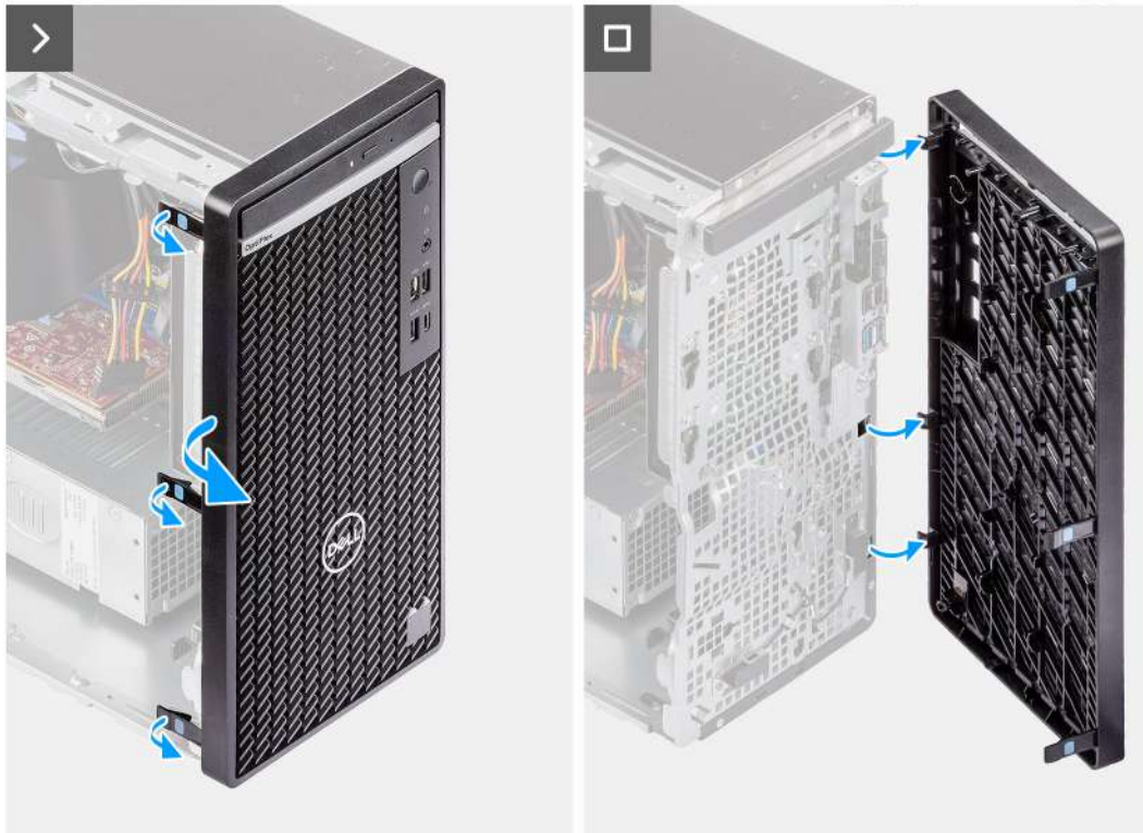
Obrázek 15. Demontáž čelního krytu
