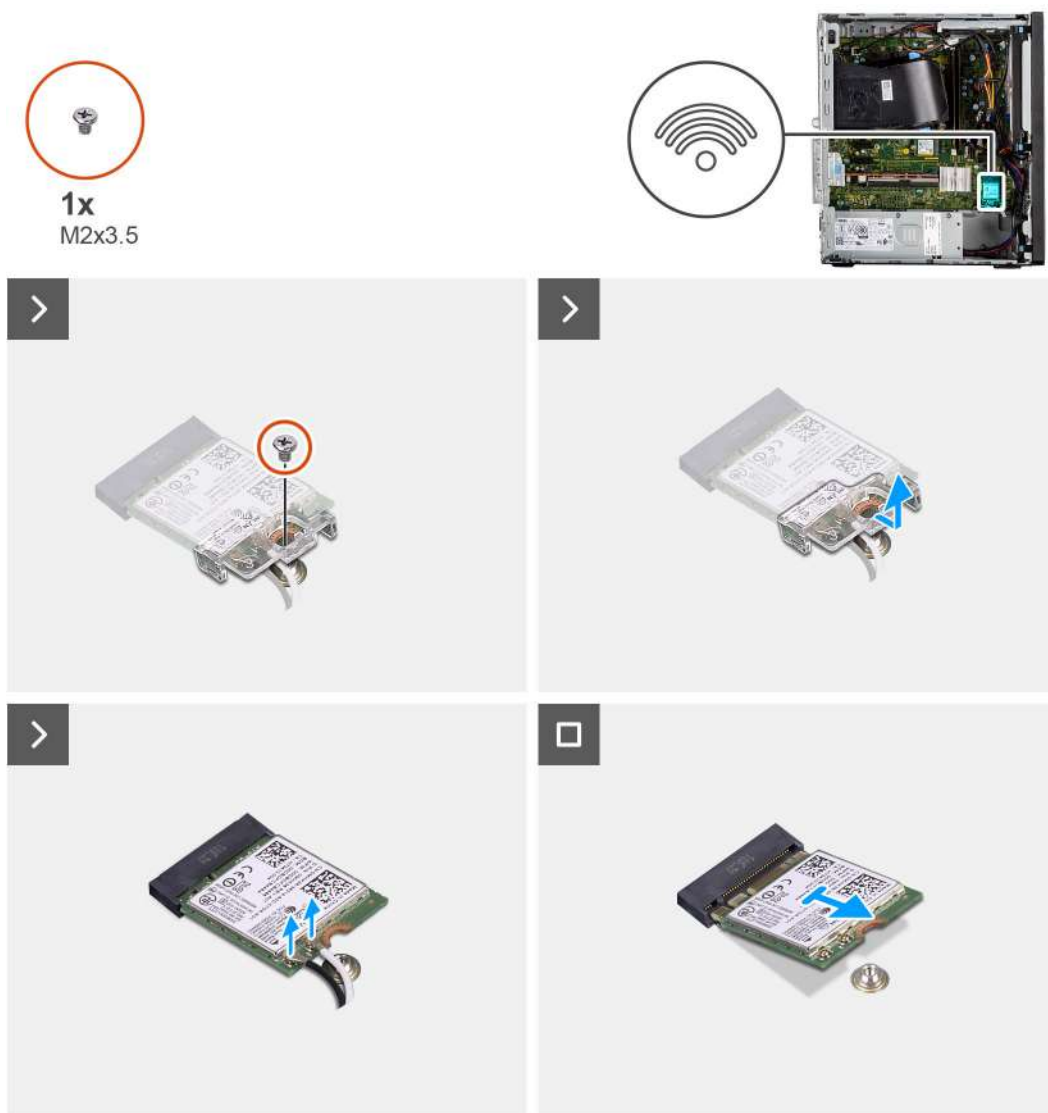
Obrázek 31. Demontáž bezdrátové karty
