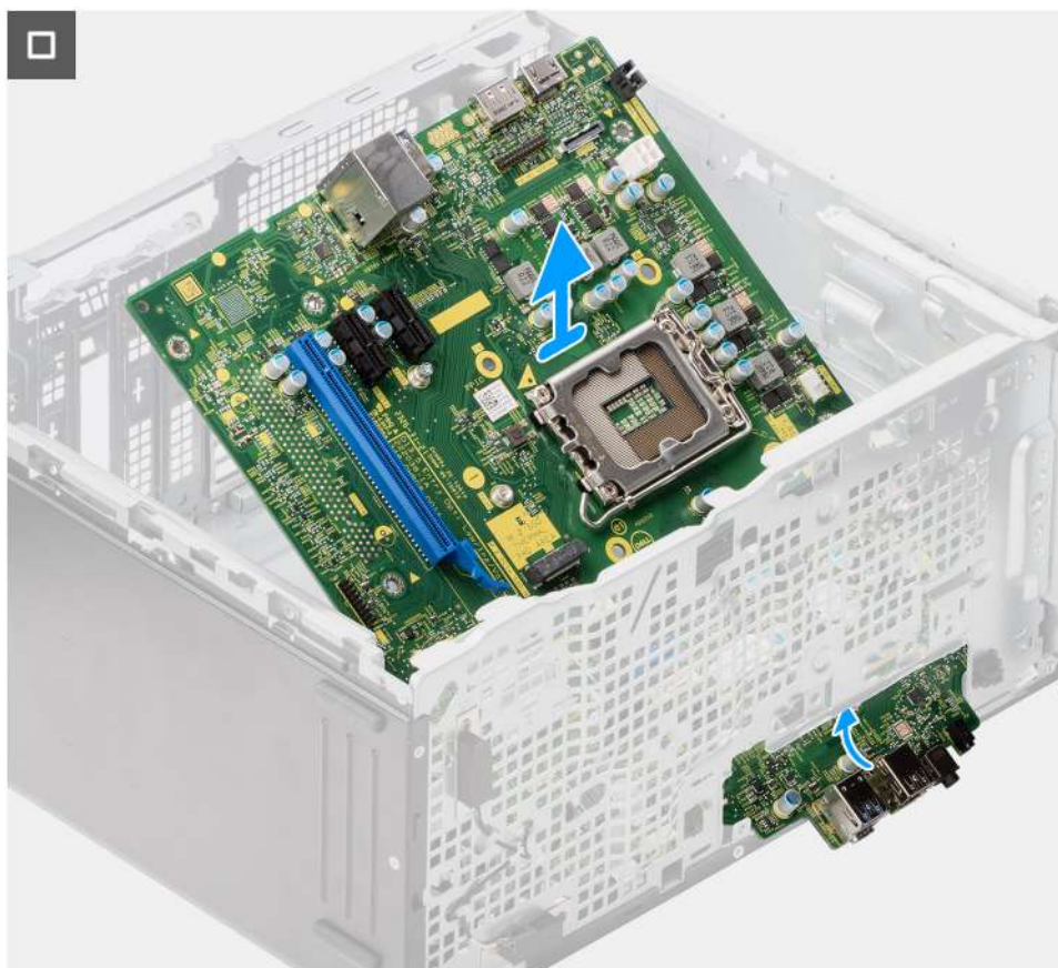
Obrázek 86. Demontáž základní desky
