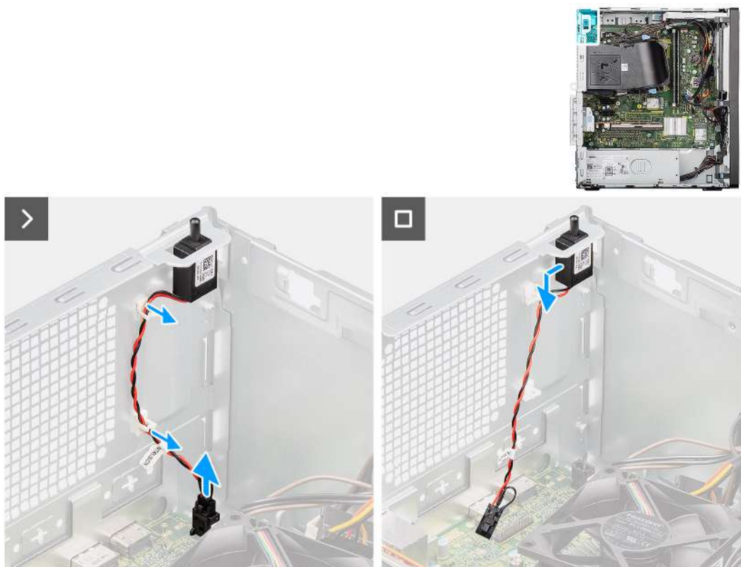
Obrázek 47. Demontáž spínače detekce vniknutí do šasi
