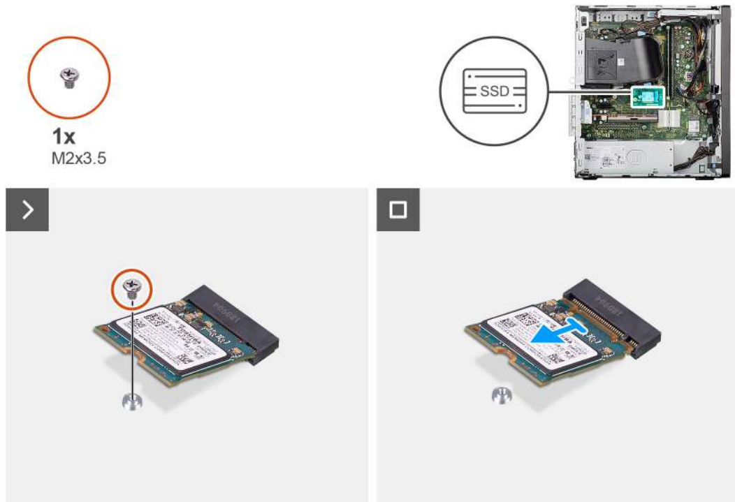
Obrázek 19. Demontáž disku SSD M.2 2230
