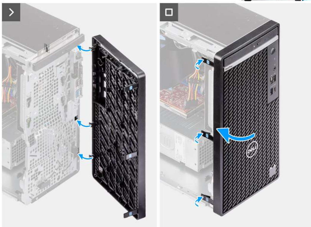
Obrázek 16. Montáž čelního krytu
