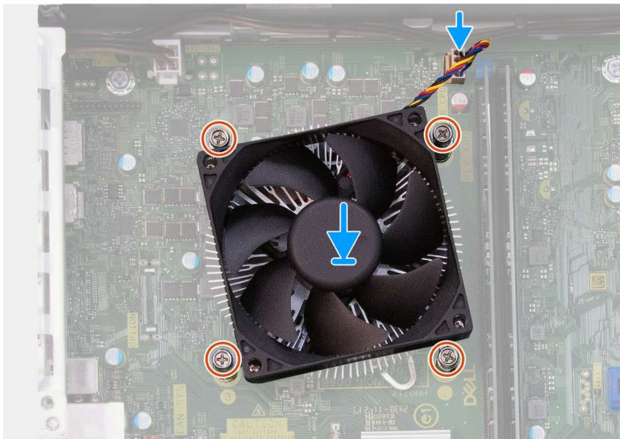
Obrázek 39. Montáž sestavy ventilátoru a chladiče procesoru
