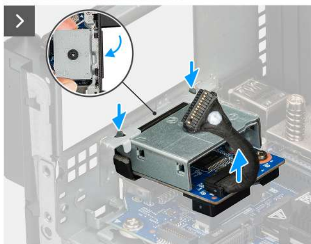
Obrázek 36. Demontáž portu PS2
