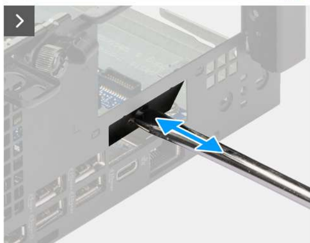
Obrázek 43. Montáž portu HDMI
