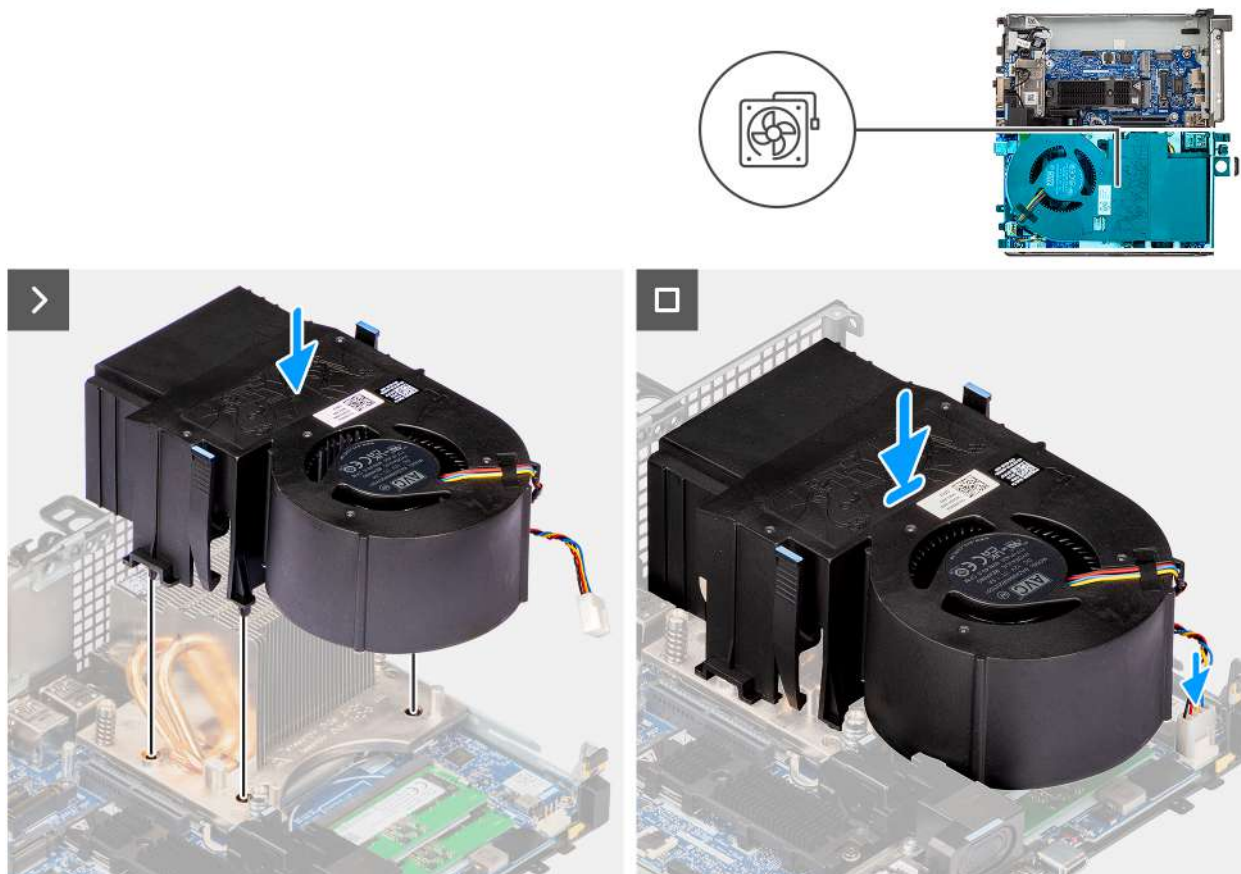
Obrázek 16. Montáž systémového ventilátoru
