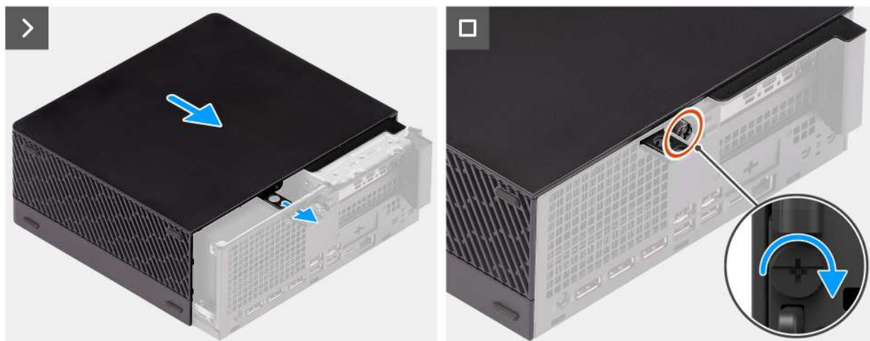
Obrázek 6. Montáž bočního krytu
