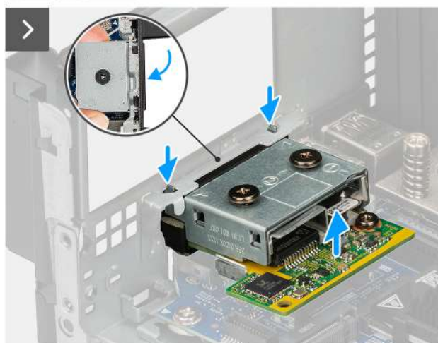
Obrázek 33. Demontáž portu optického kabelu 5G
