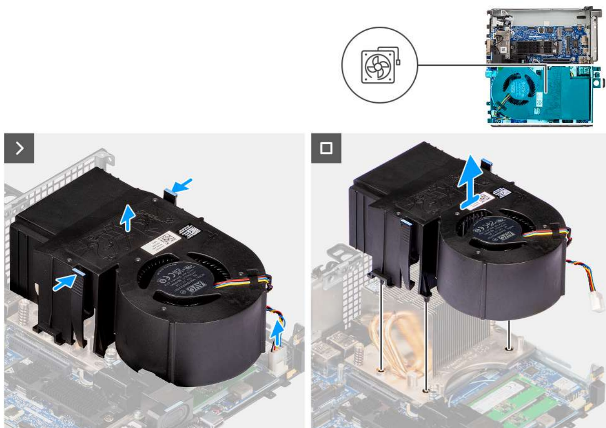
Obrázek 15. Demontáž systémového ventilátoru
