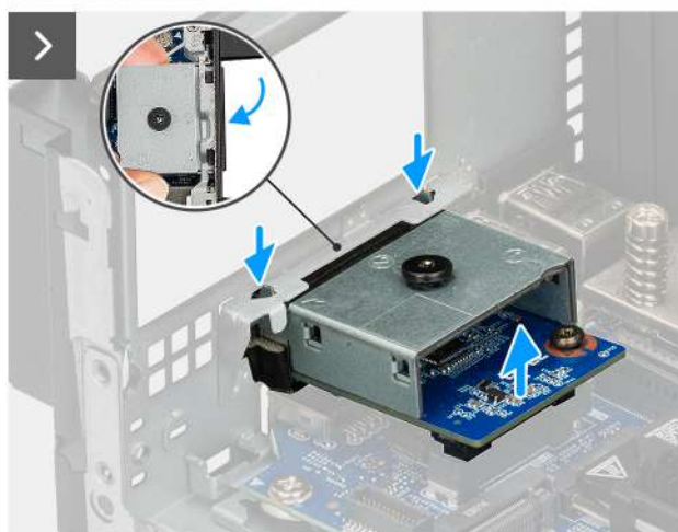
Obrázek 45. Demontáž portu HDMI
