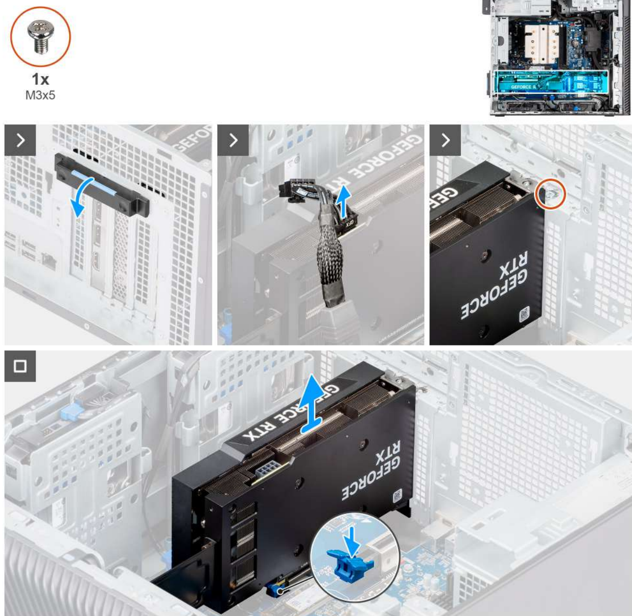
Obrázek 39. Demontáž napájené grafické karty
