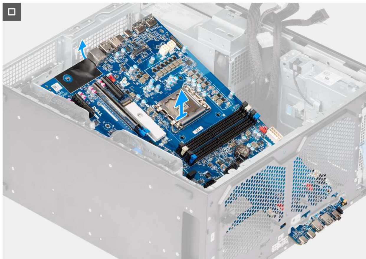
Obrázek 92. Demontáž základní desky
