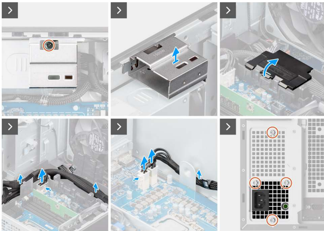
Obrázek 53. Demontáž jednotky 1500 W napájecího zdroje
