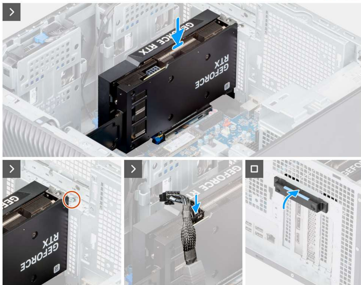
Obrázek 40. Montáž napájené grafické karty
