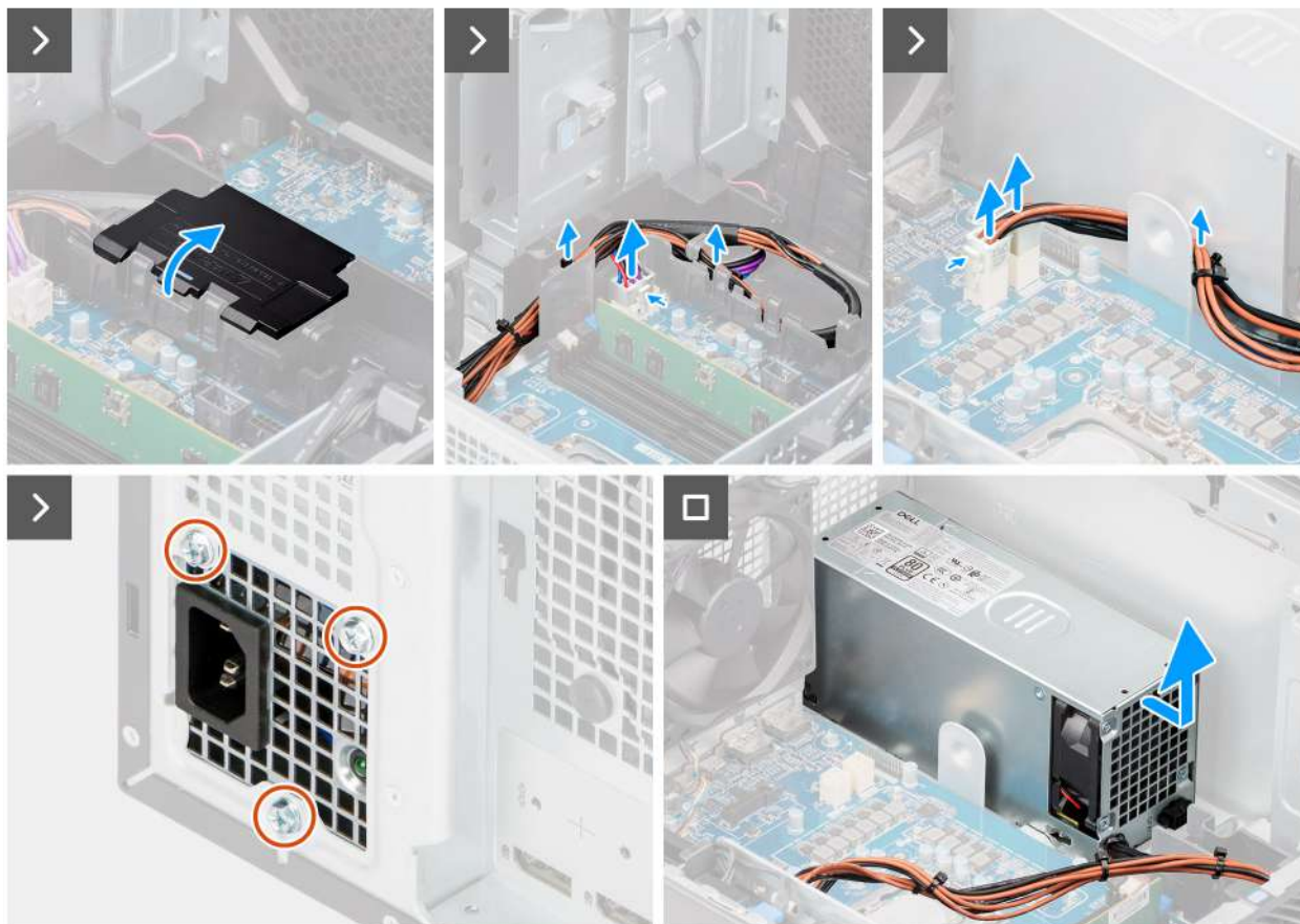
Obrázek 57. Demontáž jednotky 360 W napájecího zdroje
