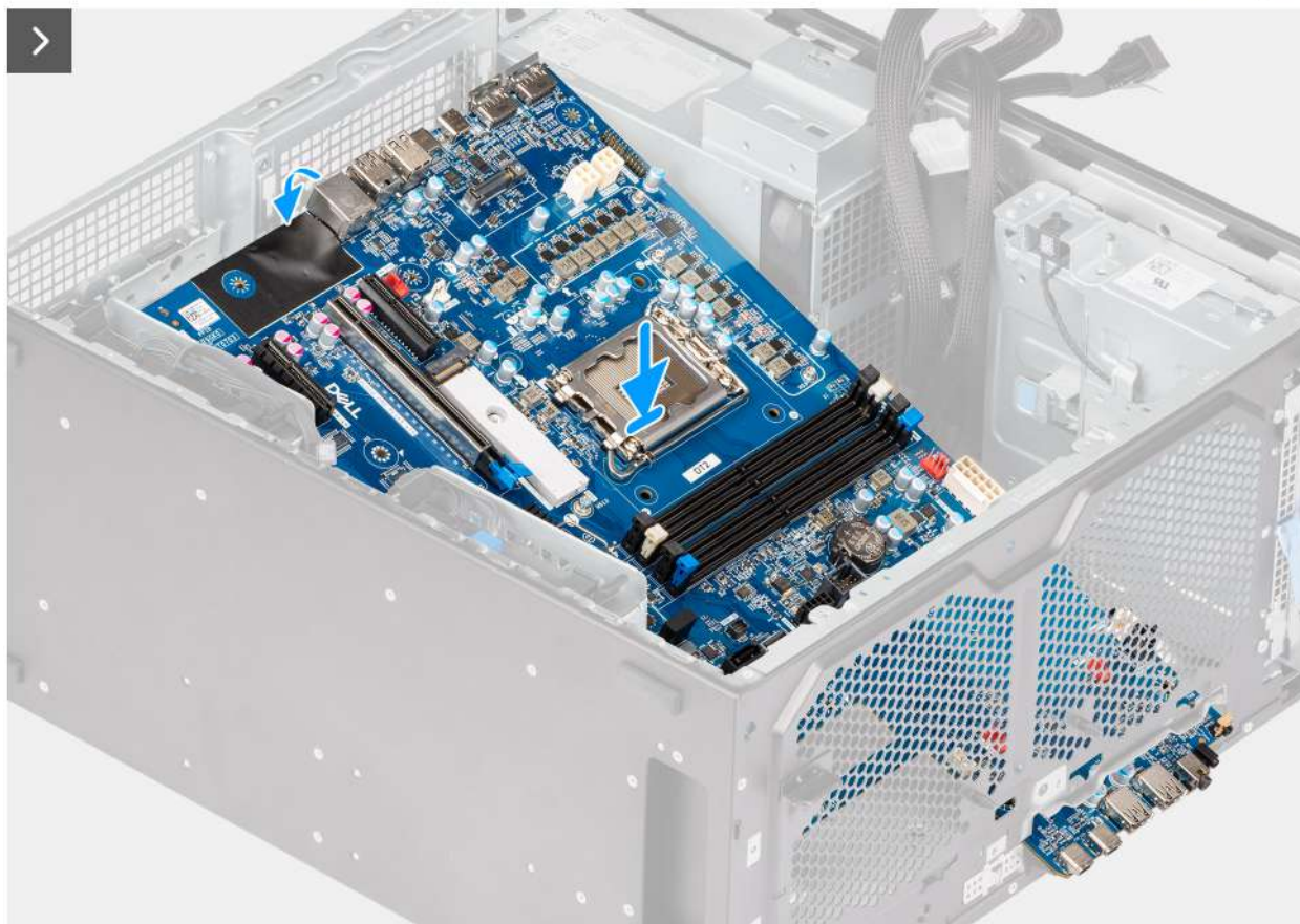
Obrázek 94. Montáž základní desky
