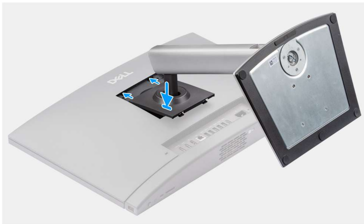
Obrázek 15. Instalace výškově nastavitelného stojanu (HAS)
