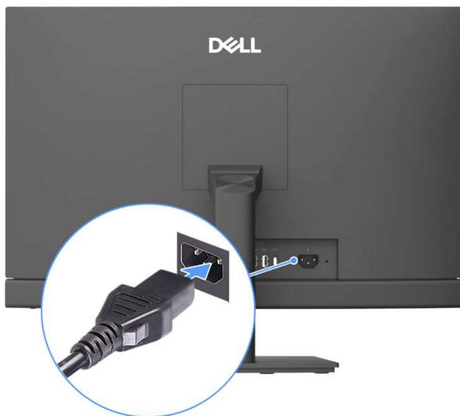
Obrázek 10. Připojení napájecího kabelu
