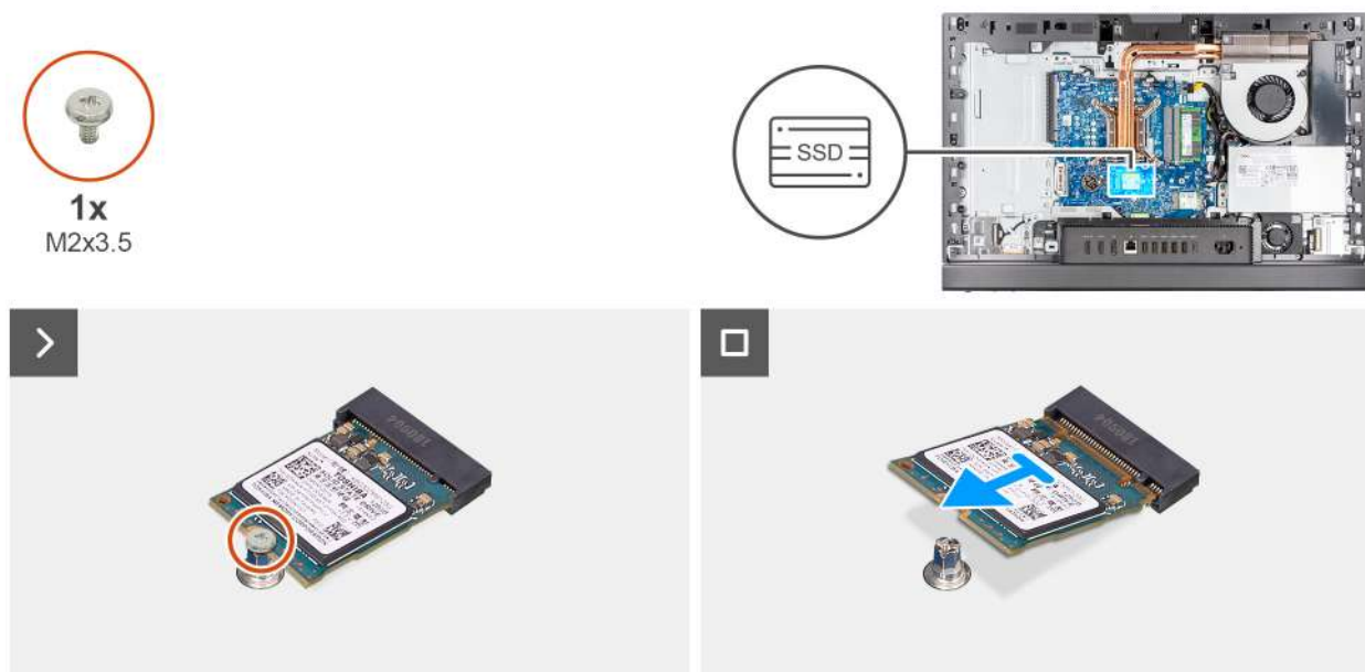
Obrázek 25. Demontáž disku SSD M.2 2230 ze slotu M.2 č. 0
