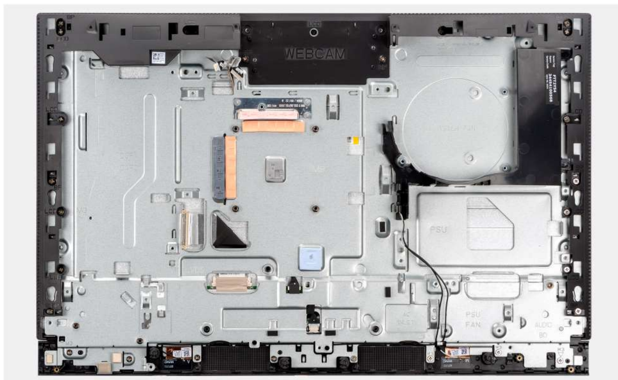
Obrázek 63. Demontáž základny sestavy displeje
