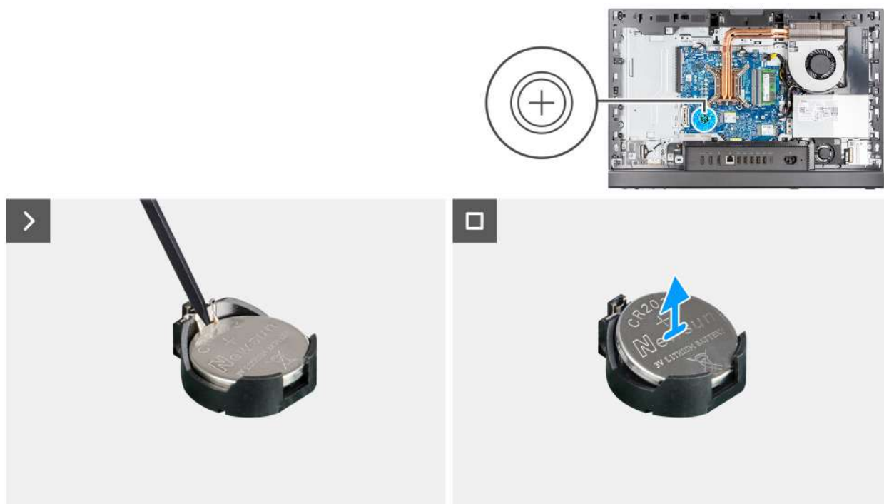
Obrázek 31. Vyjmutí knoflíkové baterie
