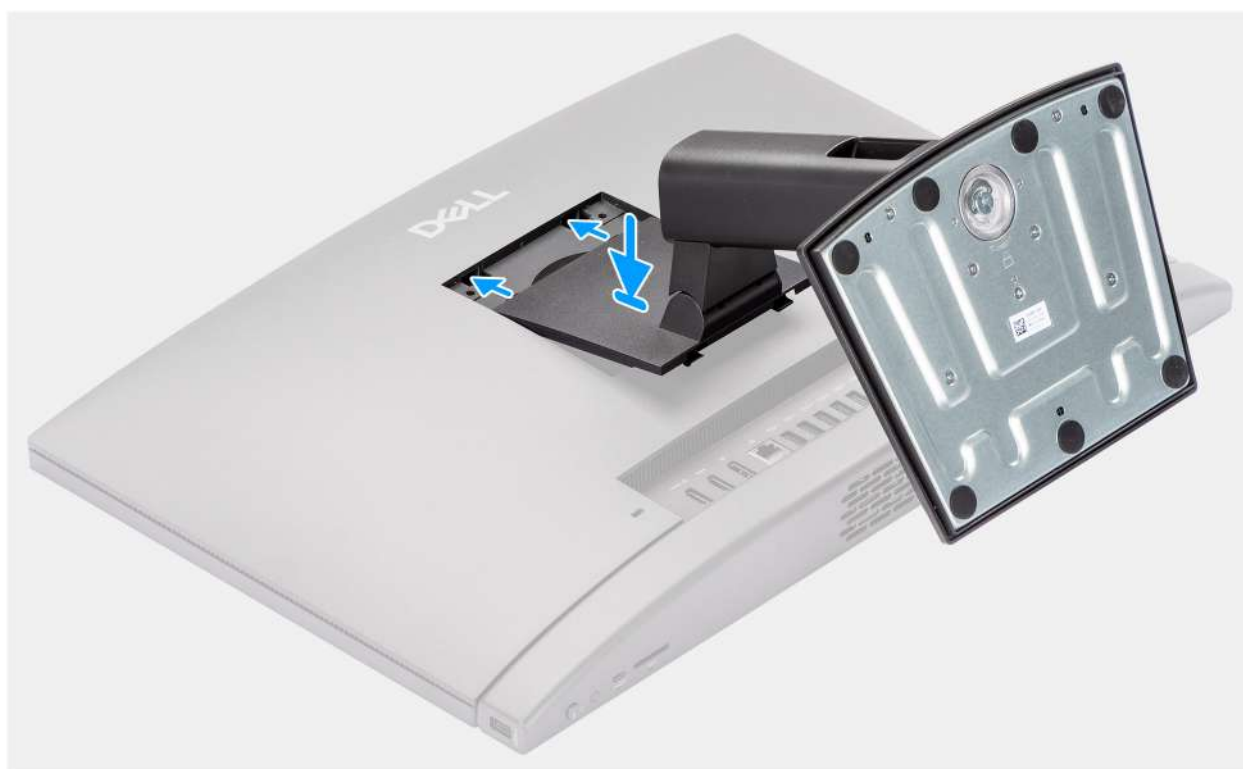
Obrázek 16. Montáž pevného stojanu
