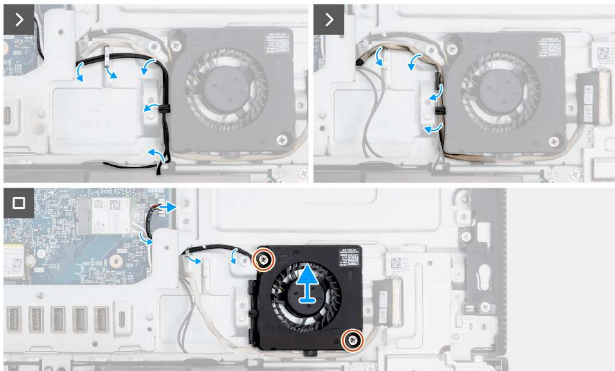
Obrázek 43. Demontáž jednotky ventilátoru napájecího zdroje
