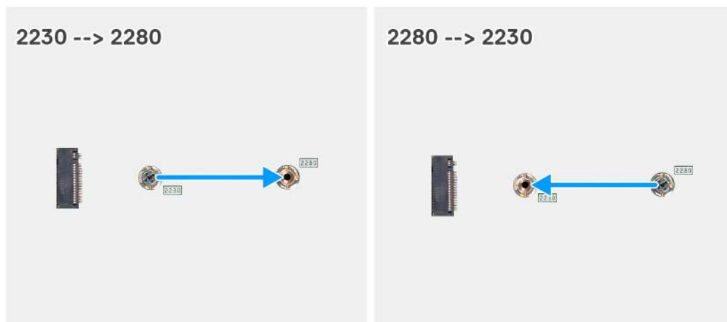
Obrázek 30. Posun šroubového držáku disku SSD do slotu M.2 č. 1
