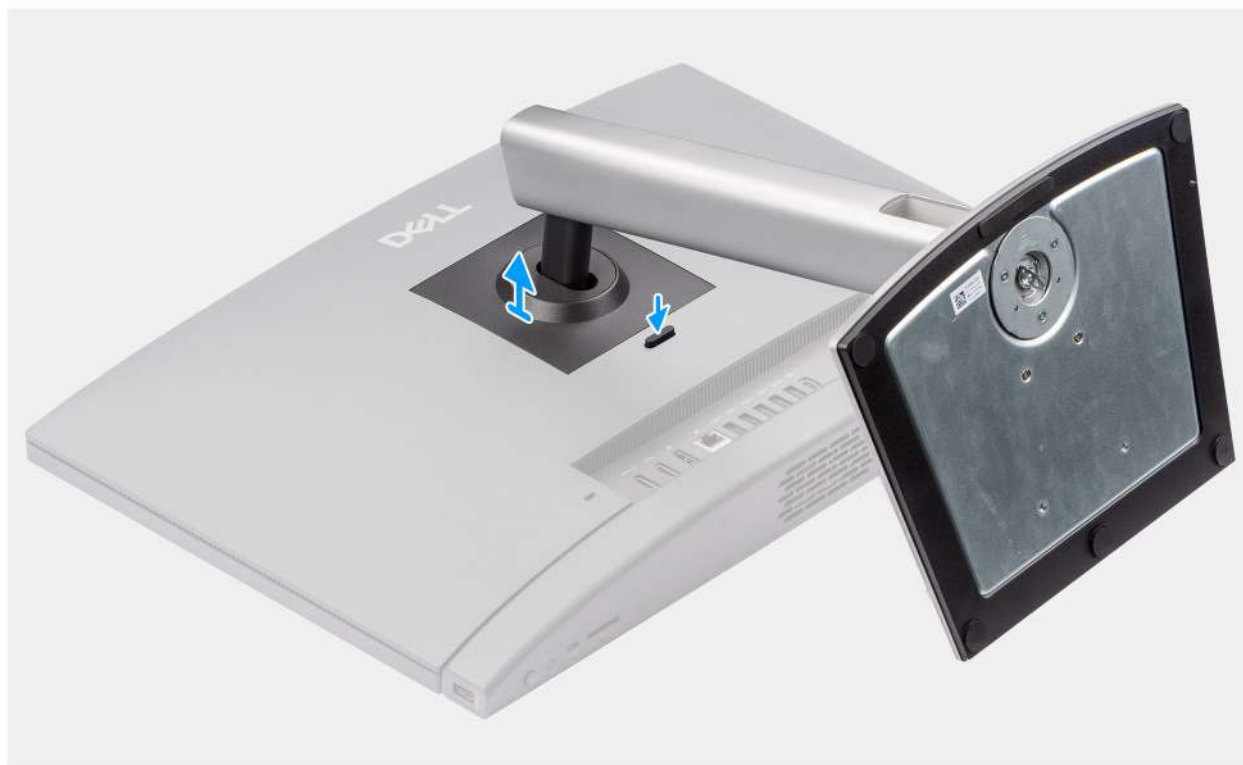
Obrázek 13. Demontáž výškově nastavitelného stojanu (HAS)
