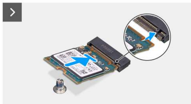
Obrázek 29. Montáž disku SSD M.2 2230 do slotu M.2 č. 1
