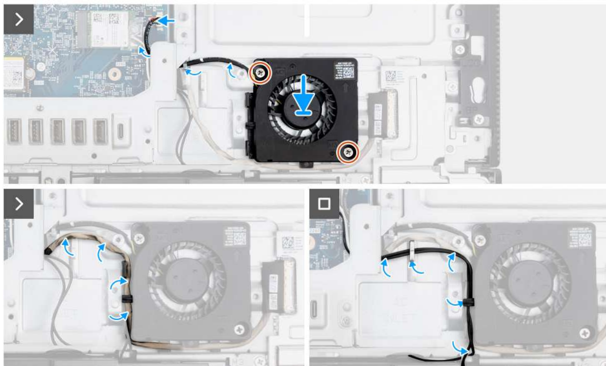
Obrázek 44. Montáž ventilátoru napájecího zdroje
