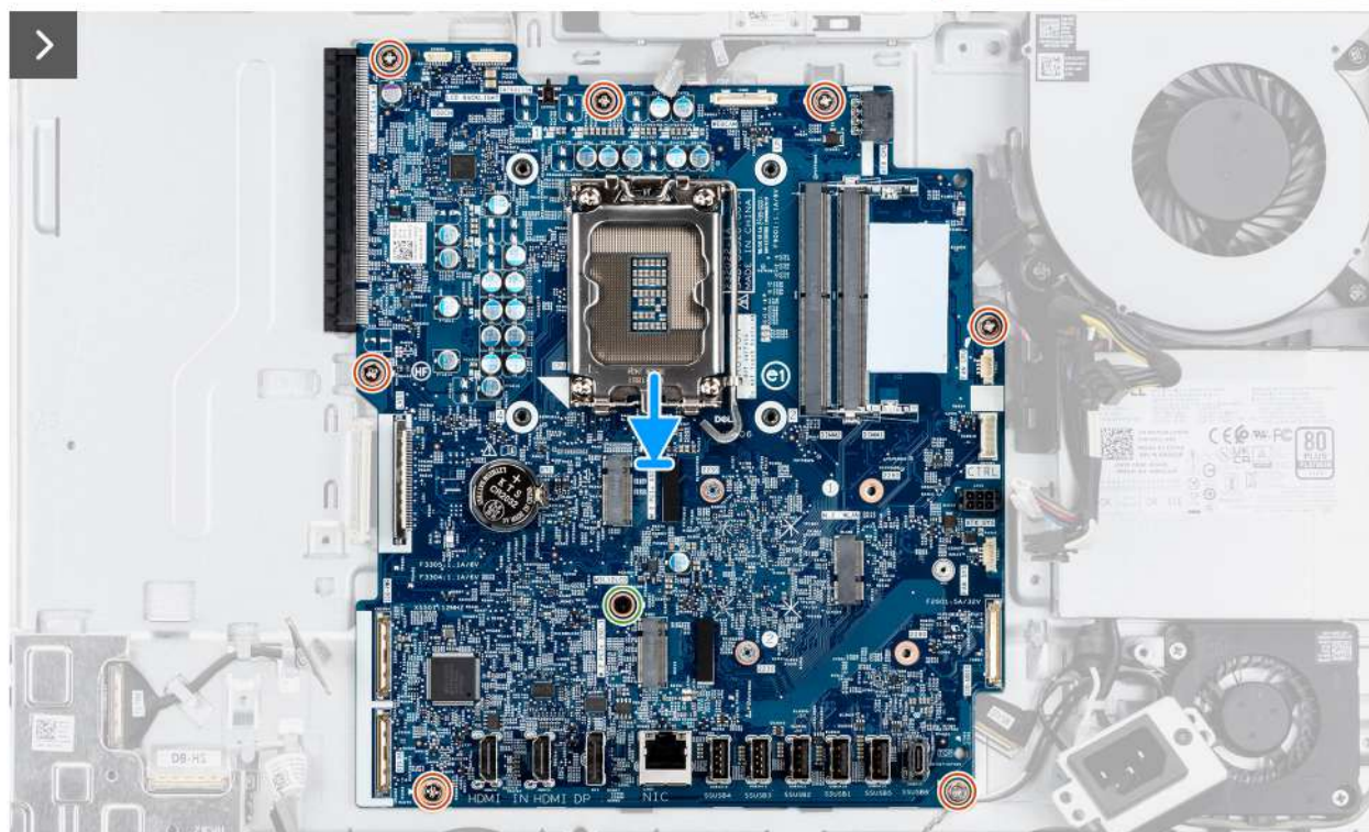
Obrázek 57. Montáž základní desky
