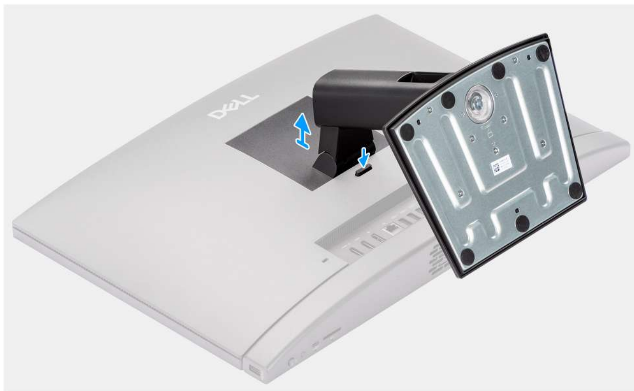
Obrázek 14. Demontáž pevného stojanu
