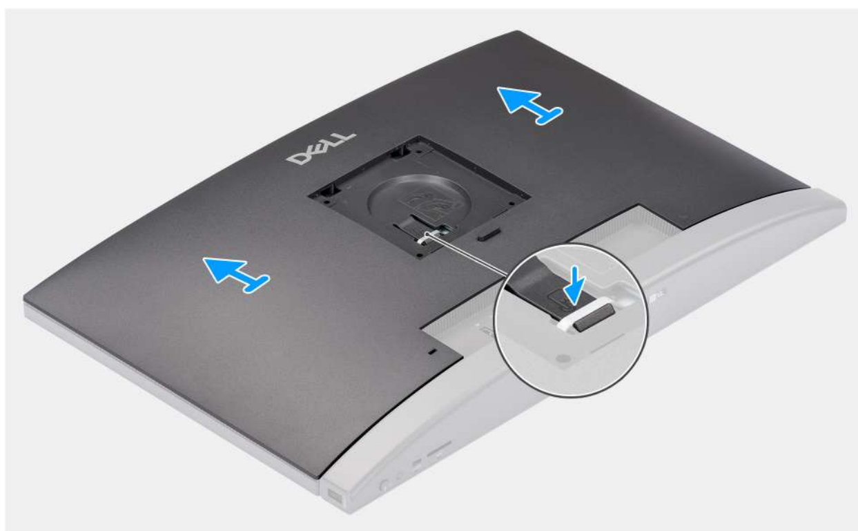
Obrázek 17. Demontáž zadního krytu
