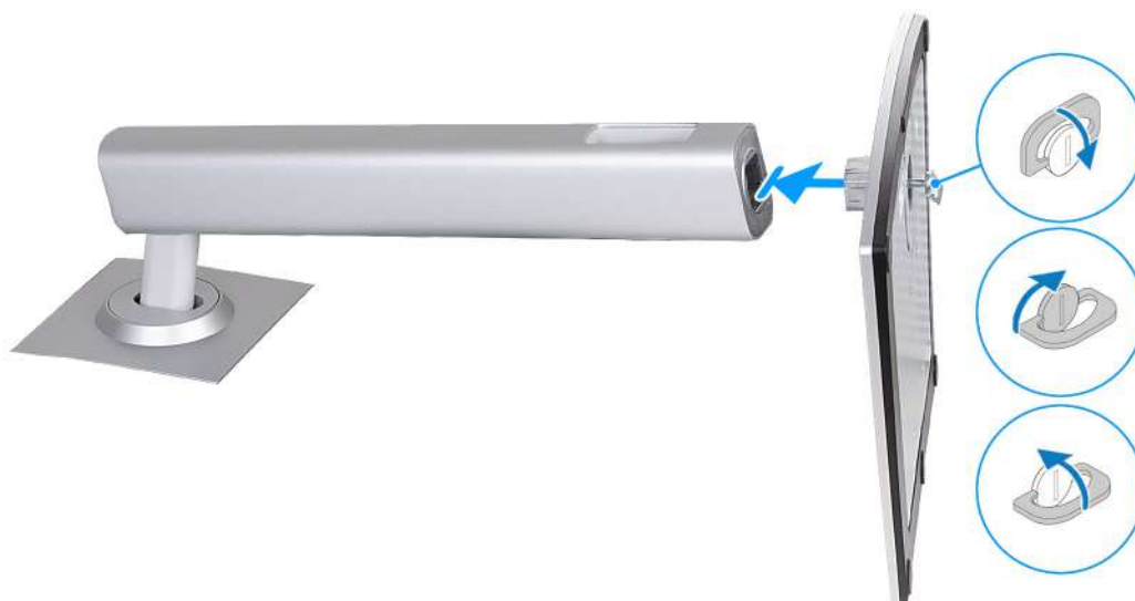
Obrázek 8. Montáž podstavce stojanu
