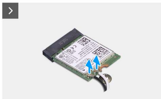
Obrázek 23. Demontáž bezdrátové karty
