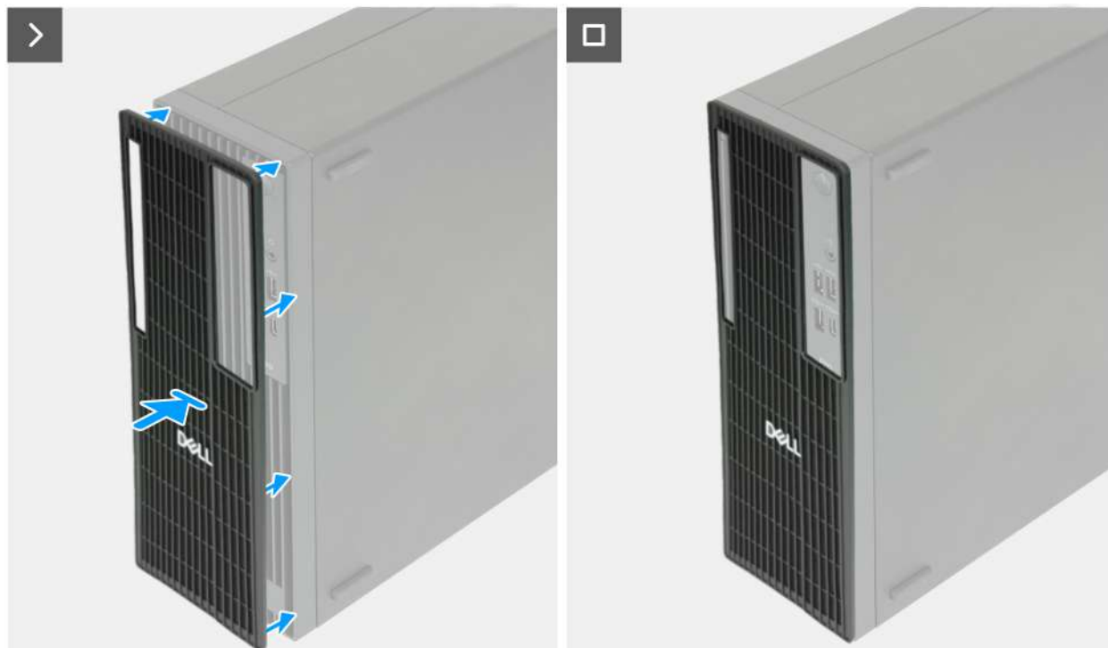
Obrázek 15. Montáž prachového filtru
