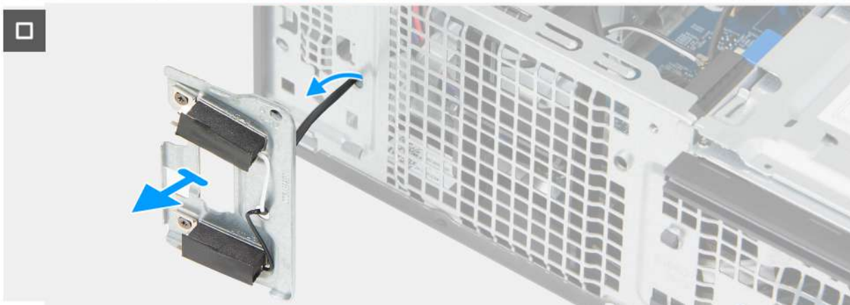
Obrázek 45. Demontáž anténních modulů
