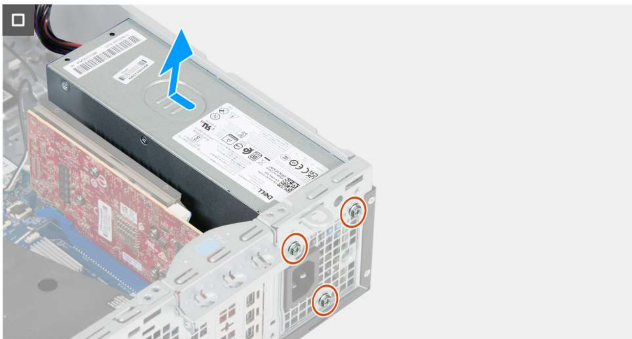
Obrázek 48. Demontáž napájecího zdroje
