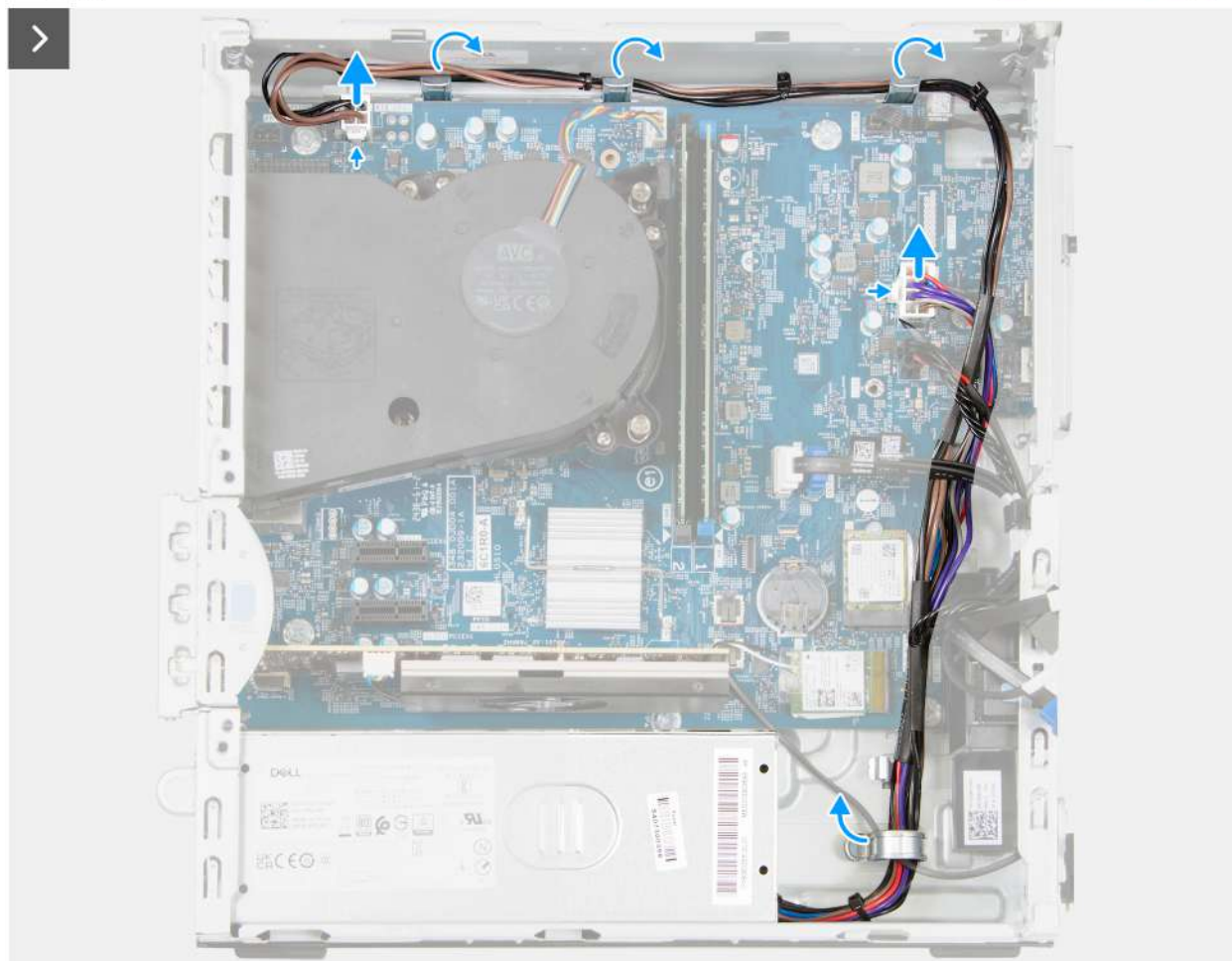
Obrázek 47. Demontáž napájecího zdroje
