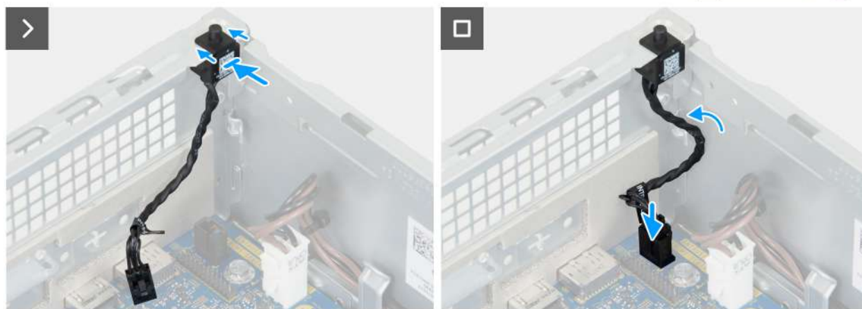
Obrázek 42. Montáž spínače proti neoprávněnému vniknutí do šasi
