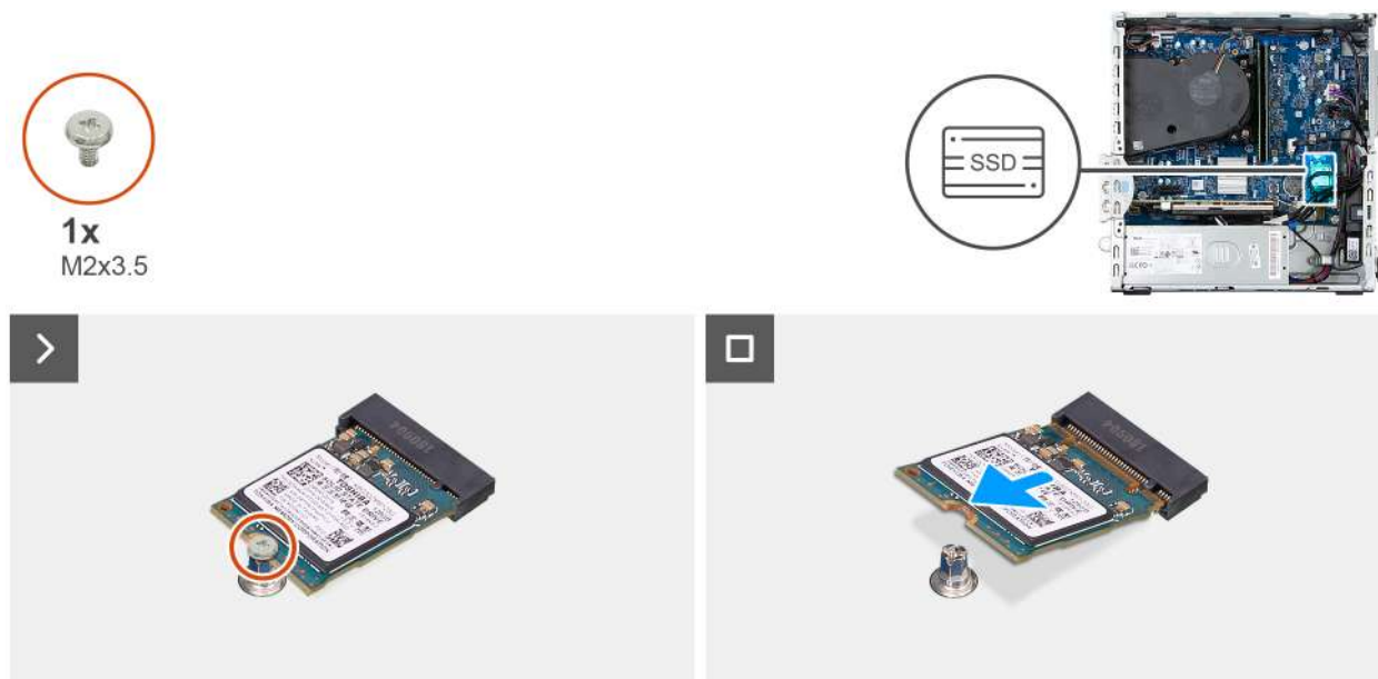
Obrázek 22. Demontáž disku SSD M.2 2230
