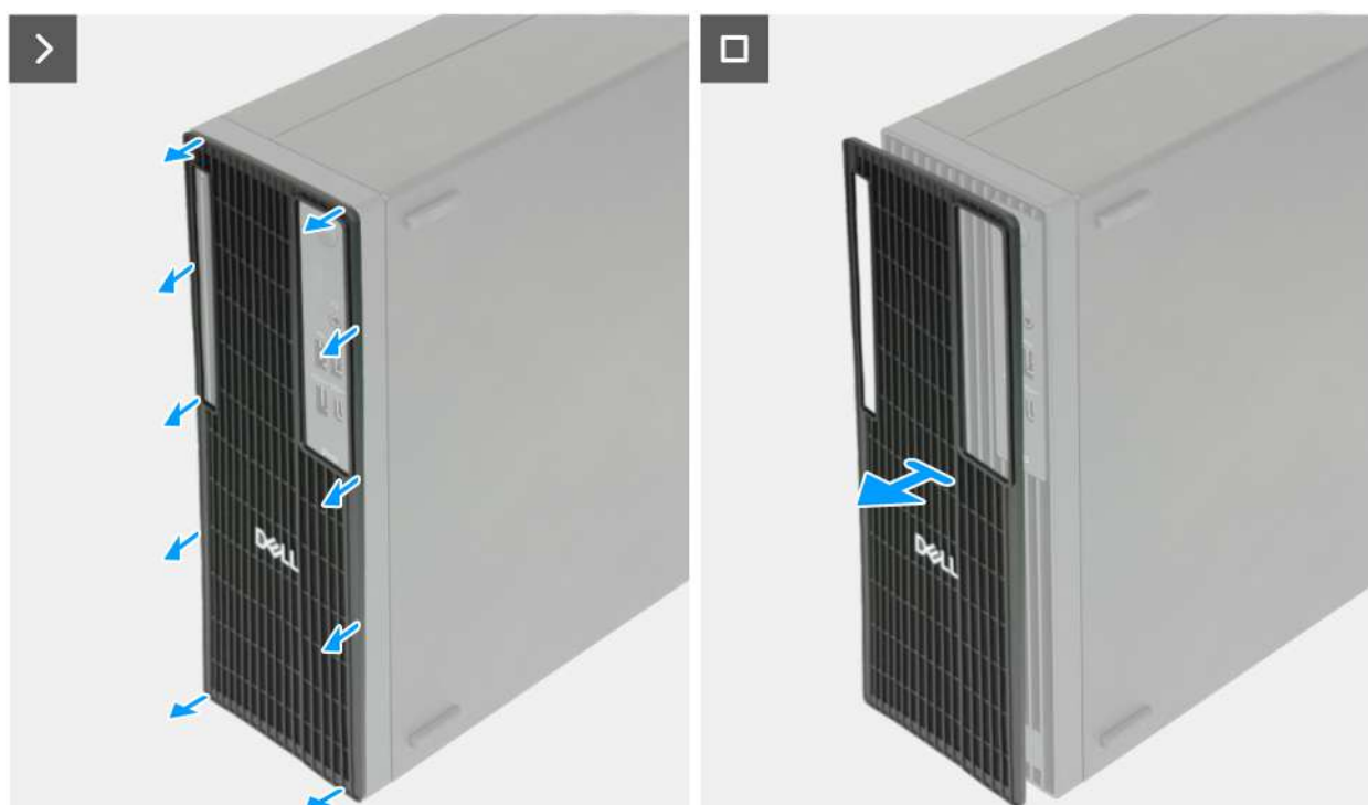
Obrázek 14. Demontáž prachového filtru
