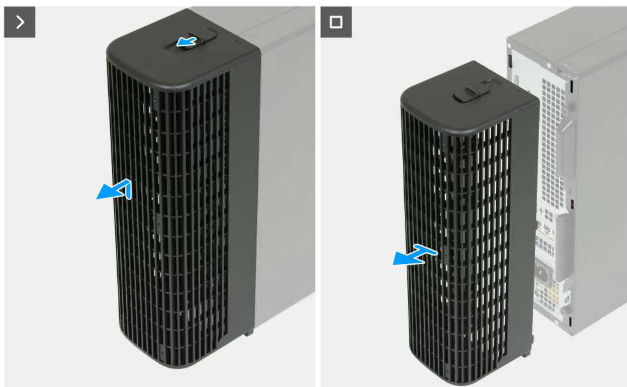
Obrázek 4. Demontáž krytu kabeláže
