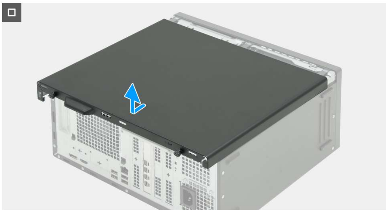
Obrázek 13. Demontáž levého bočního krytu
