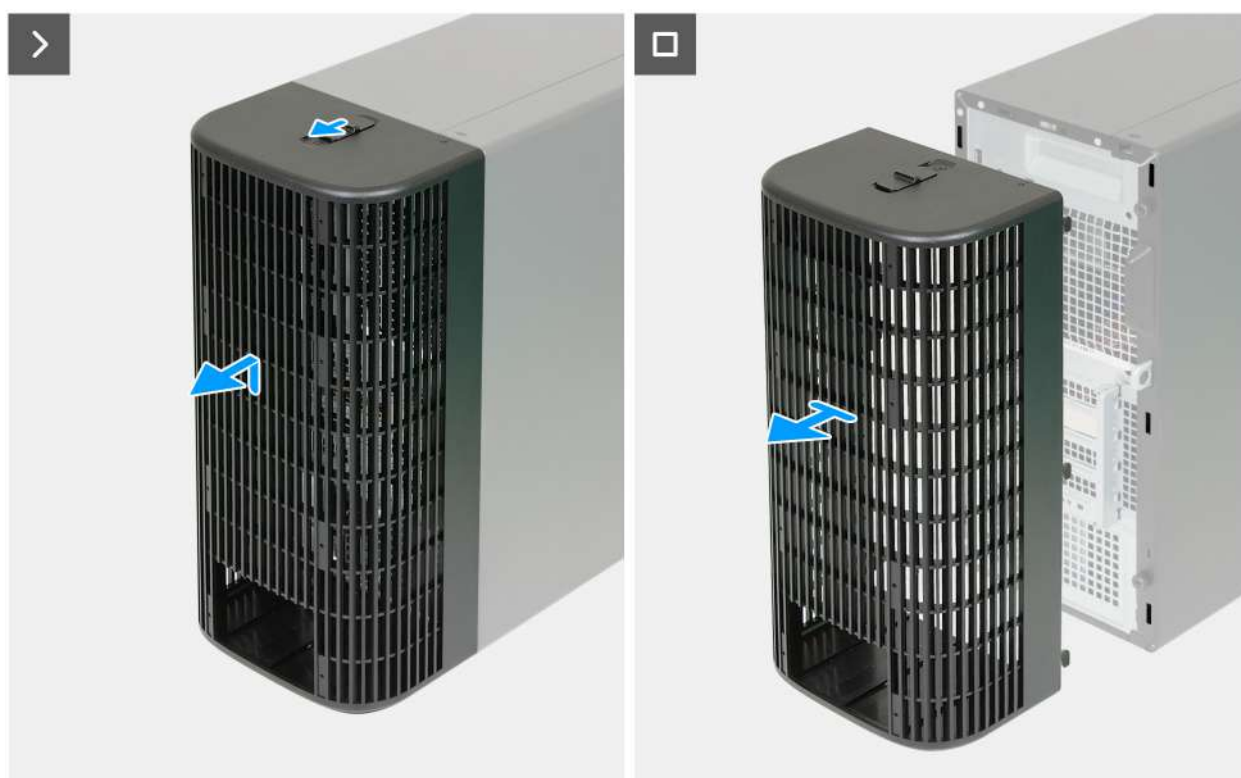
Obrázek 10. Demontáž krytu kabeláže
