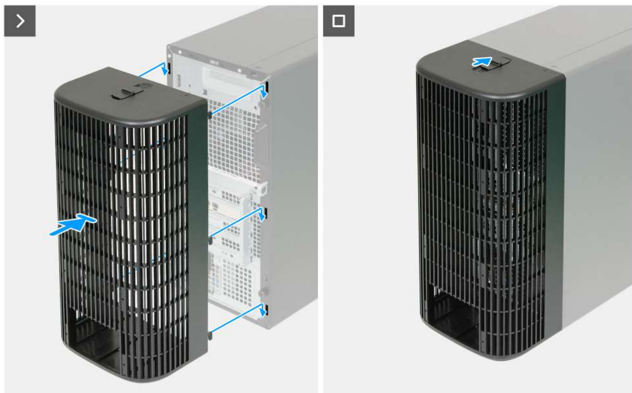
Obrázek 11. Montáž krytu kabeláže
