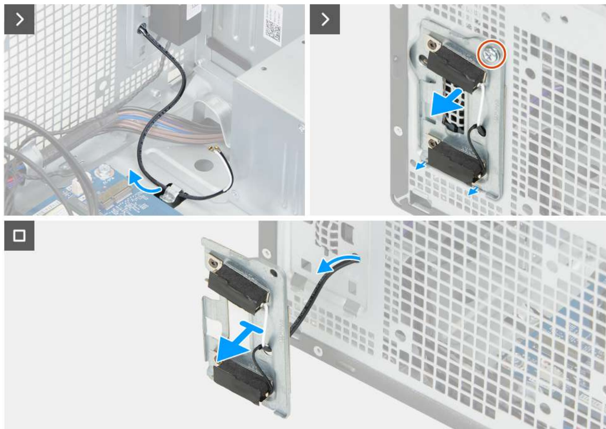
Obrázek 59. Demontáž anténních modulů
