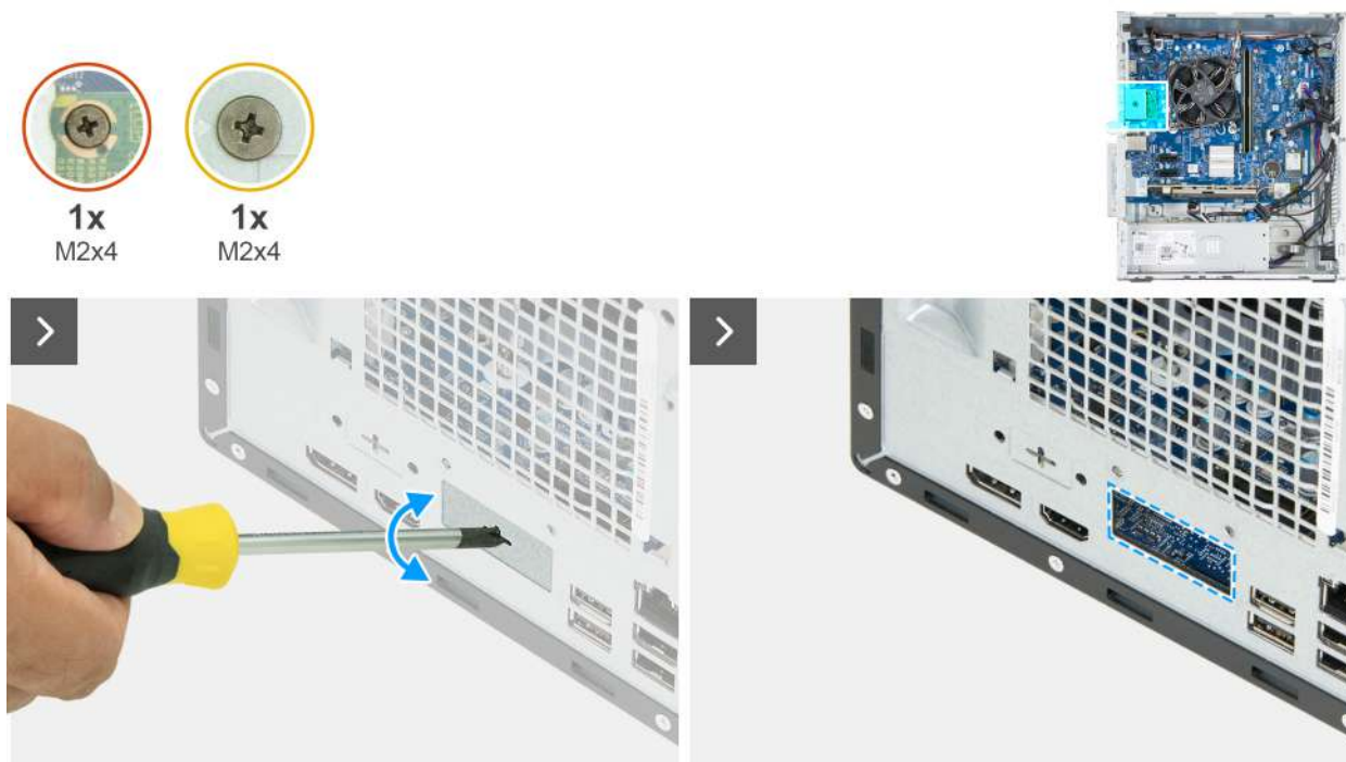
Obrázek 54. Montáž modulu volitelného portu
