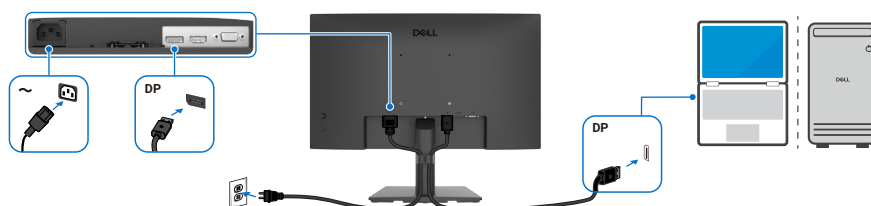
Obrázek 16. Připojení kabelu DP
