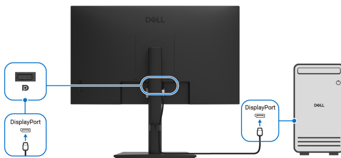
Obrázek 15. Připojení kabelu DP
