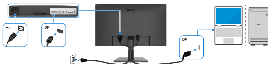
Obrázek 16. Připojení kabelu DP
