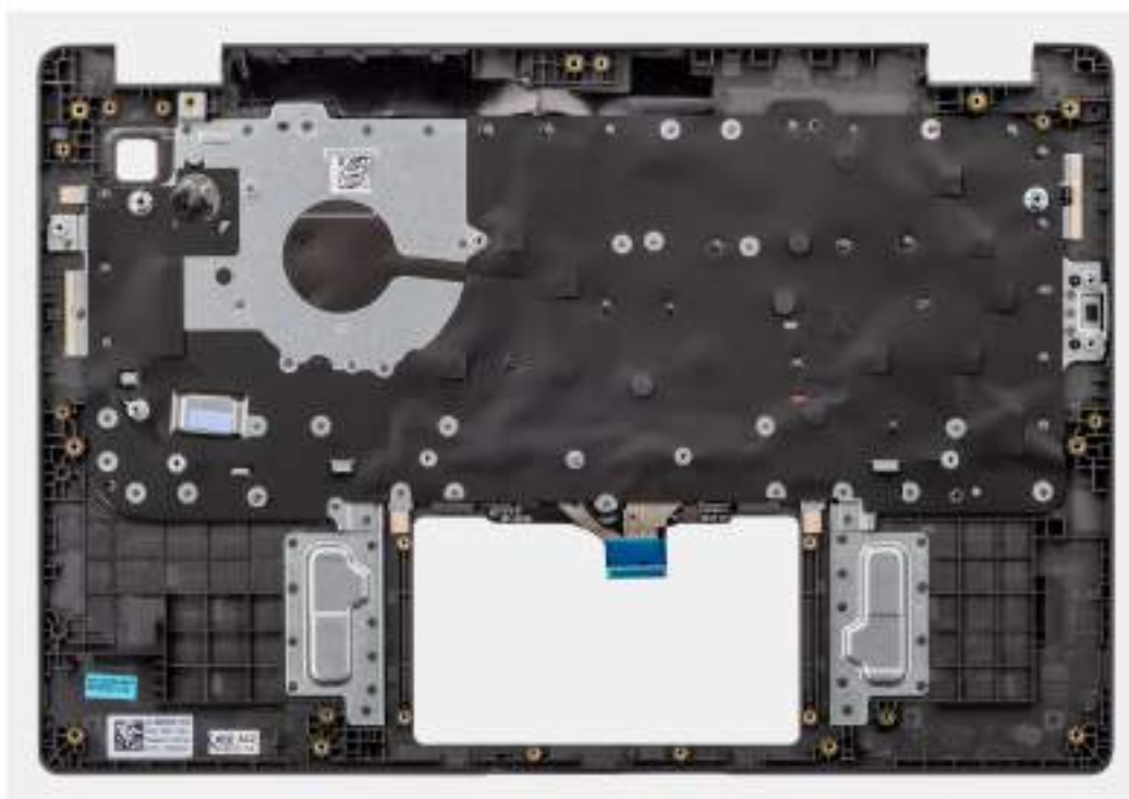
Obrázek 46. Montáž sestavy opěrky pro dlaň a klávesnice
