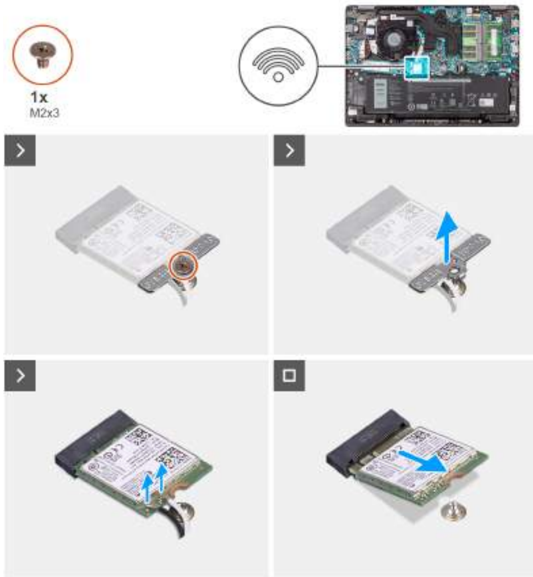
Obrázek 15. Demontáž bezdrátové karty
