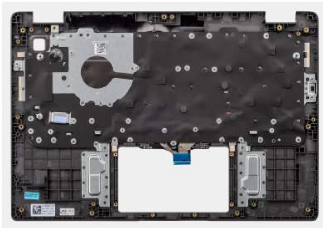
Obrázek 45. Demontáž sestavy opěrky pro dlaň a klávesnice
