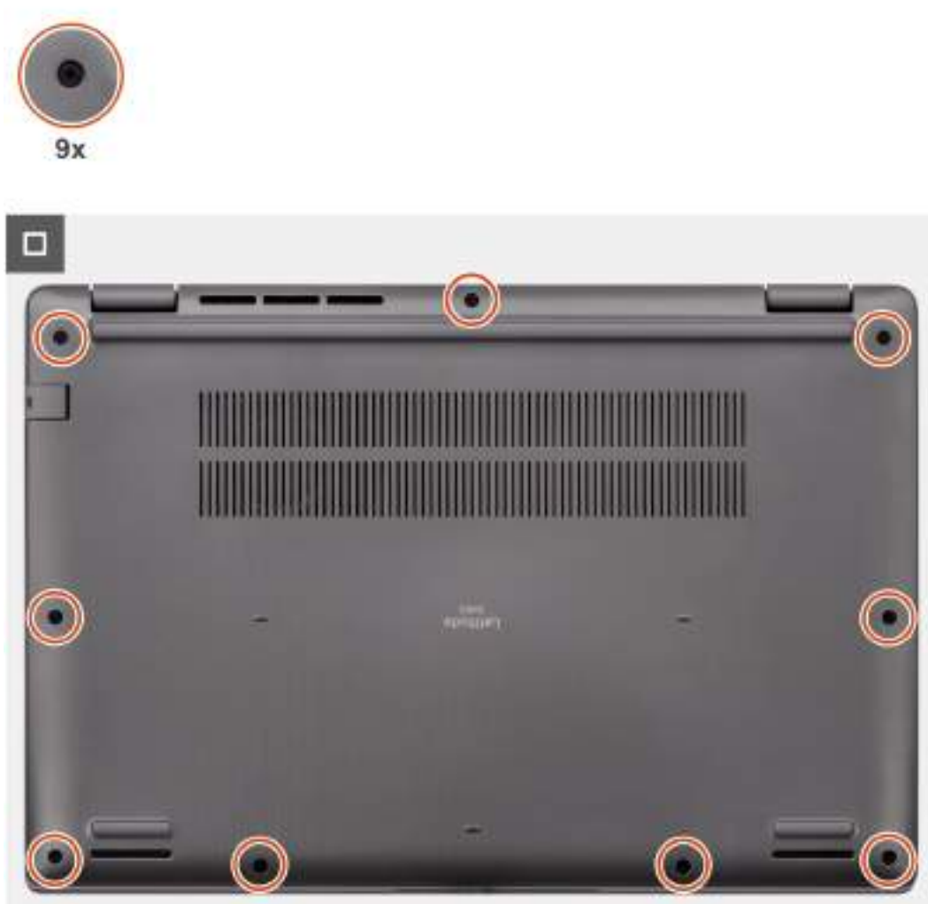
Obrázek 12. Nasazení spodního krytu
