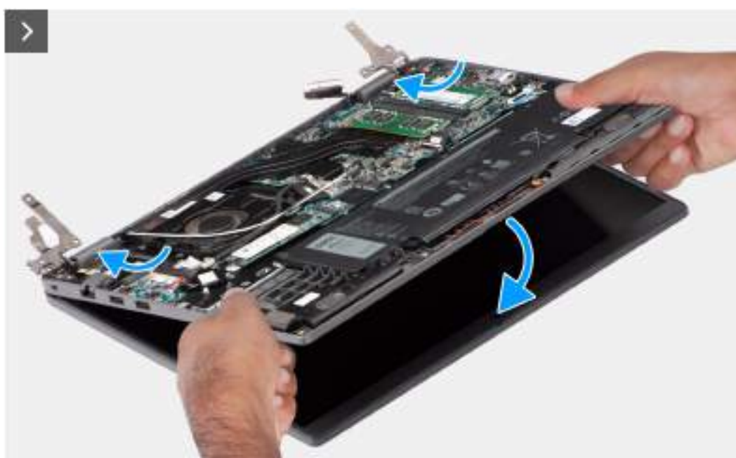
Obrázek 49. Demontáž sestavy displeje
