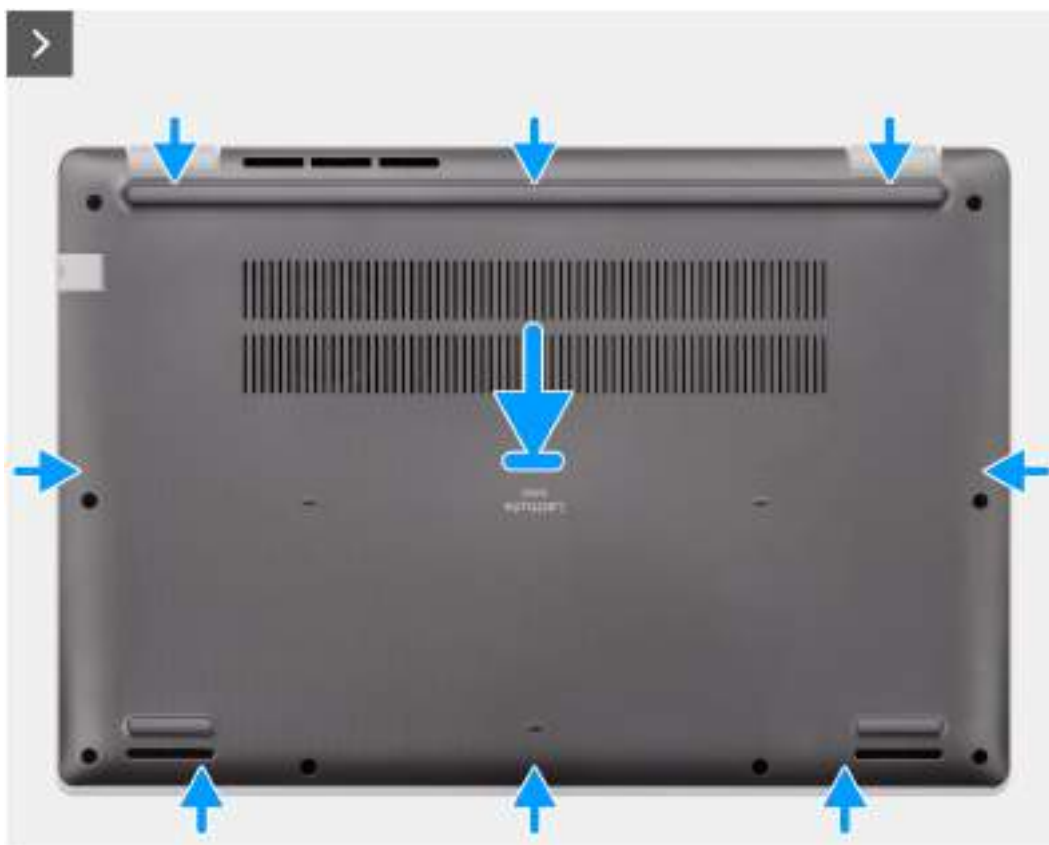
Obrázek 11. Nasazení spodního krytu
