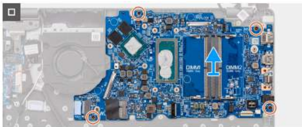
Obrázek 42. Demontáž základní desky
