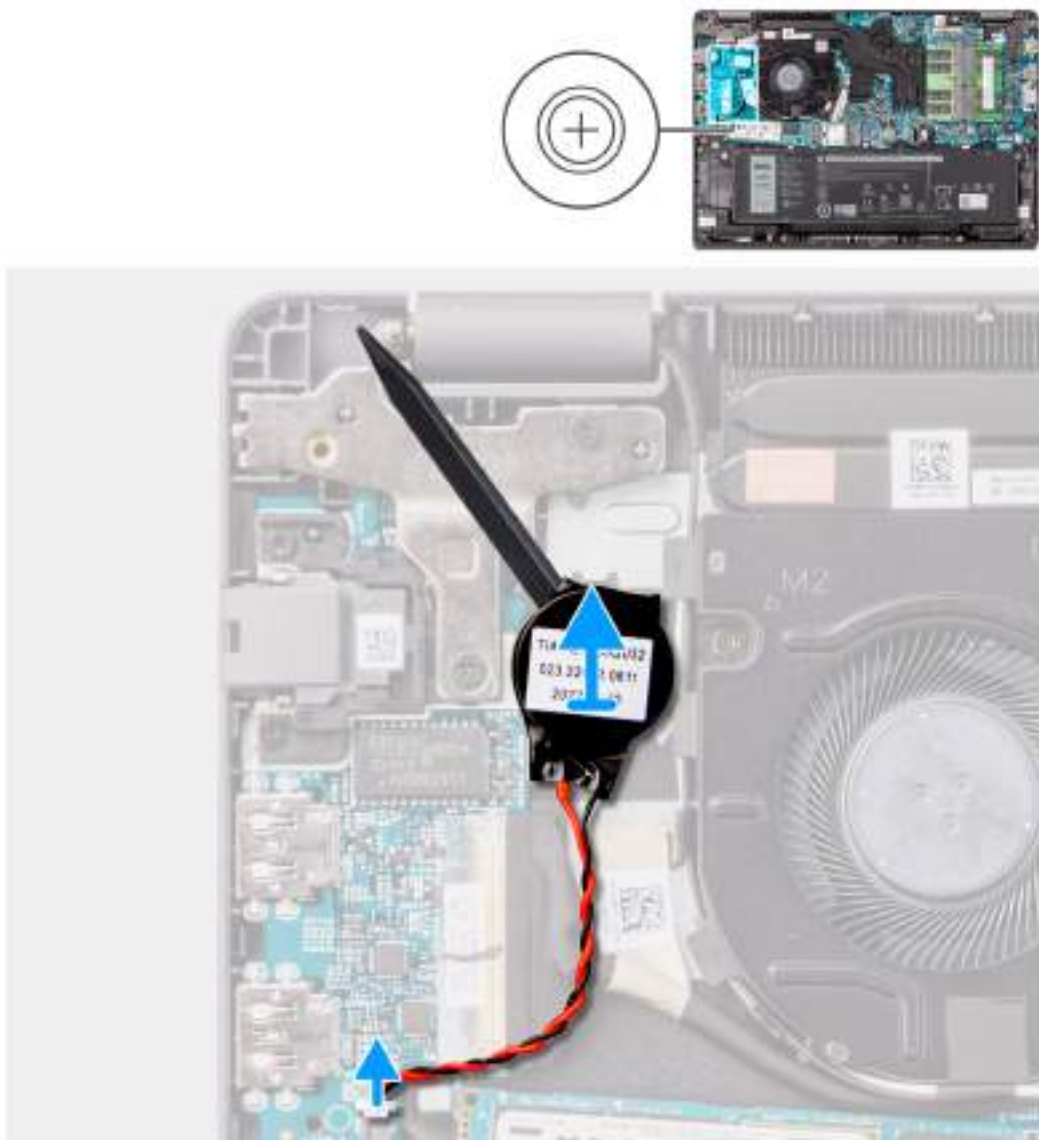
Obrázek 17. Vyjmutí knoflíkové baterie
