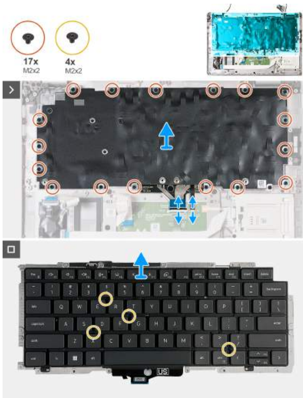
Obrázek 79. Demontáž klávesnice
