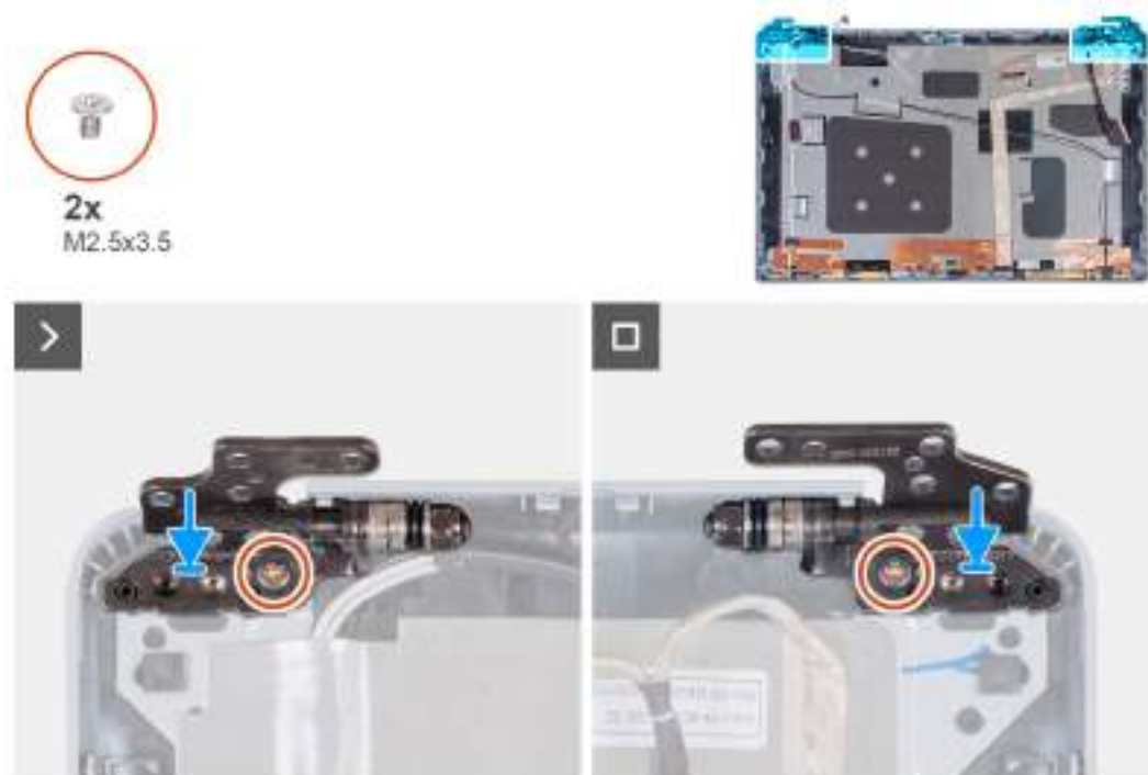
Obrázek 87. Montáž pantů displeje
