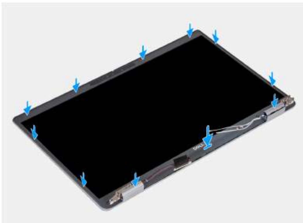
Obrázek 75. Montáž čelního krytu displeje
