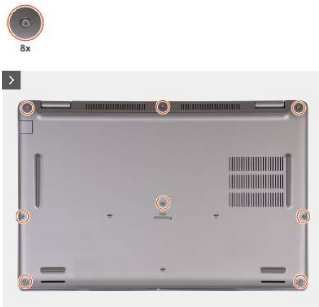
Obrázek 13. Povolení jisticích šroubků
