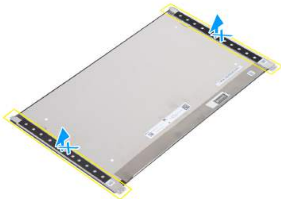
Obrázek 79. Nestahujte a neuvolňujte pružné pásky (SR).
