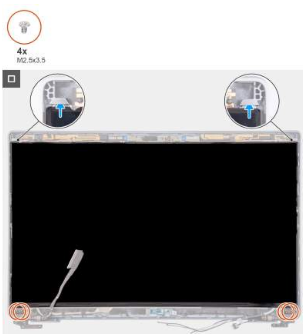
Obrázek 87. Montáž obrazovky displeje
