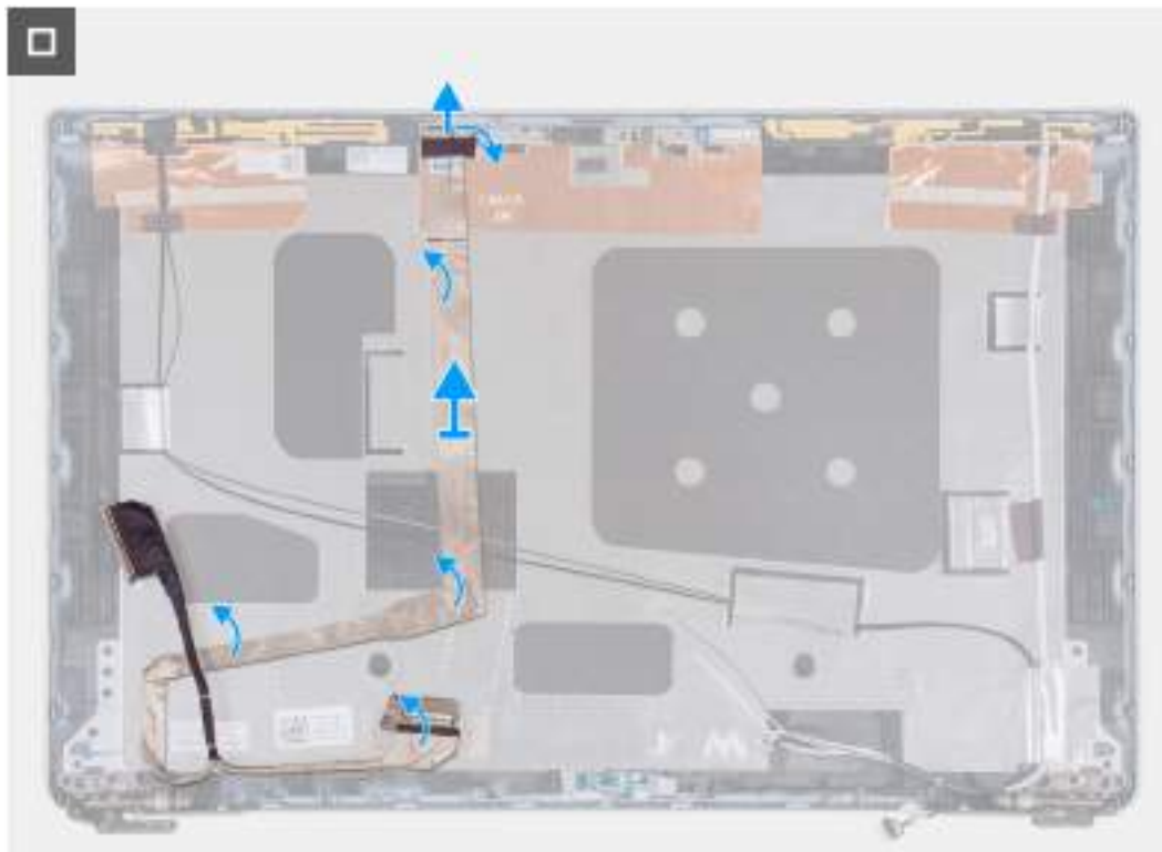
Obrázek 94. Vyjmutí kabelu displeje
