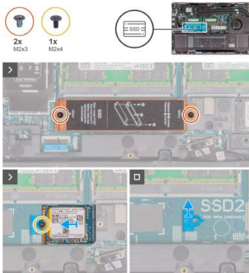
Obrázek 31. Demontáž disku SSD M.2 2230 ze slotu 2
