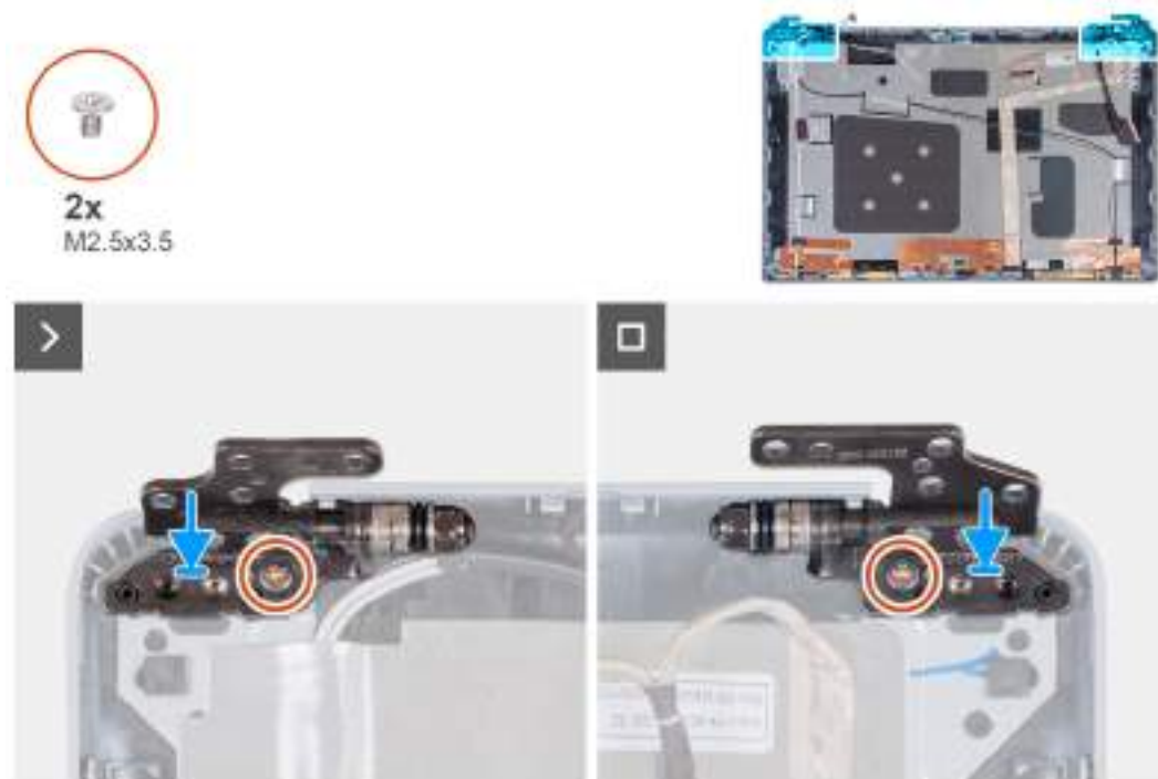
Obrázek 91. Montáž pantů displeje
