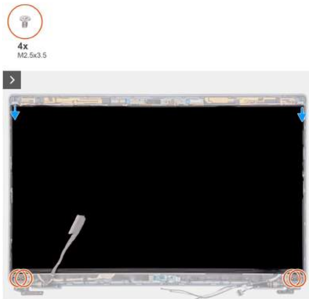
Obrázek 80. Demontáž obrazovky displeje
