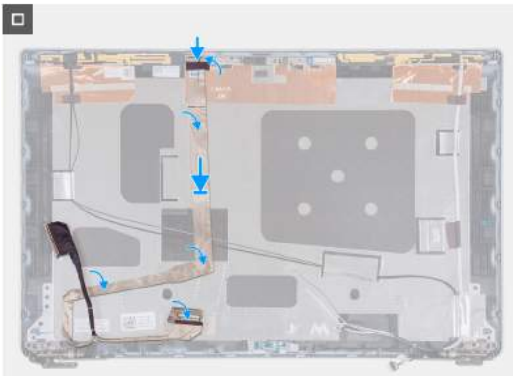
Obrázek 95. Vložení kabelu displeje
