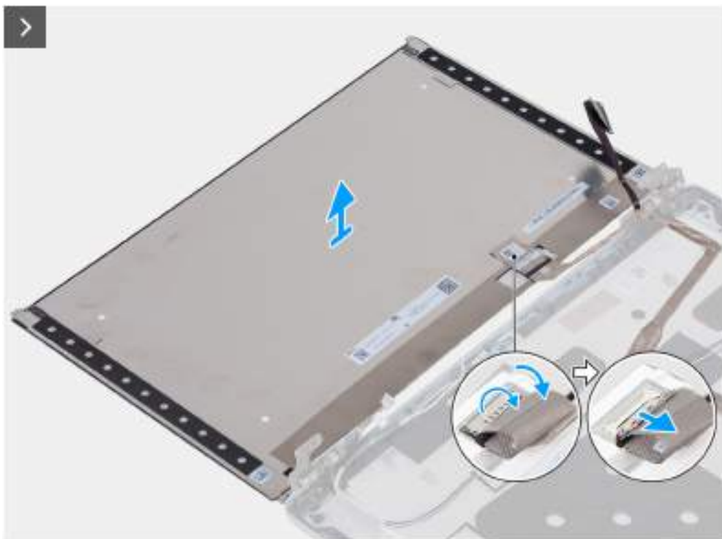
Obrázek 82. Demontáž obrazovky displeje
