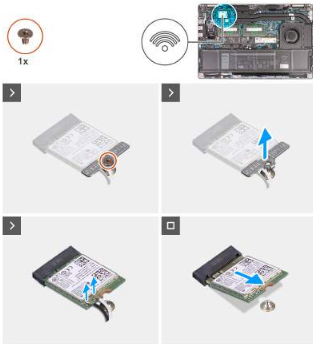
Obrázek 19. Demontáž bezdrátové karty
