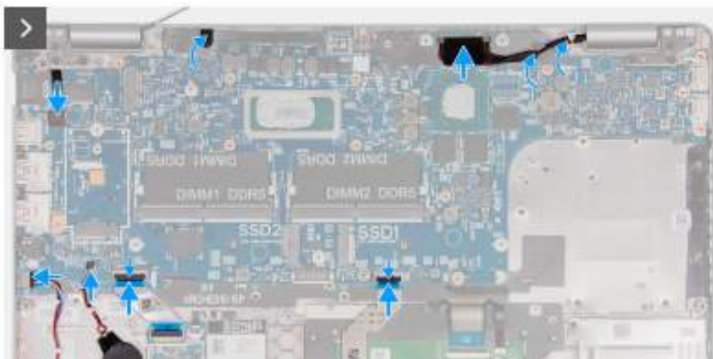
Obrázek 63. Montáž základní desky
