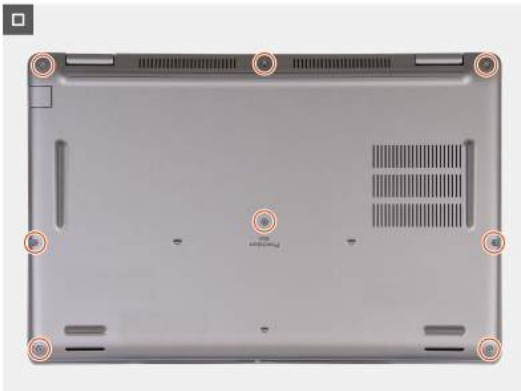
Obrázek 18. Utažení jisticích šroubků
