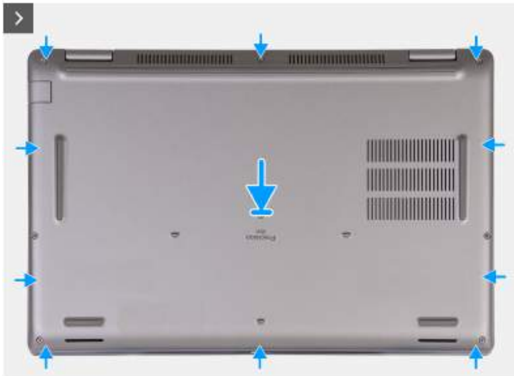
Obrázek 17. Nasazení spodního krytu
