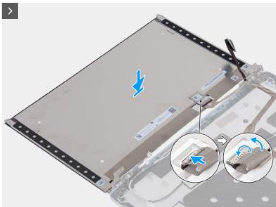
Obrázek 85. Montáž obrazovky displeje
