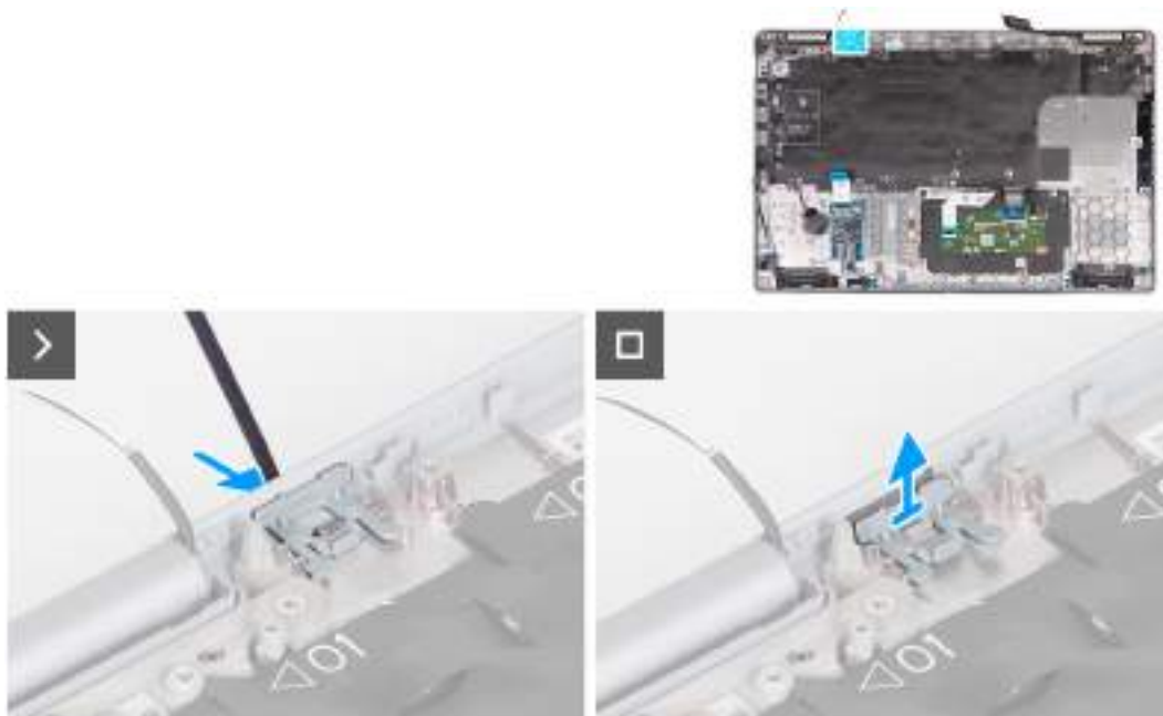
Obrázek 100. Demontáž pomocné výplně slotu na kartu SIM
