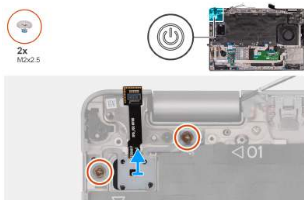
Obrázek 67. Demontáž vypínače s volitelnou čtečkou otisků prstů
