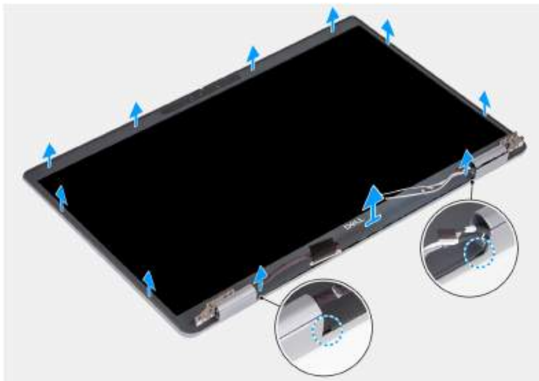
Obrázek 78. Demontáž čelního krytu displeje
