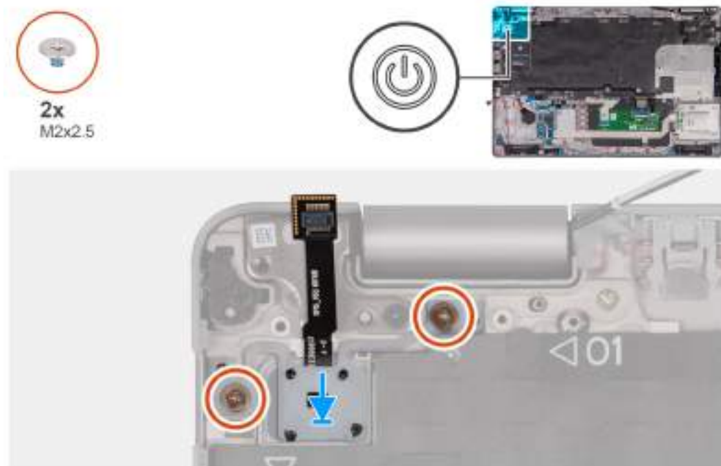
Obrázek 68. Montáž vypínače s volitelnou čtečkou otisků prstů
