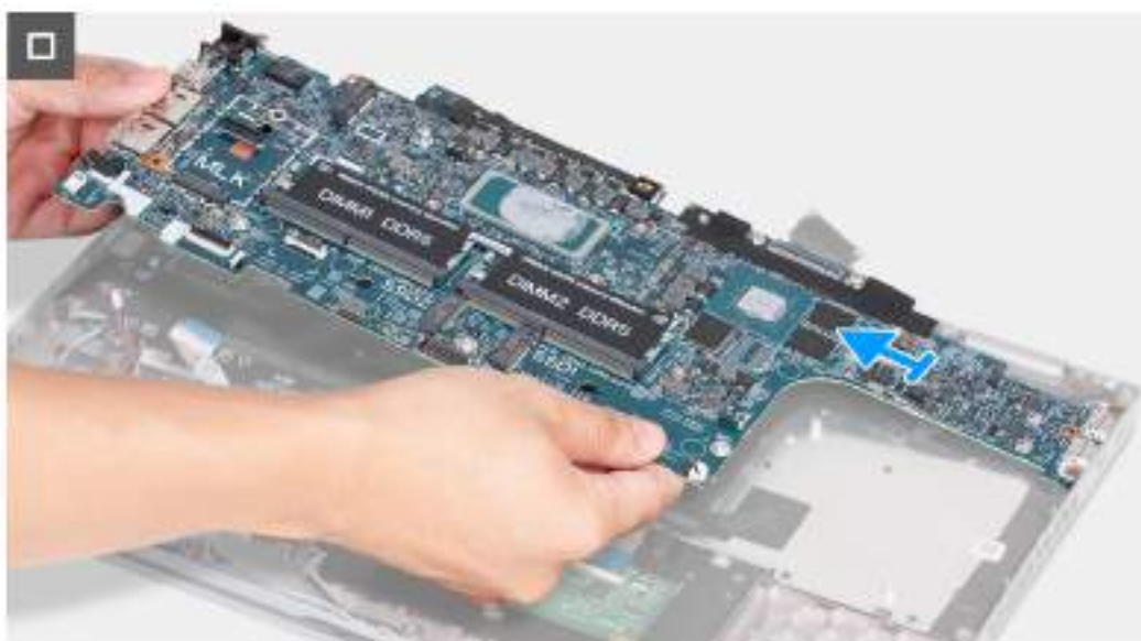
Obrázek 60. Demontáž základní desky
