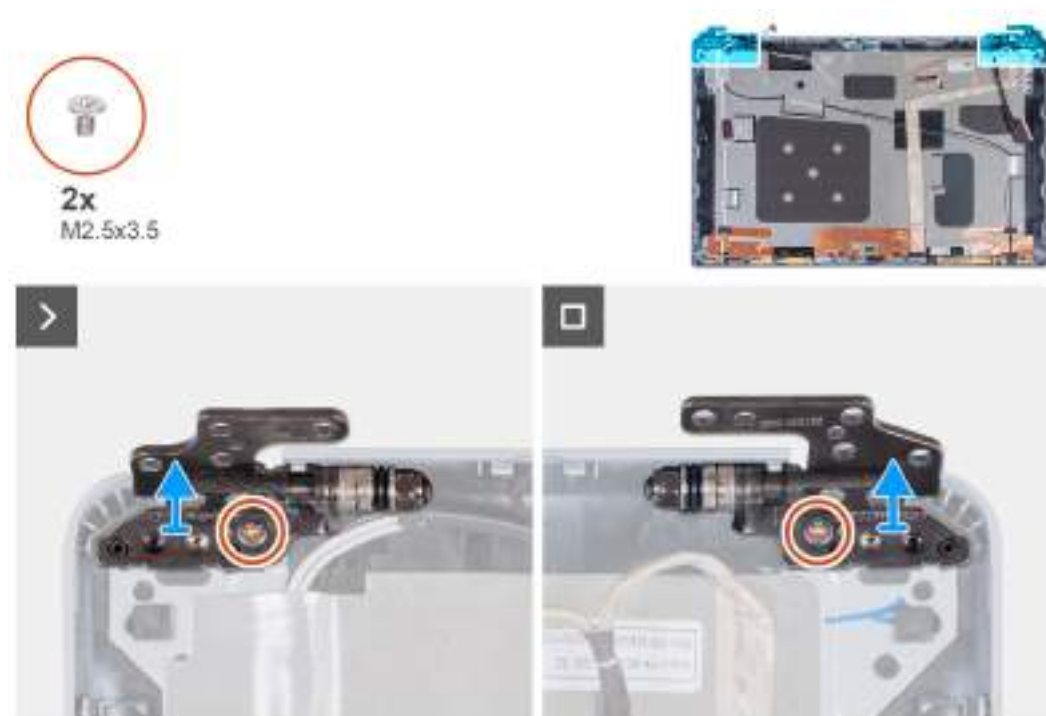
Obrázek 90. Demontáž pantů displeje
