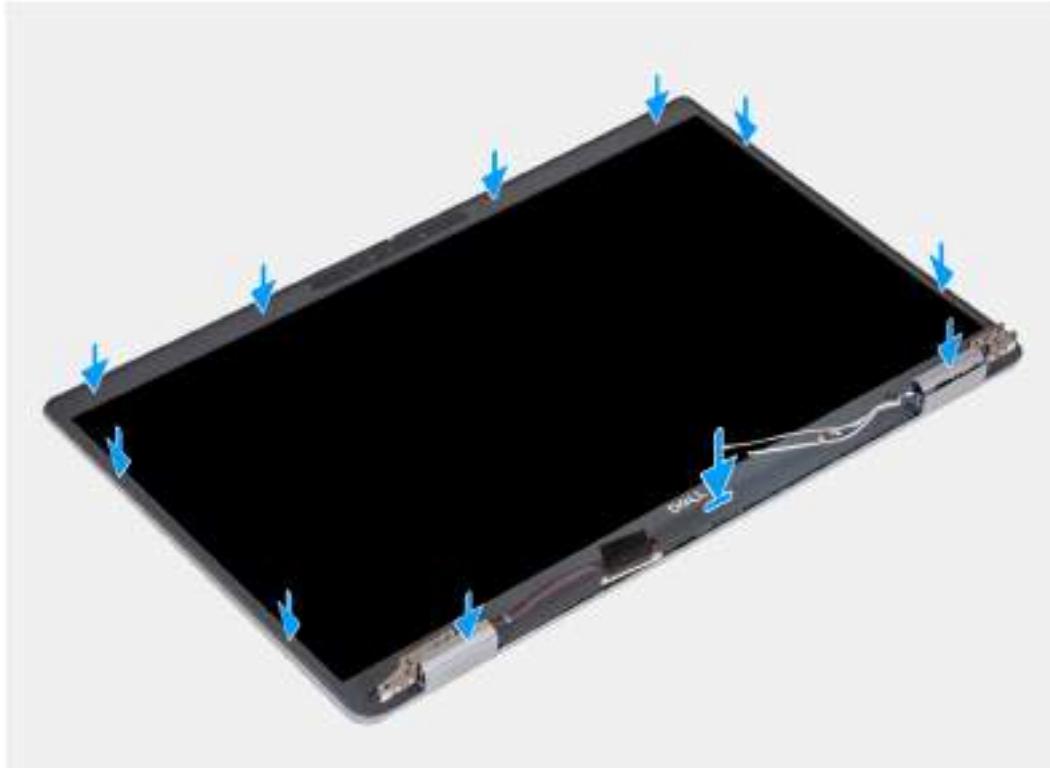
Obrázek 79. Montáž čelního krytu displeje
