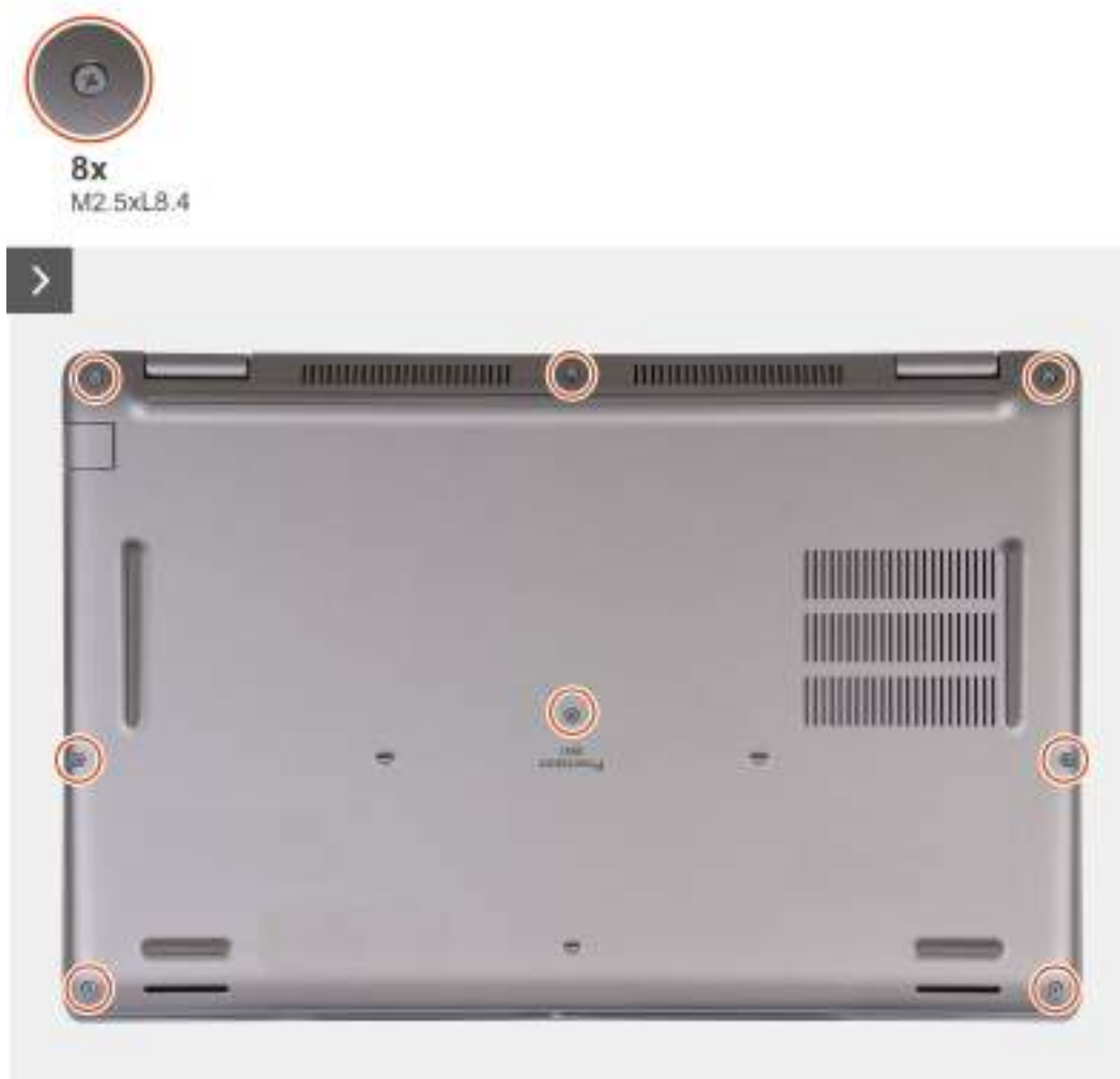
Obrázek 13. Povolení jisticích šroubků
