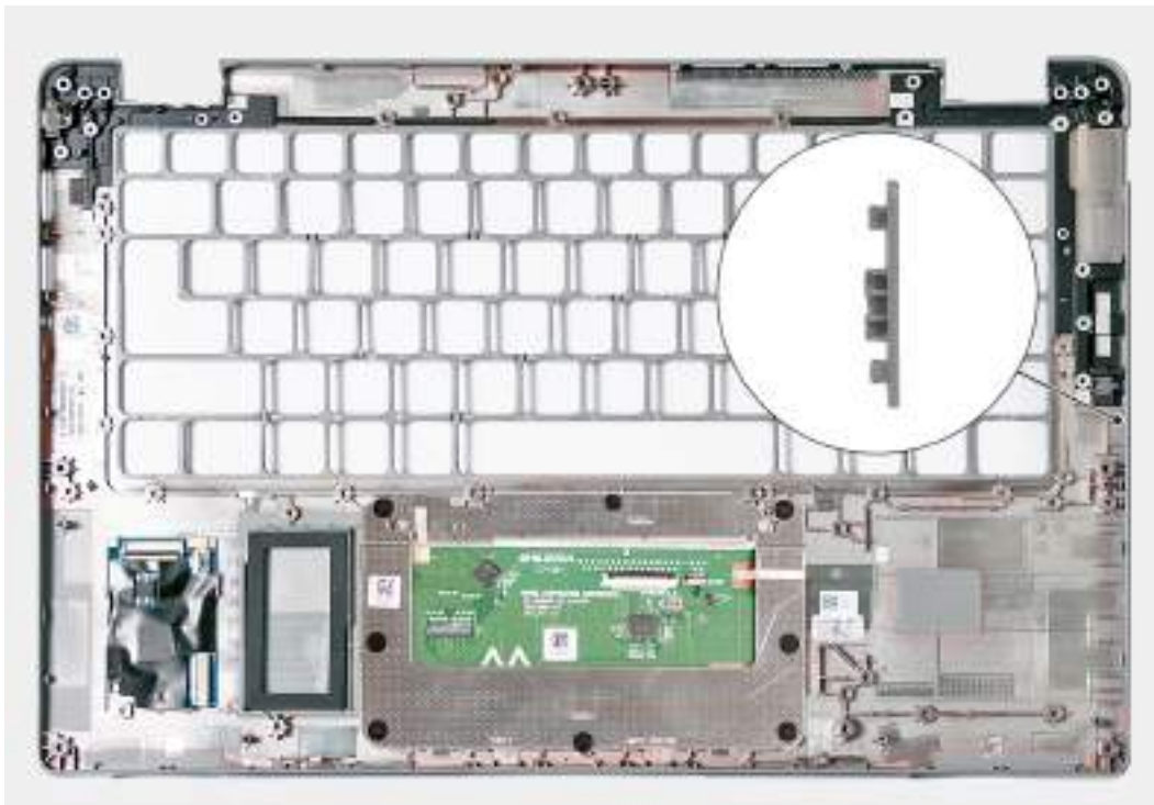
Obrázek 84. Montáž sestavy opěrky pro dlaň
