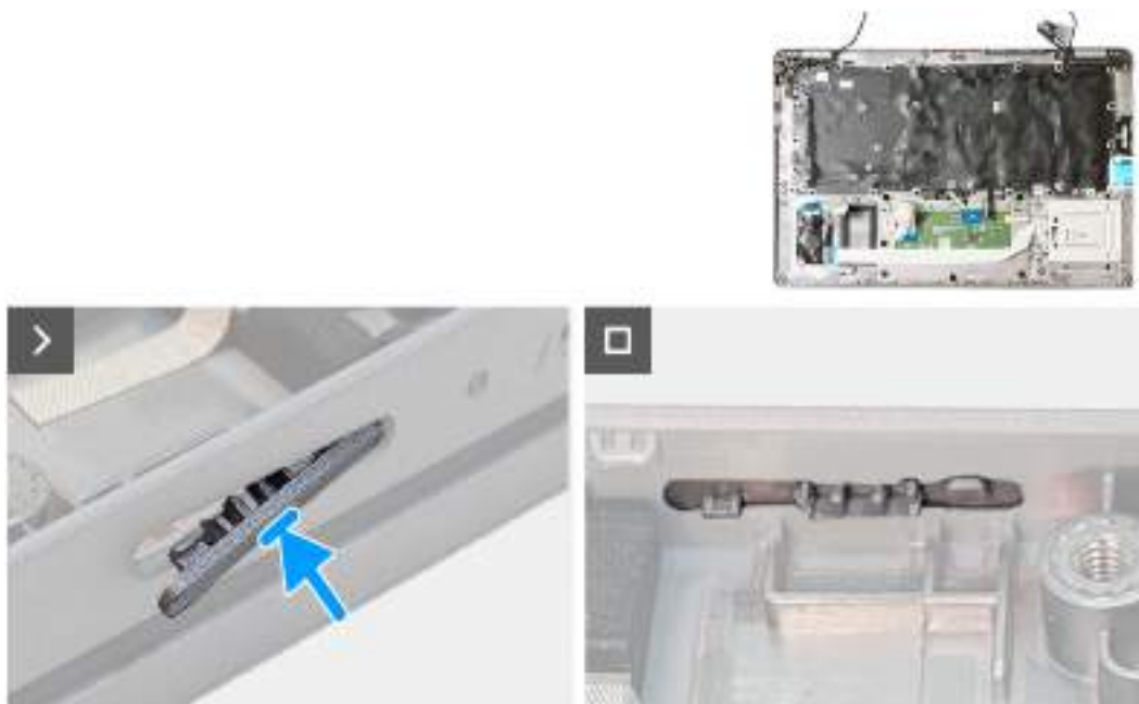
Obrázek 86. Montáž pomocné výplně slotu na kartu SIM
