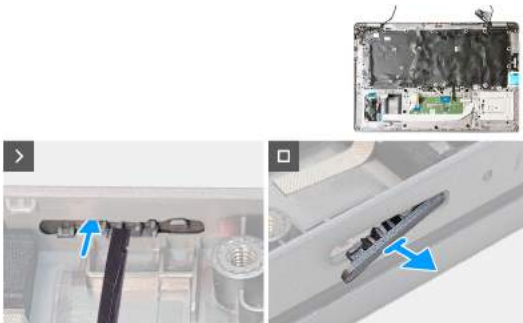
Obrázek 85. Demontáž pomocné výplně slotu na kartu SIM
