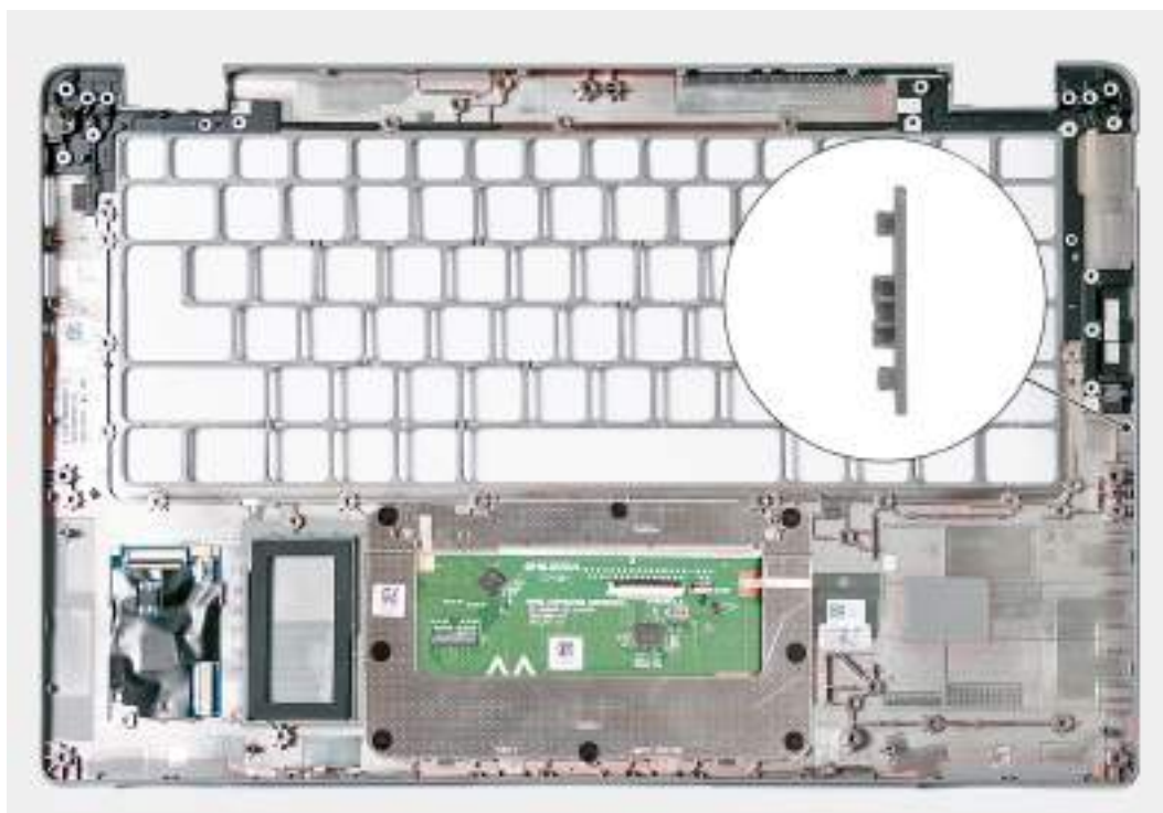
Obrázek 83. Demontáž sestavy opěrky pro dlaň
