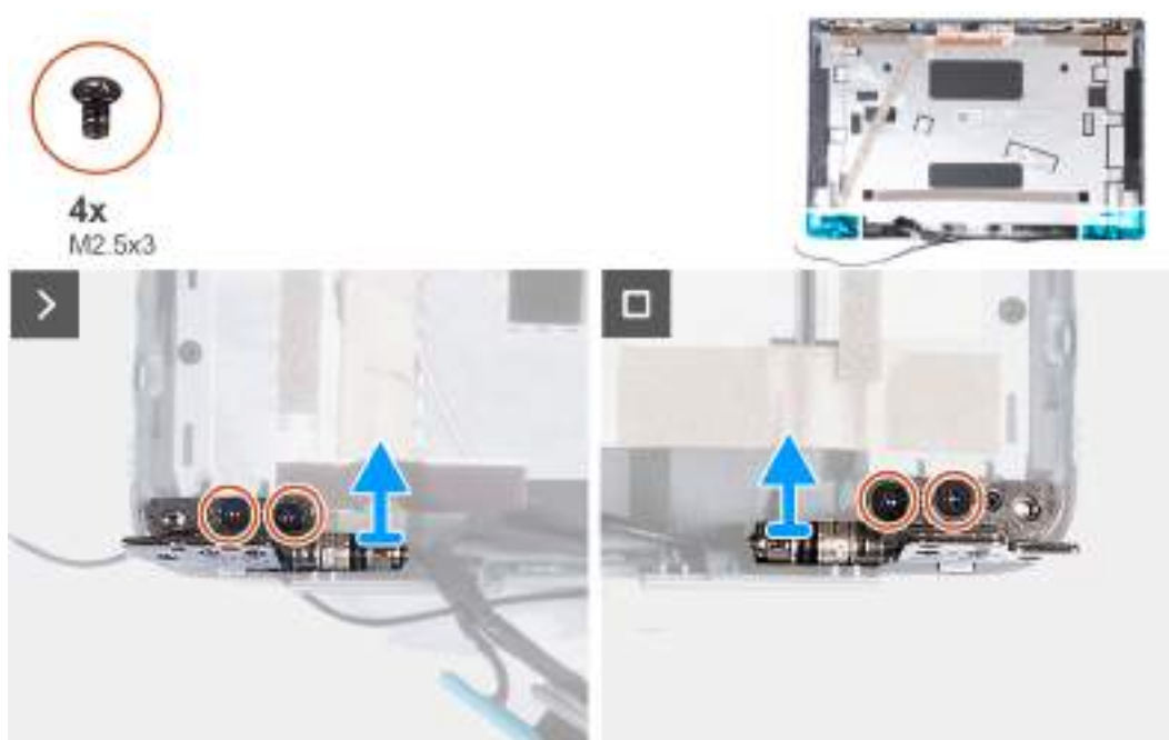
Obrázek 60. Demontáž pantů displeje
