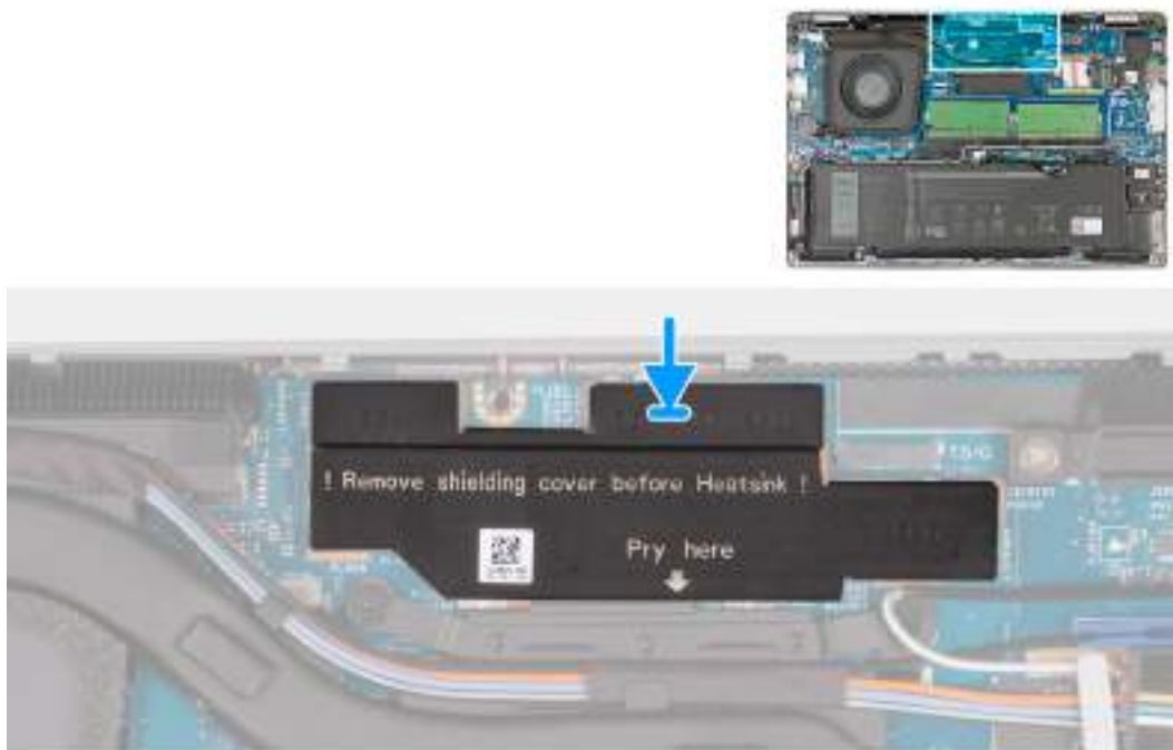
Obrázek 35. Montáž stínícího krytu napájení – u počítačů dodávaných se základní deskou H28 UMA
