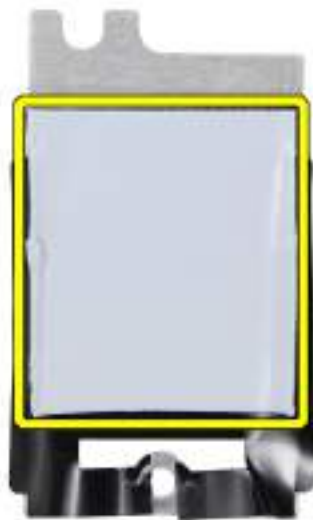
Obrázek 17. Teplovodivá podložka pod tepelným krytem SSD
