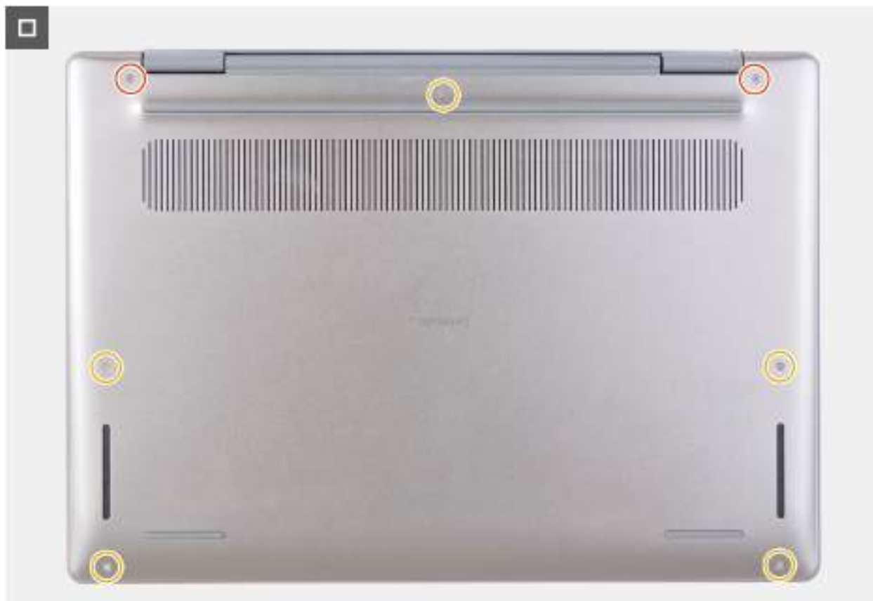
Obrázek 15. Zašroubování a utažení šroubů
