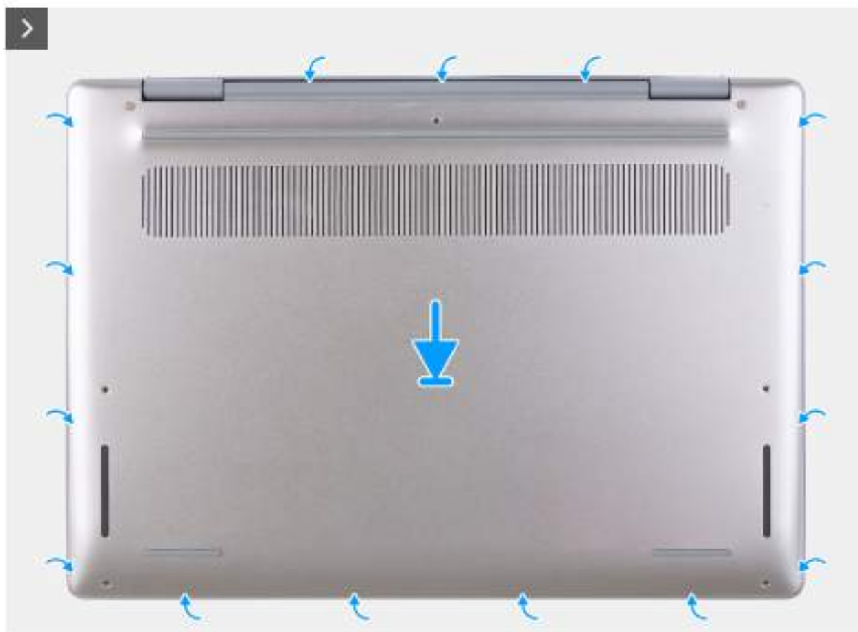
Obrázek 14. Nasazení spodního krytu
