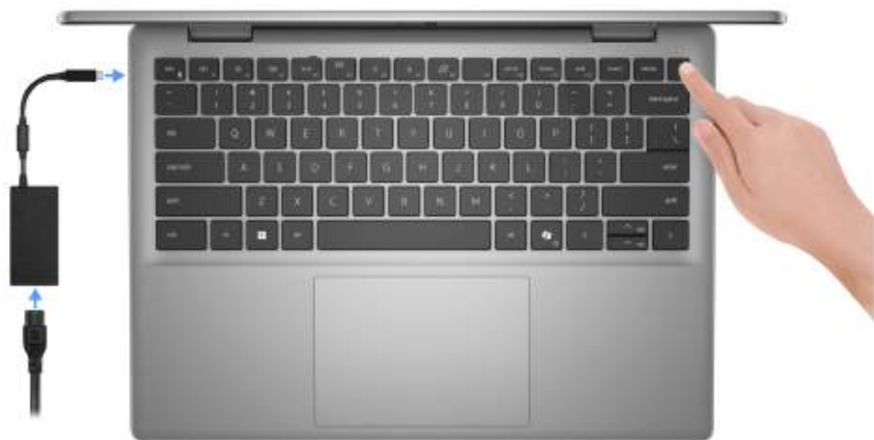
Obrázek 7. Připojte napájecí adaptér a stiskněte vypínač
