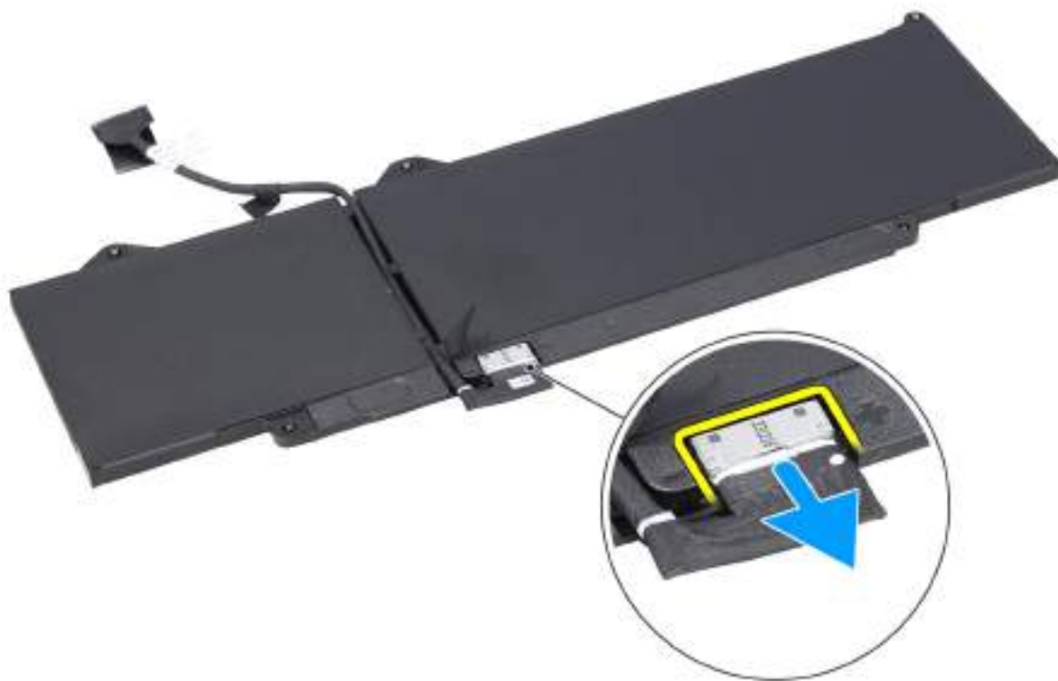
Obrázek 30. Odpojení kabelu baterie
