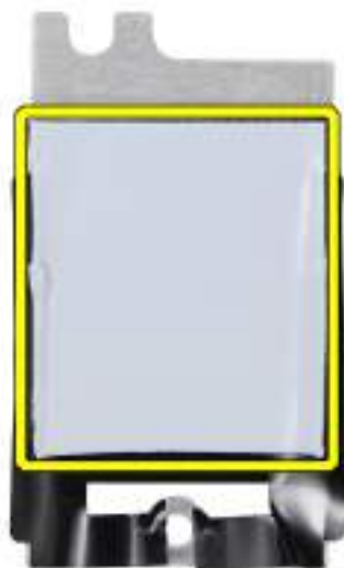
Obrázek 20. Teplovodivá podložka pod tepelným krytem SSD
