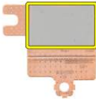
Obrázek 45. Teplovodivá podložka pod tepelným krytem WLAN
