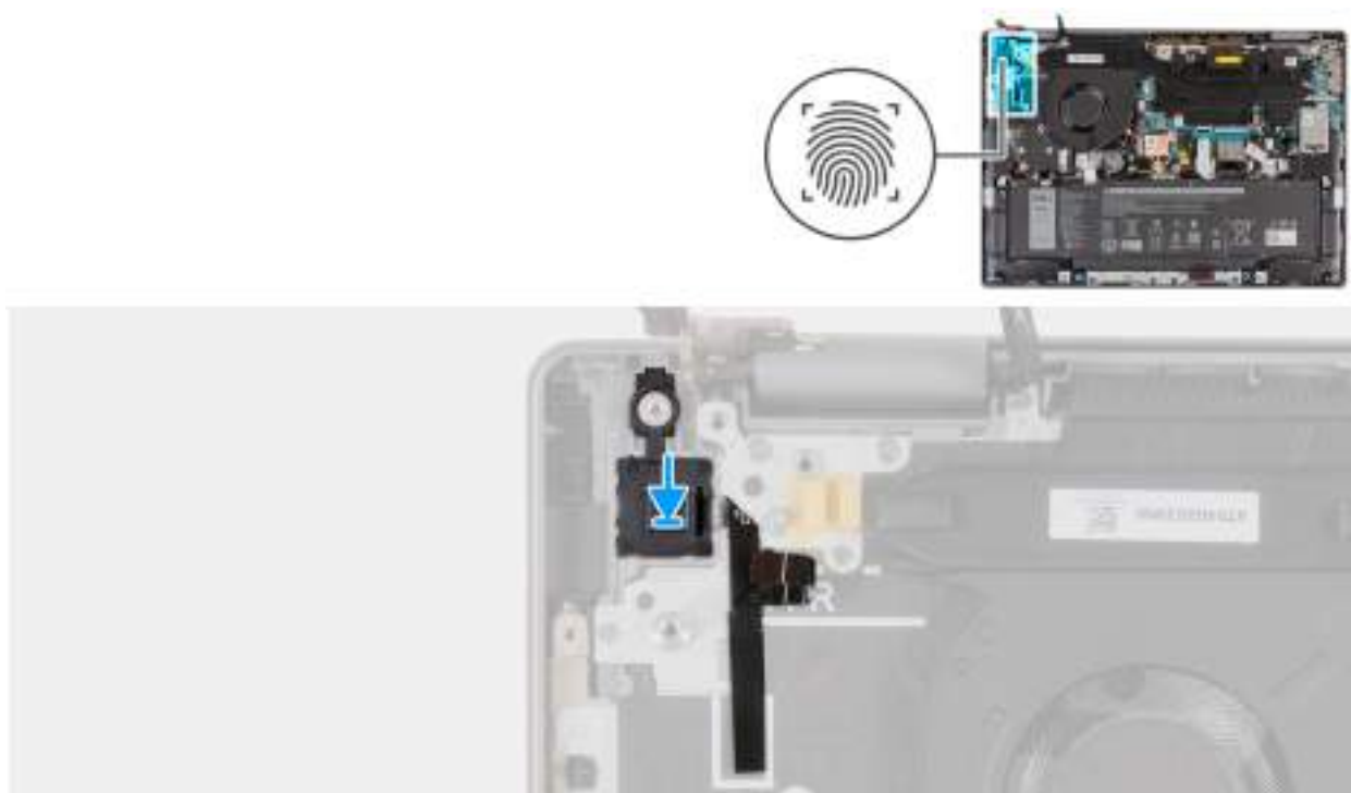
Obrázek 57. Montáž vypínače se čtečkou otisků prstů
