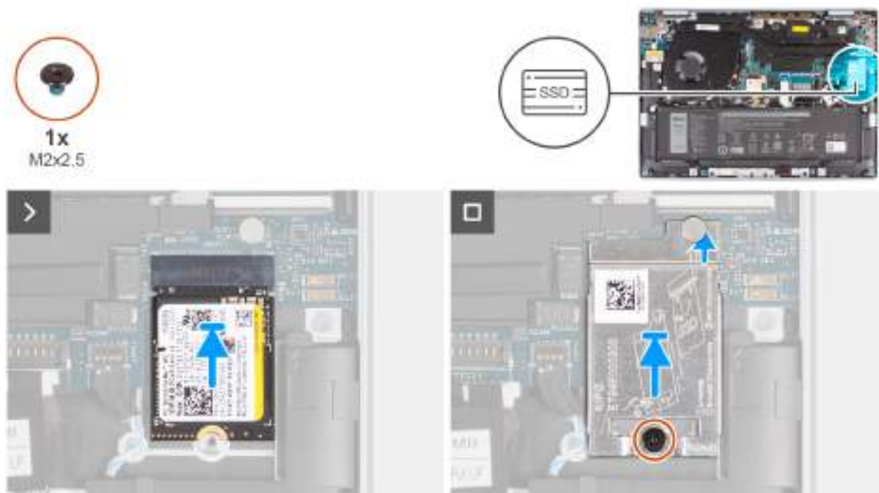
Obrázek 18. Montáž disku SSD
