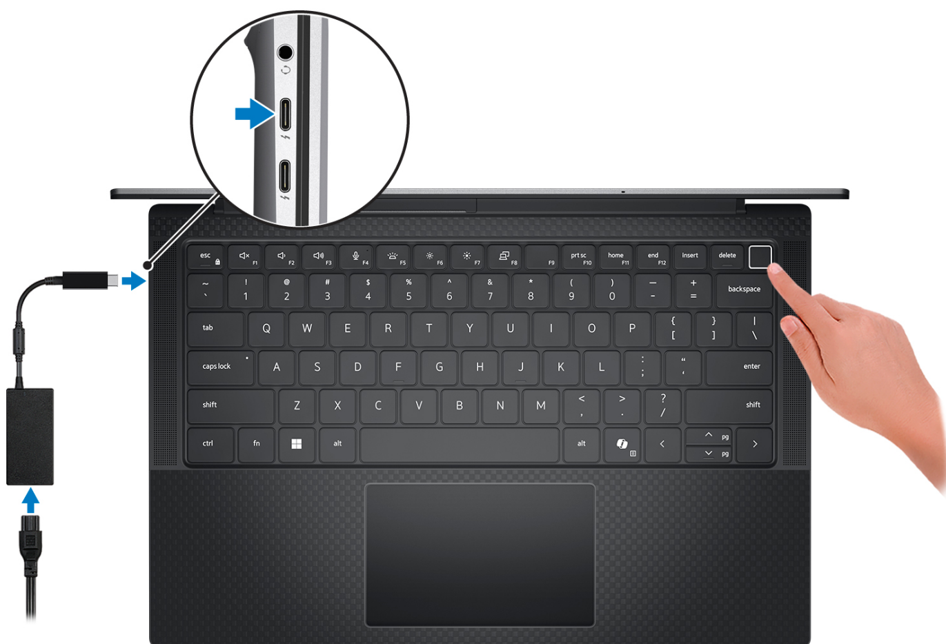
Obrázek 7. Připojte napájecí adaptér a stiskněte vypínač.
