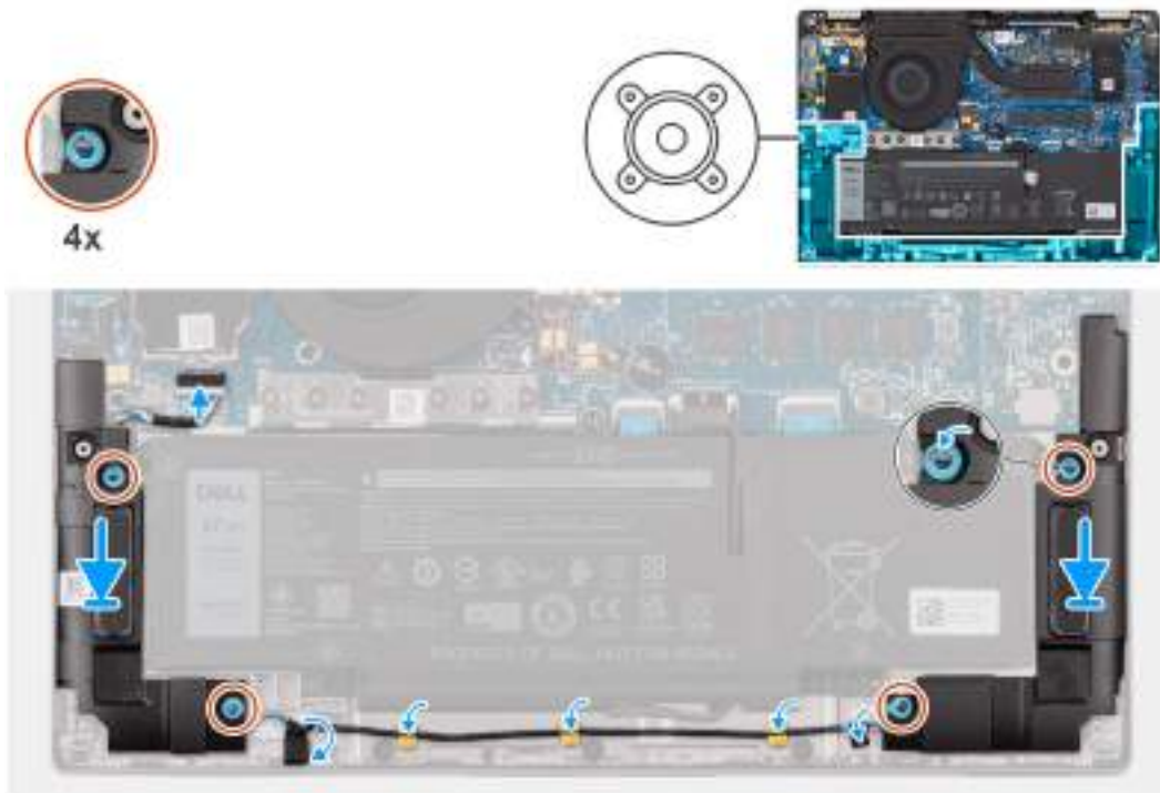
Obrázek 34. Montáž reproduktorů u běžných počítačů
