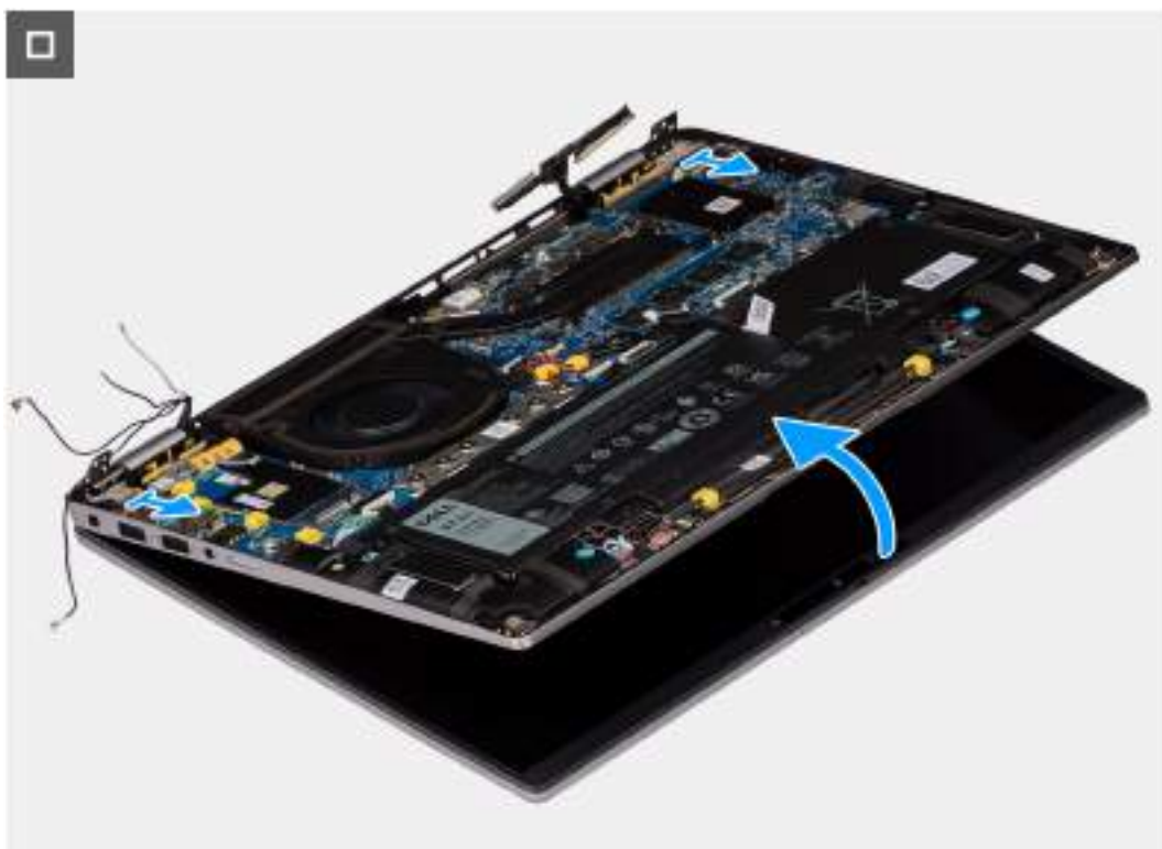
Obrázek 50. Demontáž sestavy displeje
