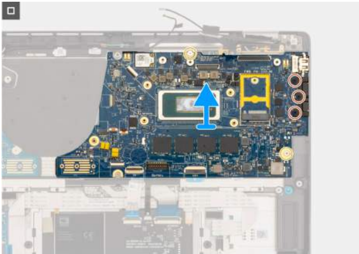
Obrázek 60. Demontáž základní desky
