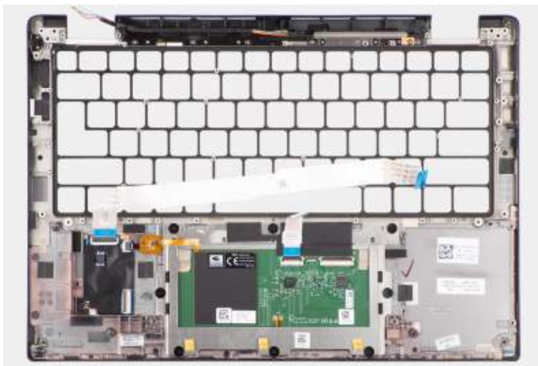
Obrázek 85. Montáž sestavy opěrky pro dlaň
