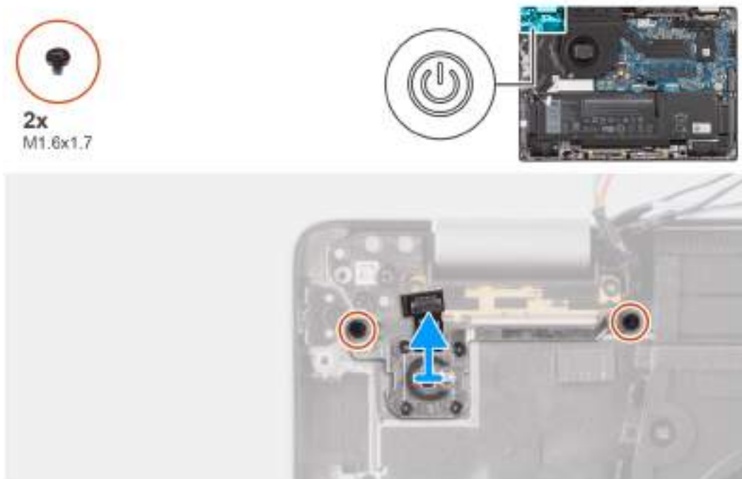
Obrázek 76. Demontáž vypínače s volitelnou čtečkou otisků prstů
