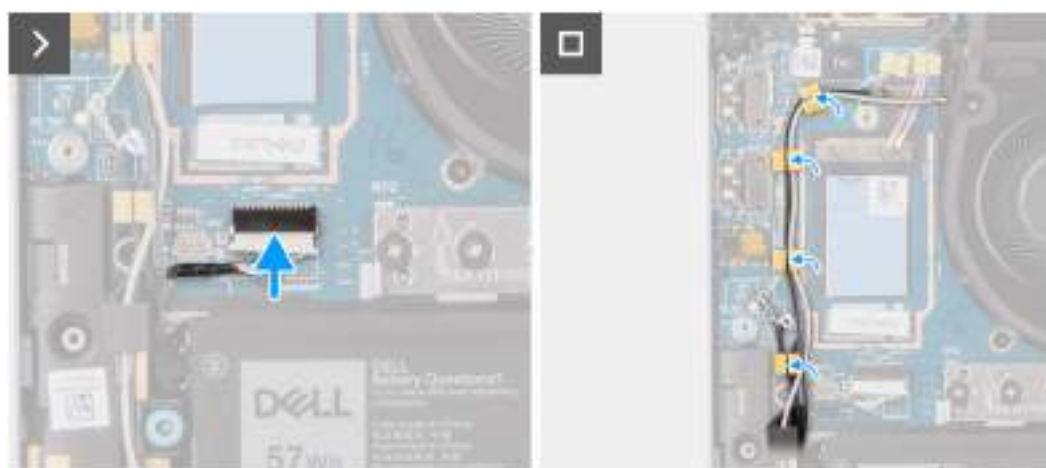
Obrázek 32. Montáž reproduktorů u modelů Ultralight
