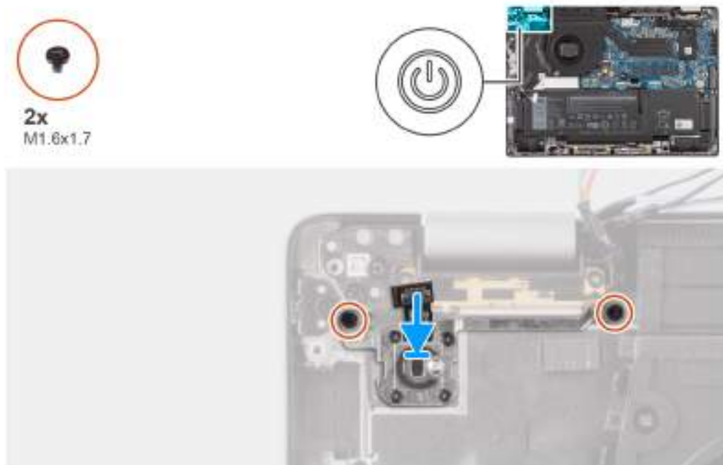
Obrázek 77. Montáž tlačítka napájení s volitelnou čtečkou otisků prstů
