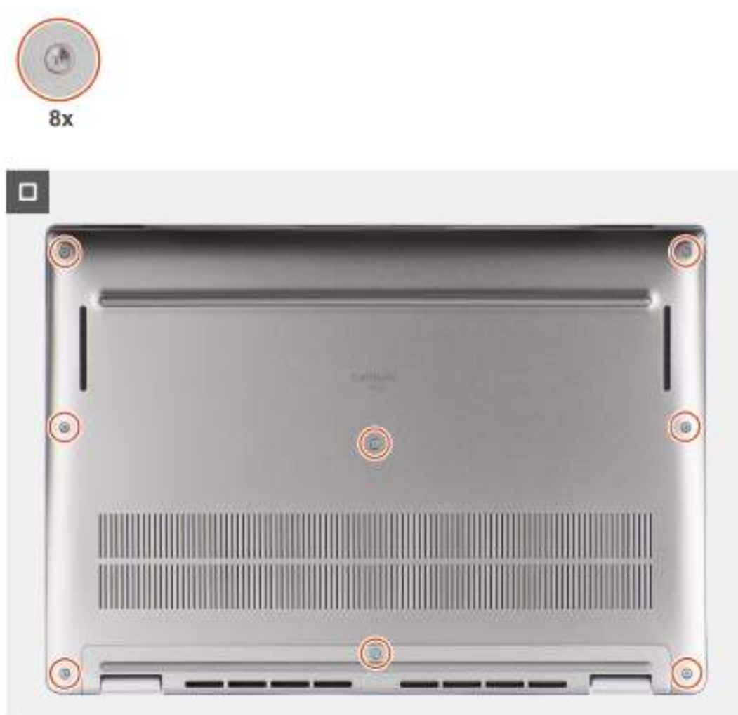
Obrázek 21. Nasazení spodního krytu
