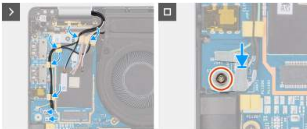
Obrázek 55. Montáž sestavy displeje
