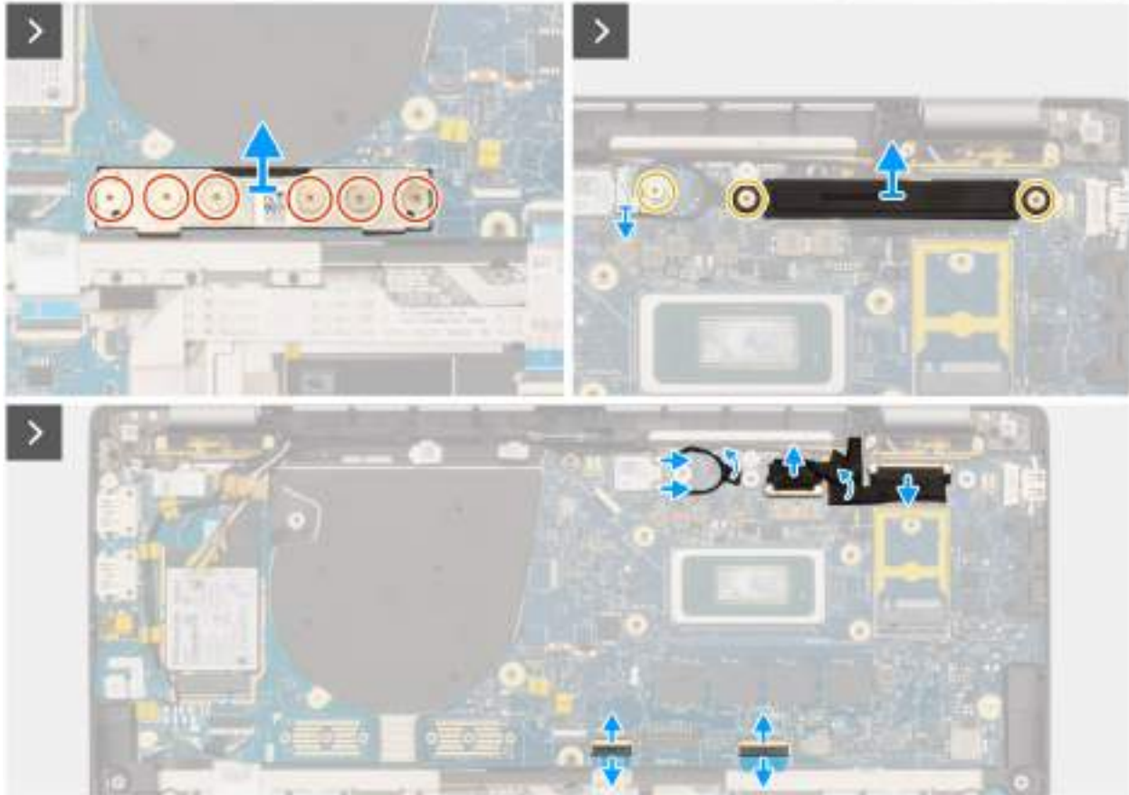
Obrázek 59. Demontáž základní desky
