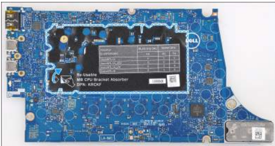
Obrázek 62. Absorbér držáku procesoru
