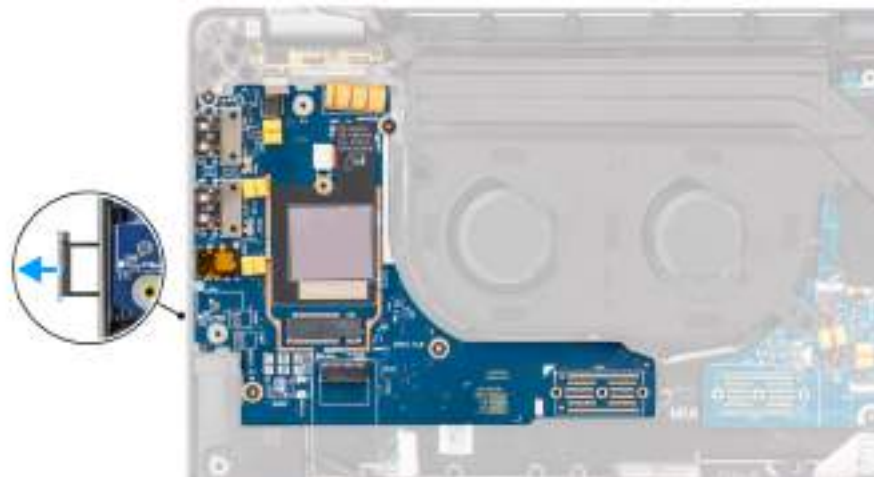
Obrázek 70. Demontáž dceřiné desky I/O
