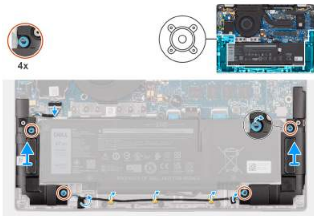
Obrázek 33. Demontáž reproduktorů u běžných počítačů
