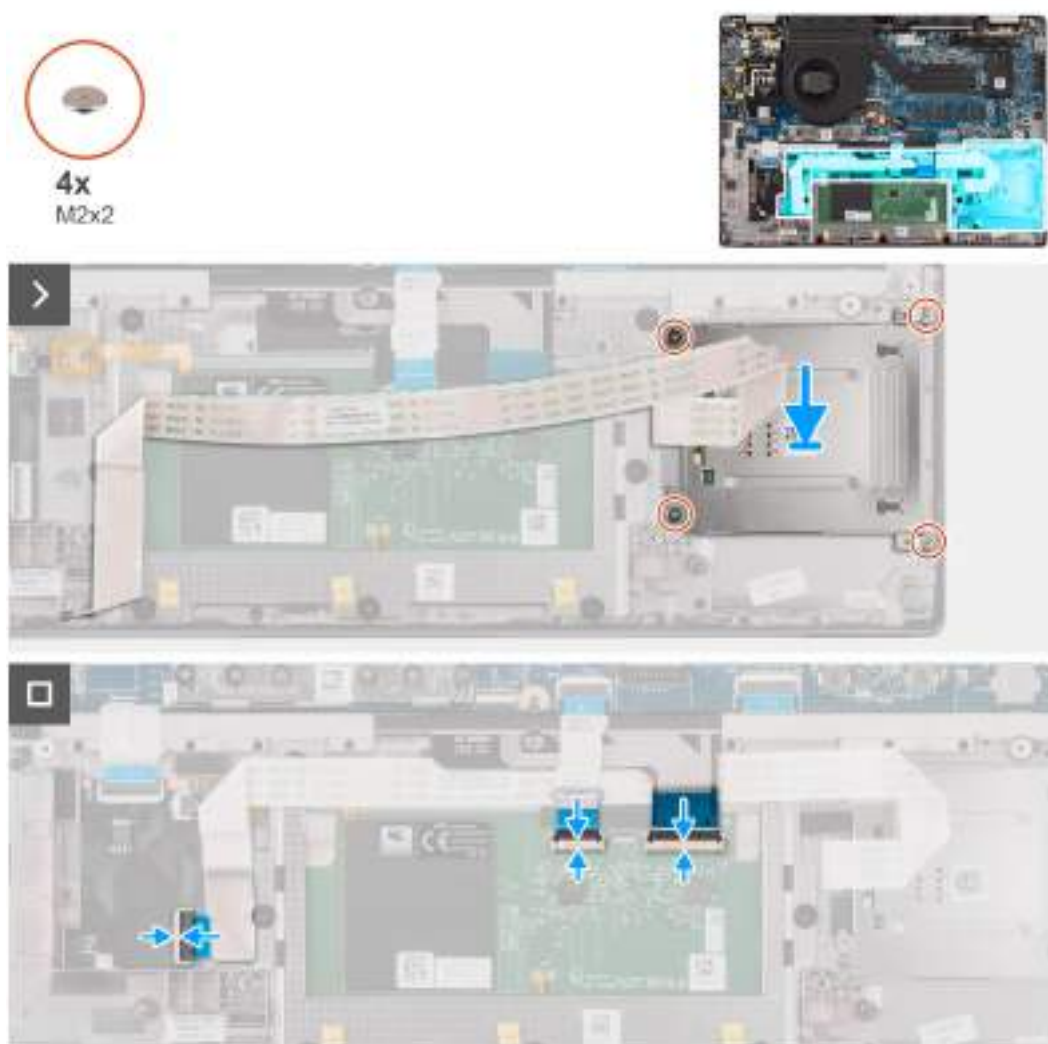
Obrázek 57. Montáž čtečky čipových karet
