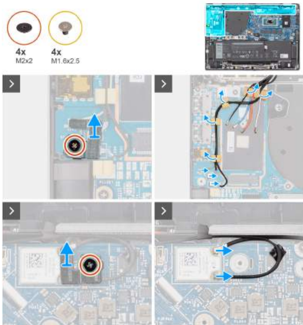
Obrázek 66. Demontáž anténního modulu WLAN
