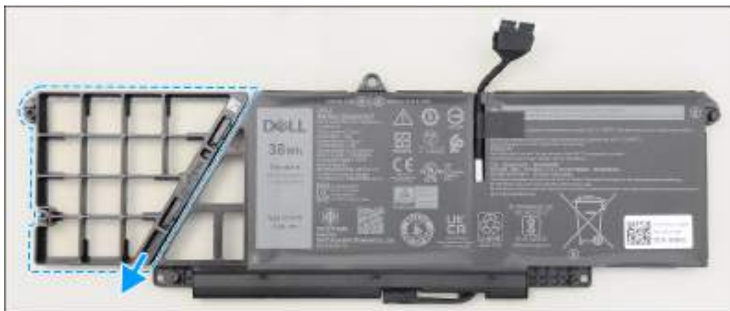
Obrázek 38. Demontáž 2čláňkové baterie
