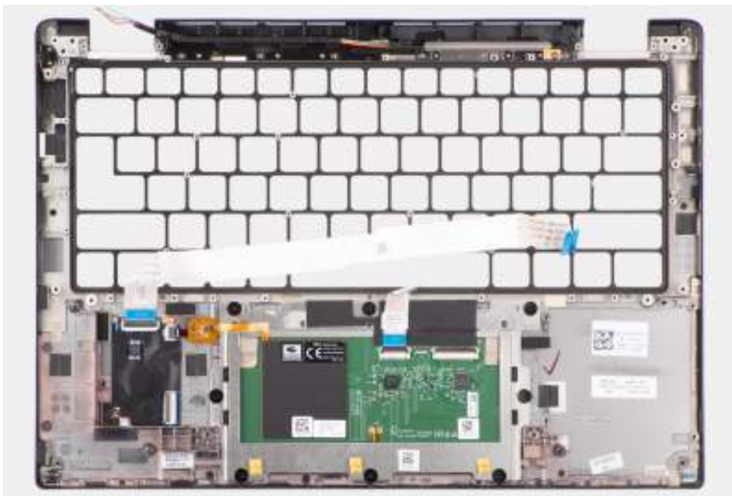
Obrázek 84. Demontáž sestavy opěrky pro dlaň
