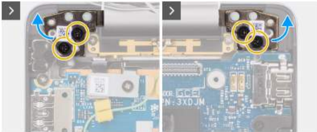
Obrázek 49. Demontáž sestavy displeje
