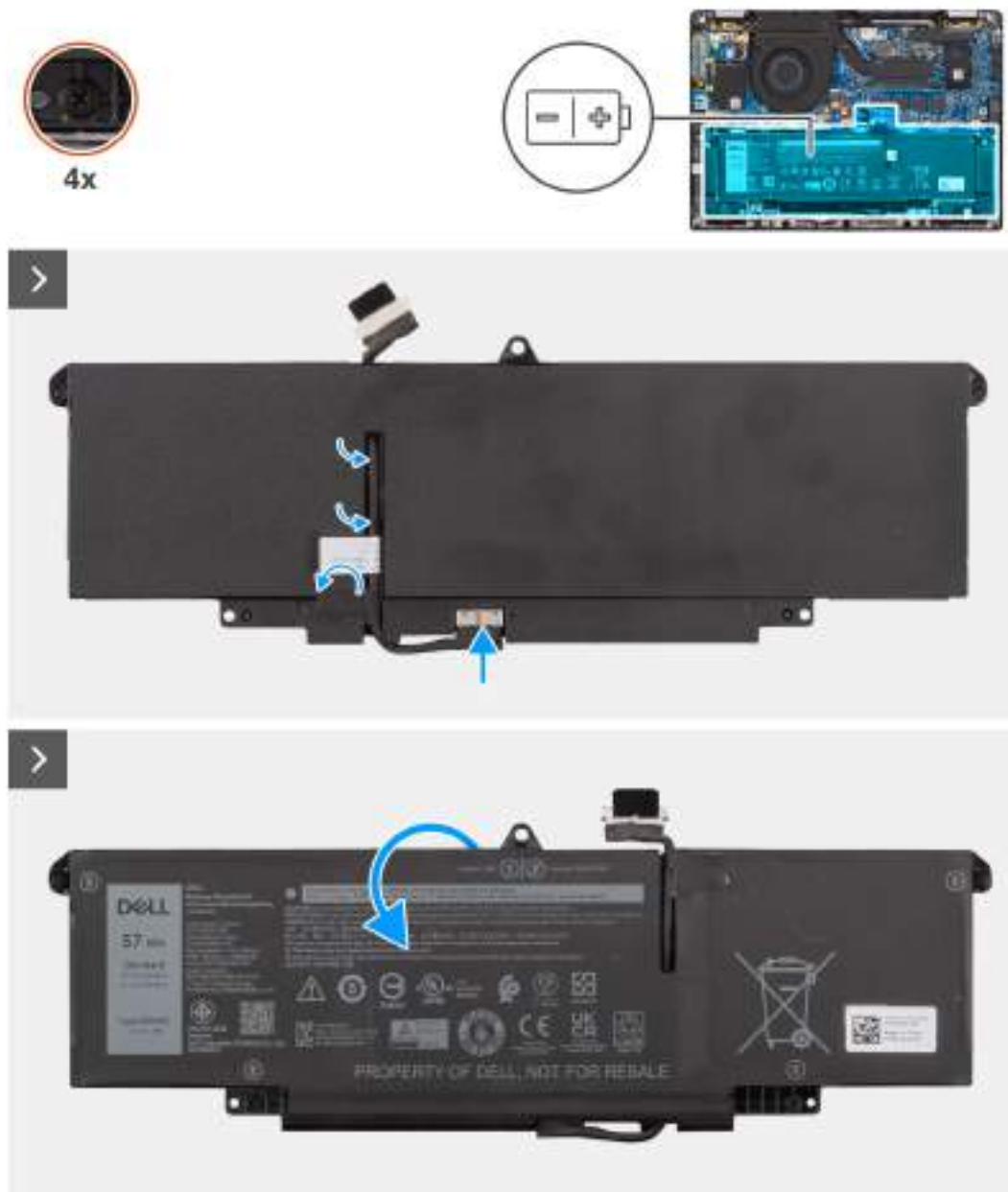
Obrázek 45. Montáž kabelu baterie
