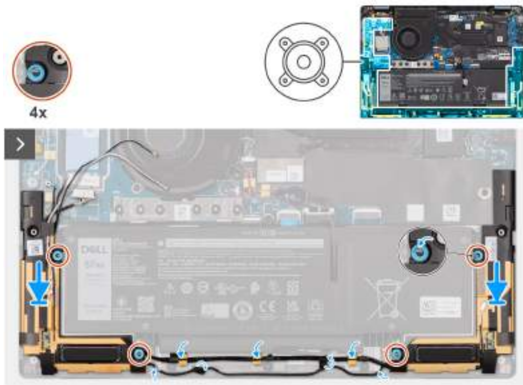
Obrázek 31. Montáž reproduktorů u modelů Ultralight
