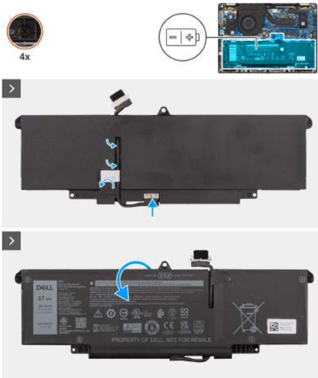
Obrázek 42. Montáž 3člankové baterie
