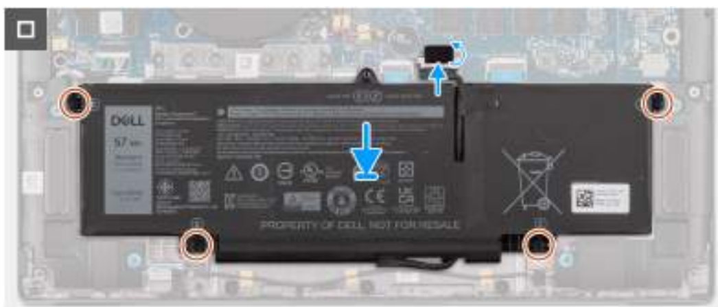
Obrázek 43. Montáž 3člankové baterie
