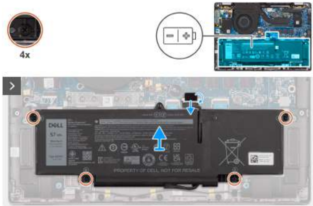
Obrázek 40. Demontáž 3článekové baterie
