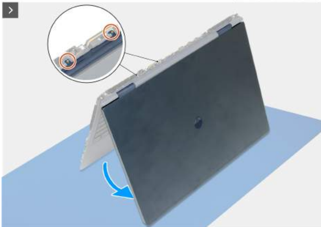
Obrázek 61. Demontáž středového panelu
