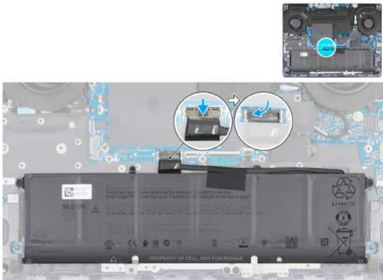
Obrázek 15. Připojení kabelu baterie
