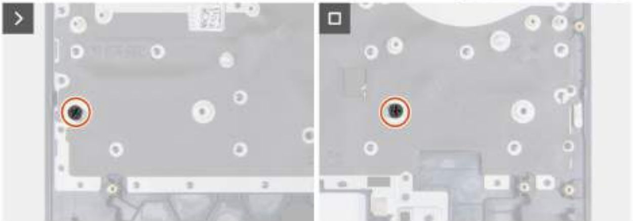
Obrázek 71. Demontáž šroubových držáků disku SSD
