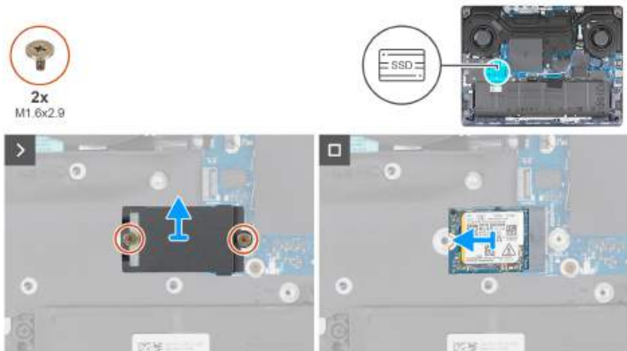
Obrázek 31. Montáž disku SSD M.2 2230 do slotu SSD2
