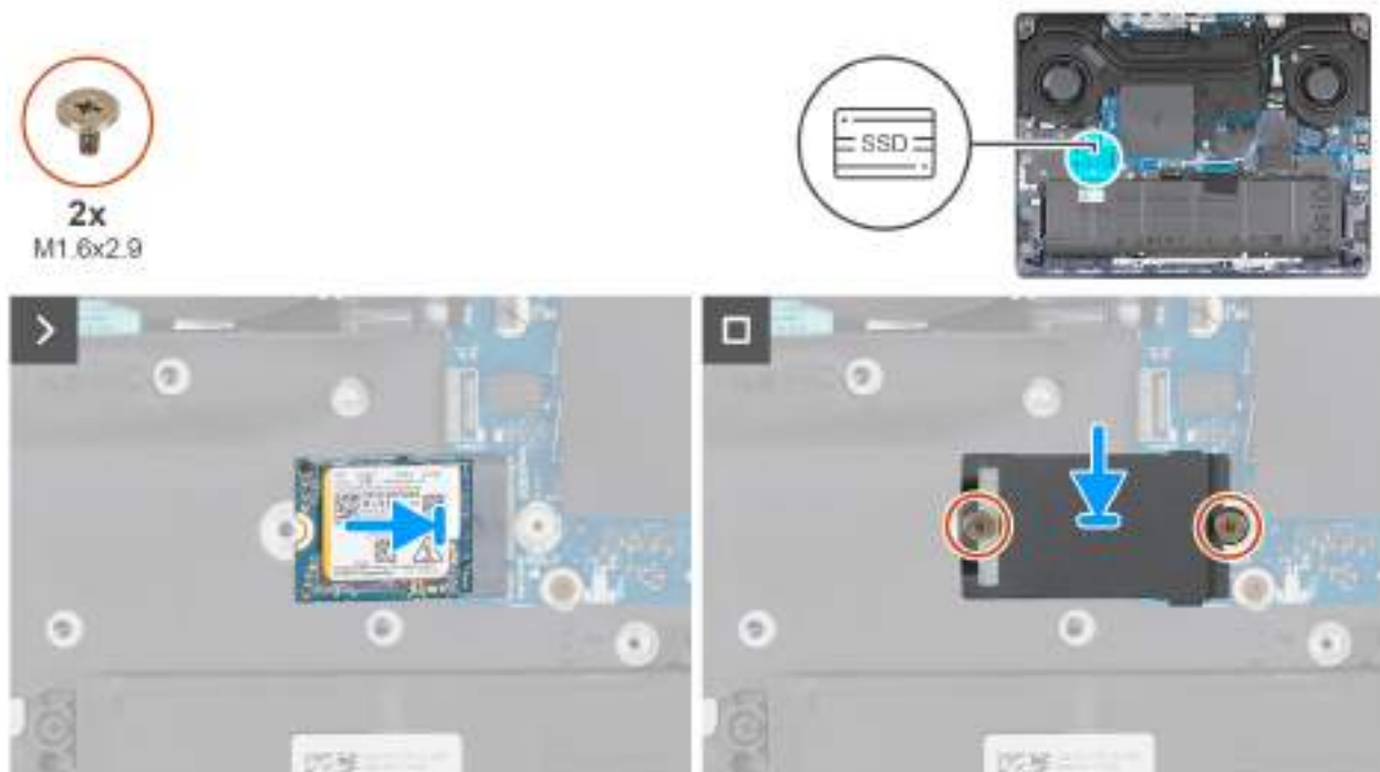
Obrázek 30. Demontáž disku SSD M.2 2230 ze slotu SSD2
