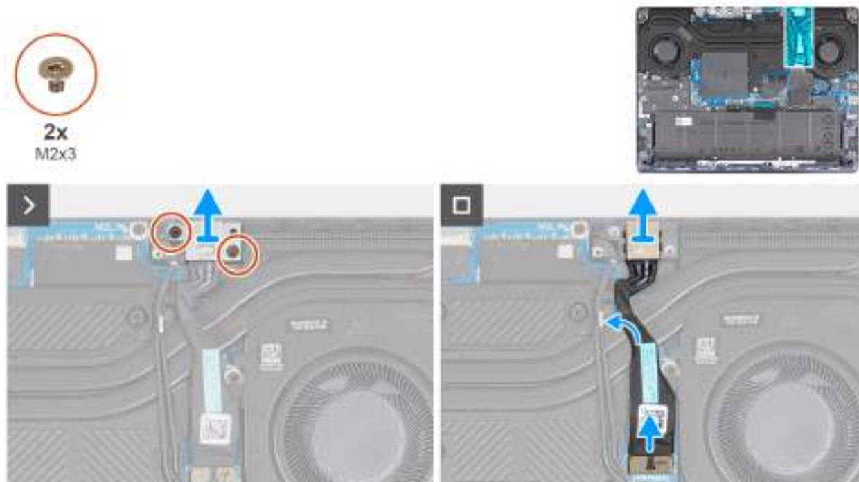
Obrázek 36. Demontáž portu napájecího adaptéru
