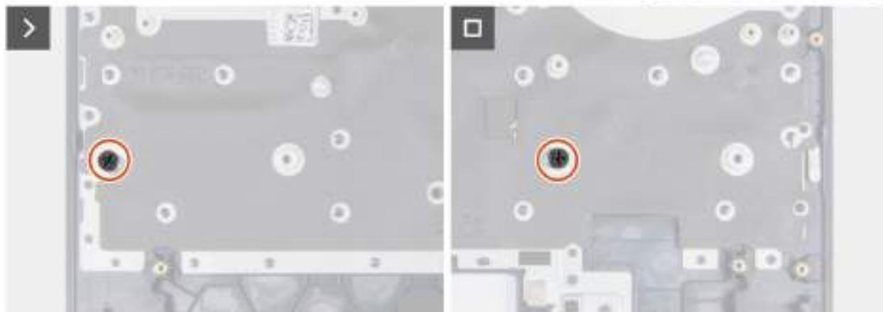
Obrázek 72. Montáž šroubových držáků disku SSD
