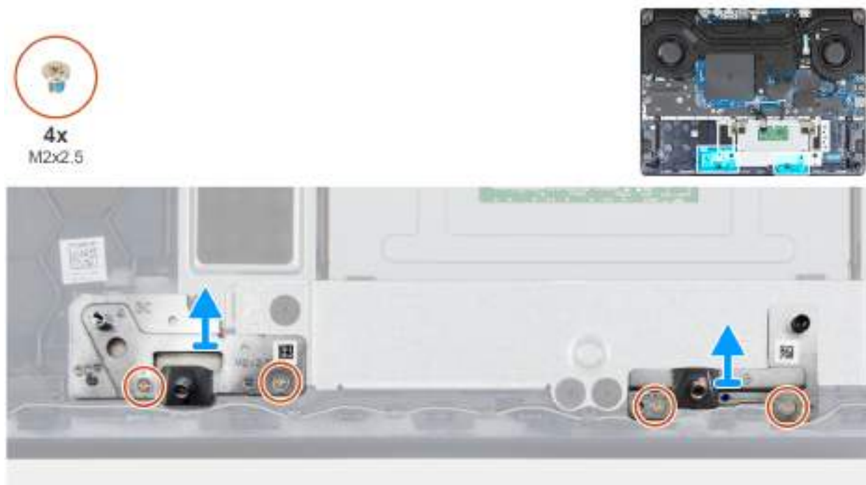
Obrázek 42. Demontáž držáků 3článekové baterie
