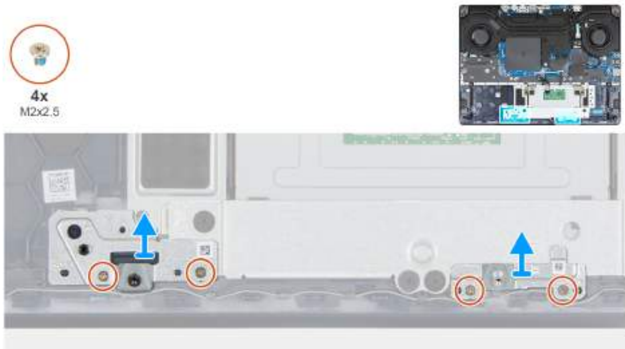
Obrázek 44. Demontáž držáků 6člankové baterie
