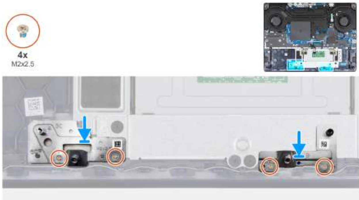
Obrázek 43. Montáž držáků 3člankové baterie
