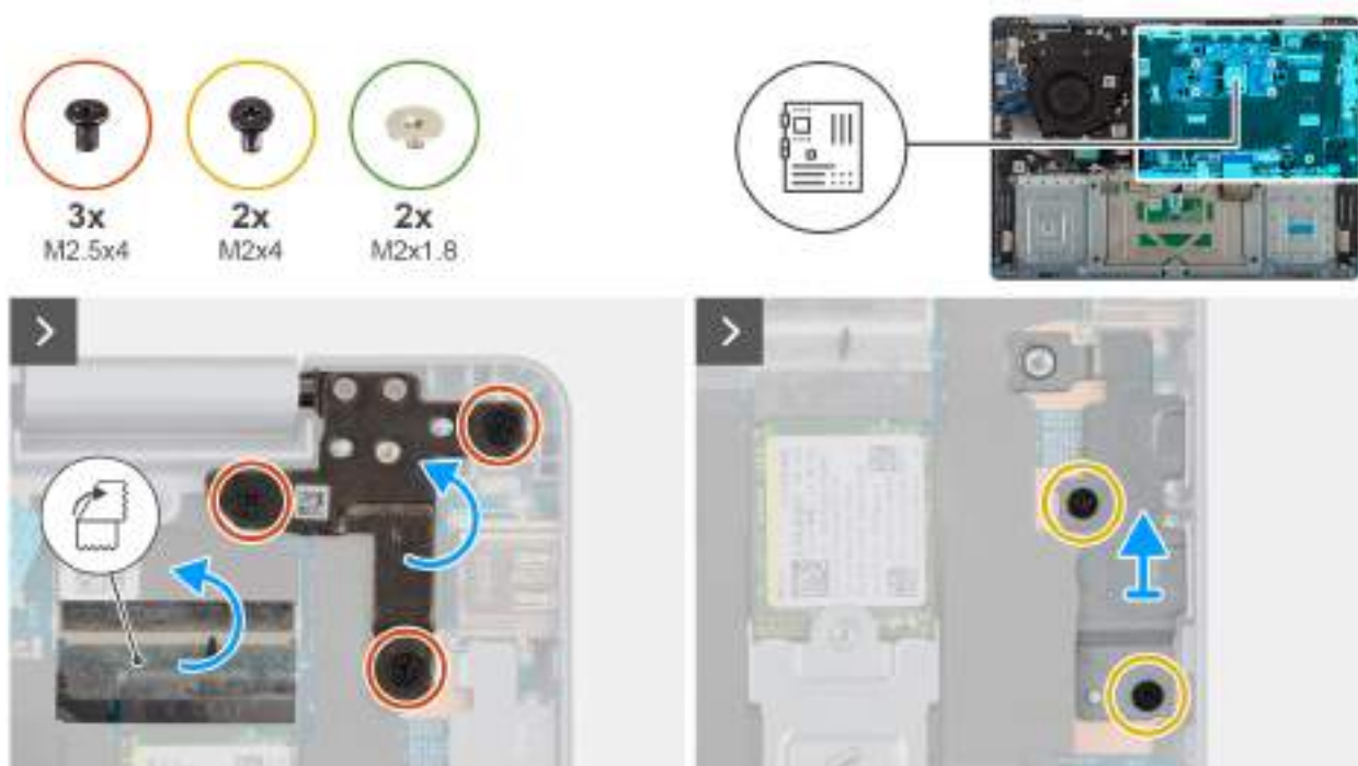
Obrázek 39. Demontáž základní desky
