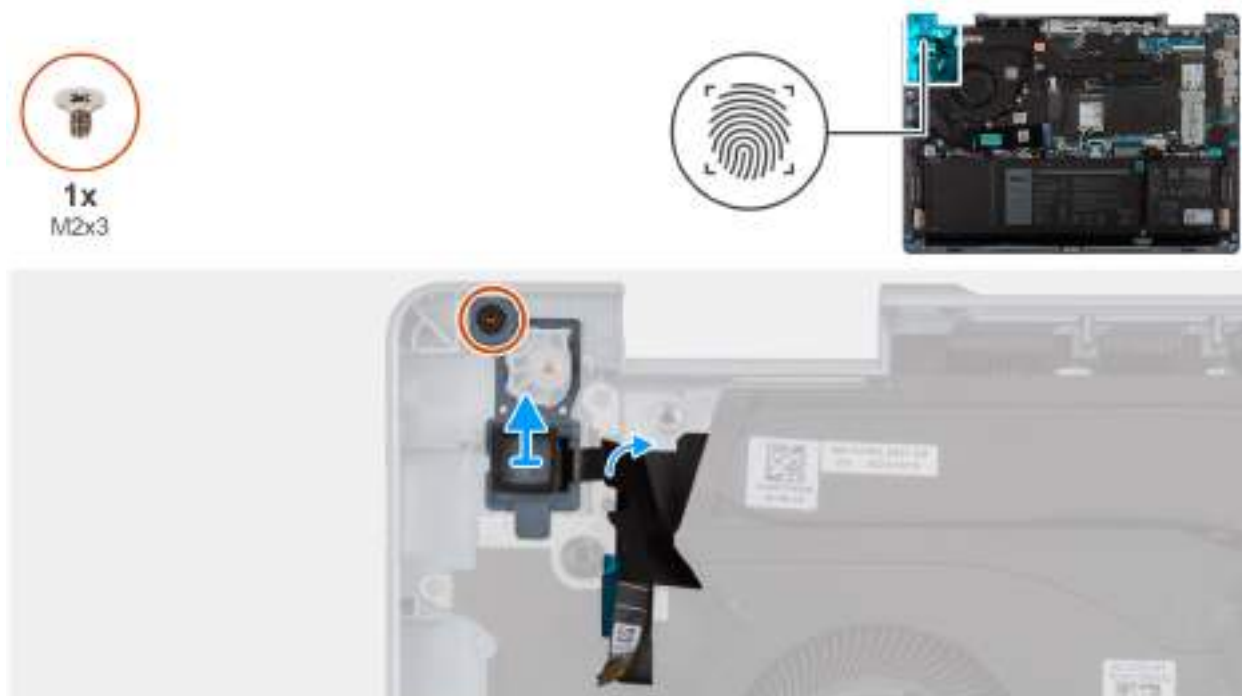
Obrázek 50. Demontáž vypínače se čtečkou otisků prstů
