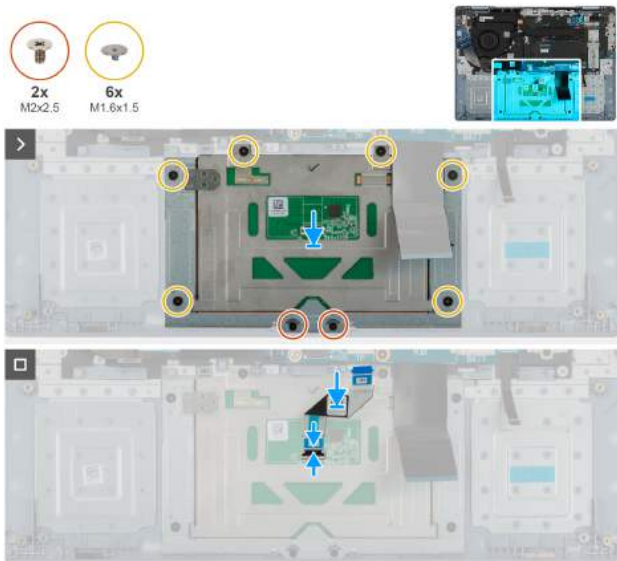
Obrázek 53. Montáž dotykové podložky
