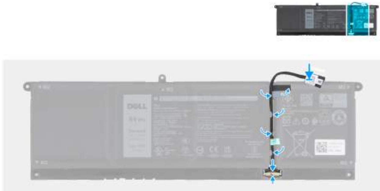
Obrázek 18. Montáž kabelu baterie
