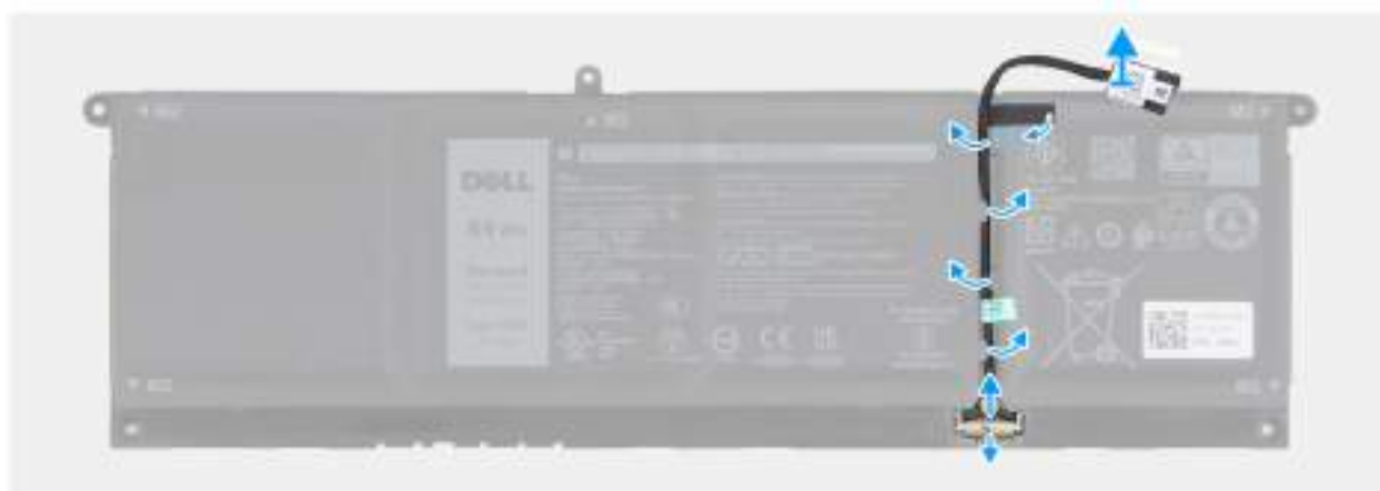
Obrázek 17. Demontáž kabelu baterie
