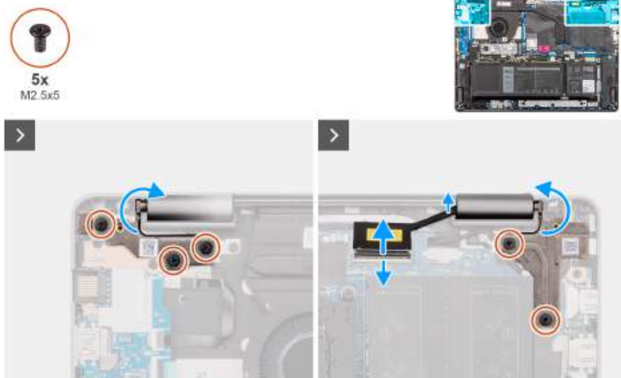
Obrázek 47. Demontáž sestavy displeje
