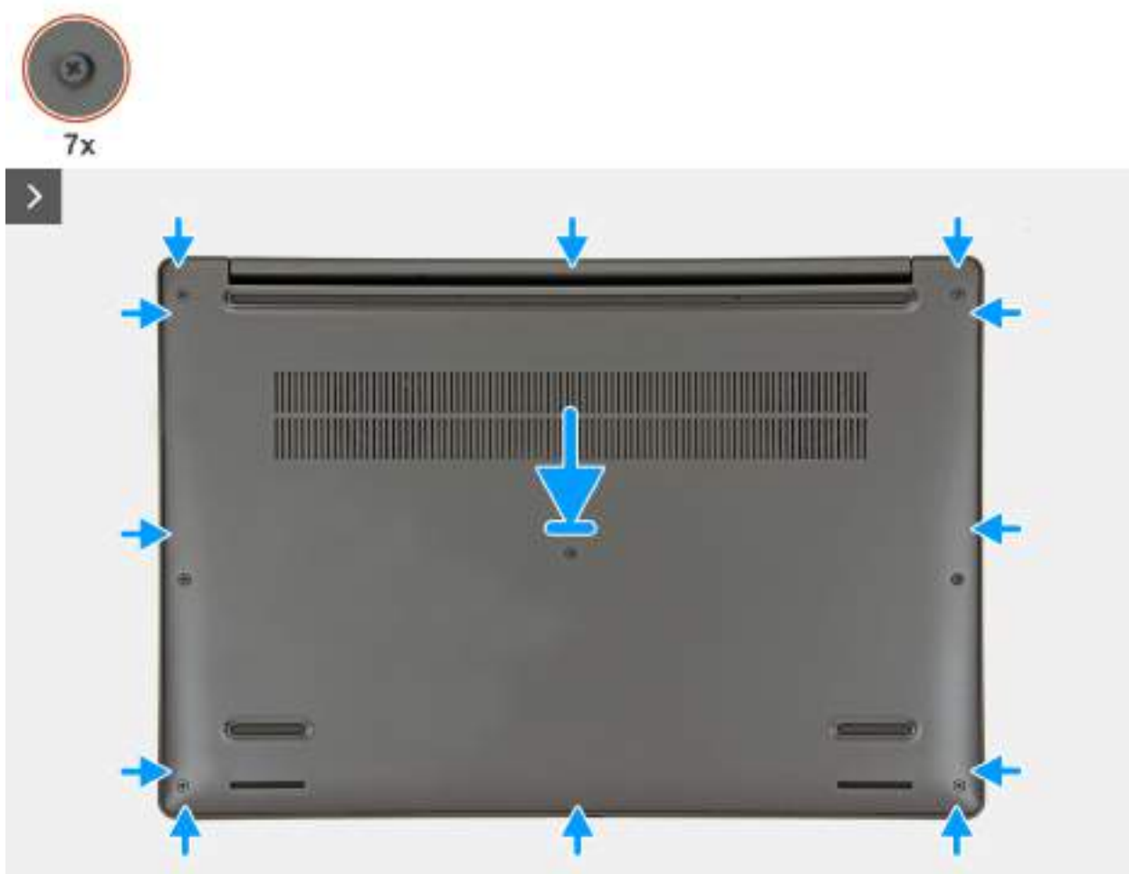
Obrázek 18. Installing the base cover
