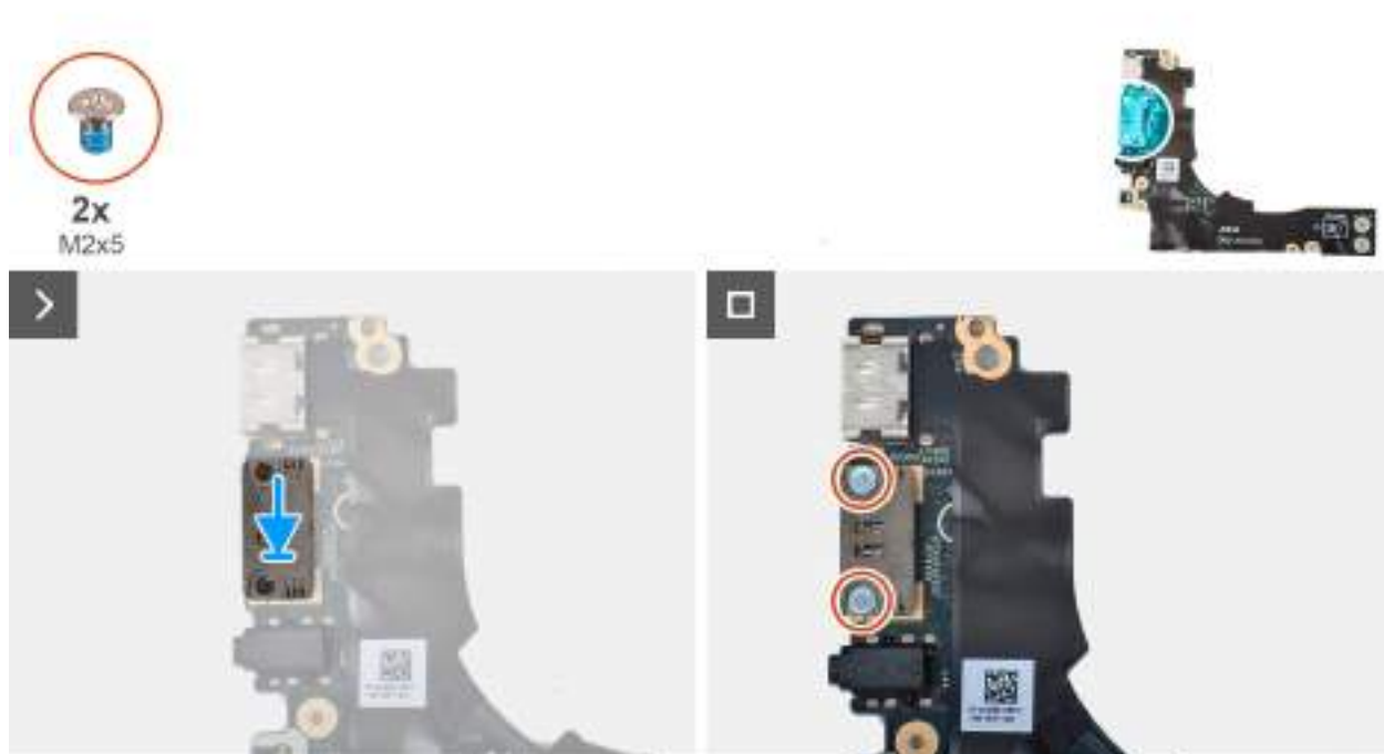
Obrázek 55. Removing the right USB Type-C module
