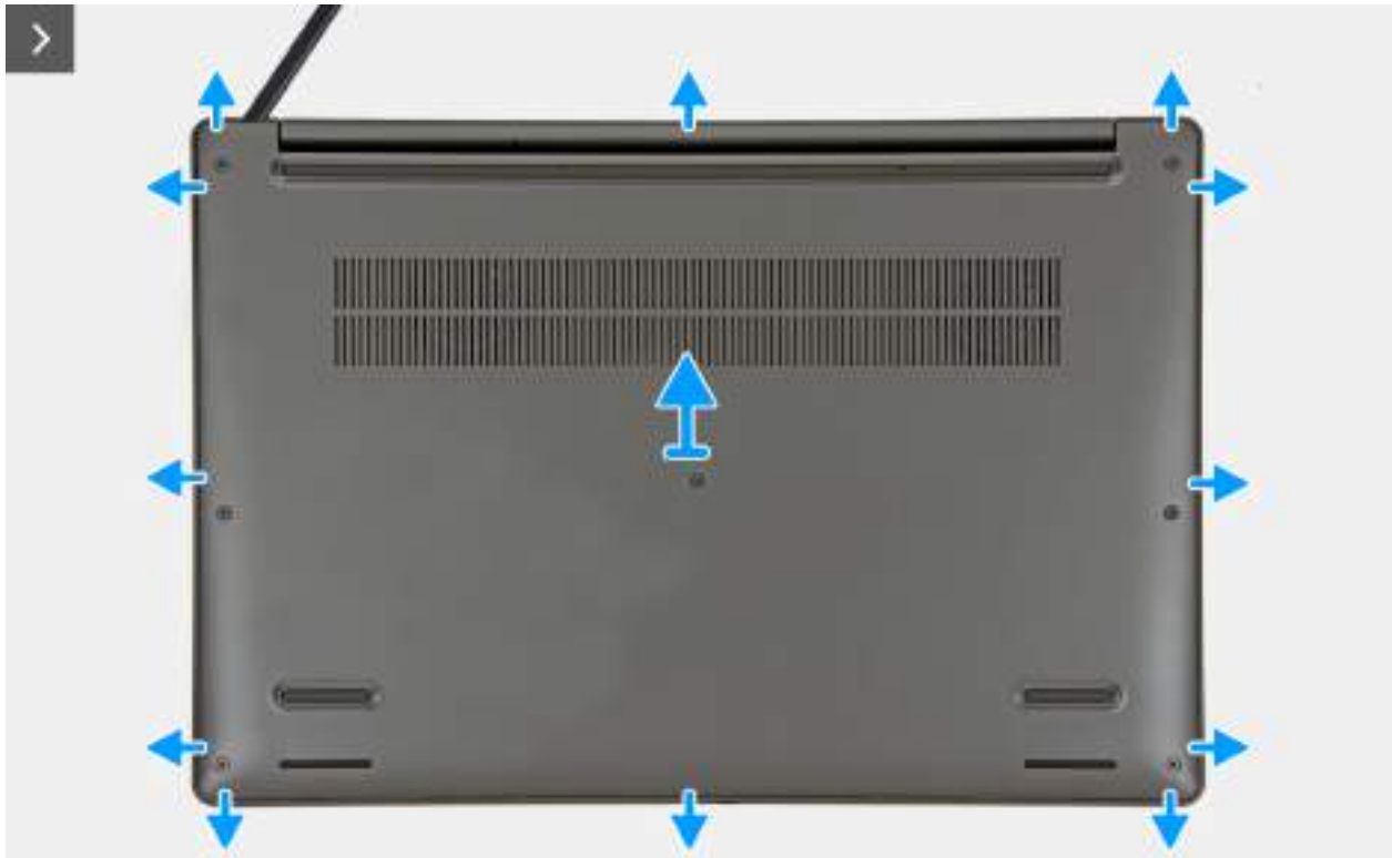
Obrázek 15. Removing the base cover
