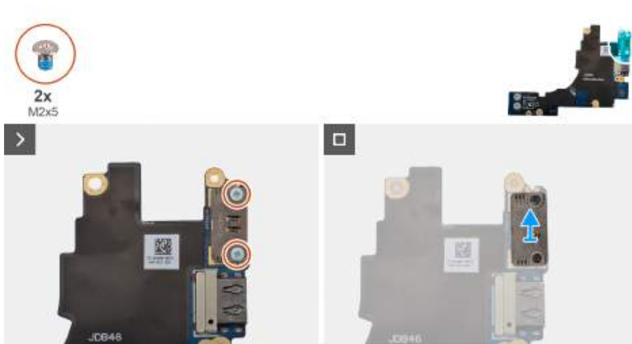
Obrázek 53. Removing the left USB Type-C module
