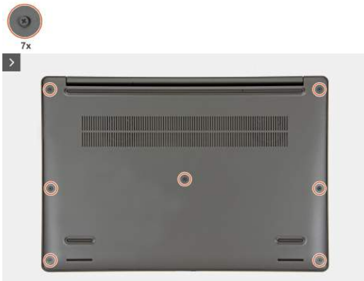
Obrázek 14. Loosen the captive screws
