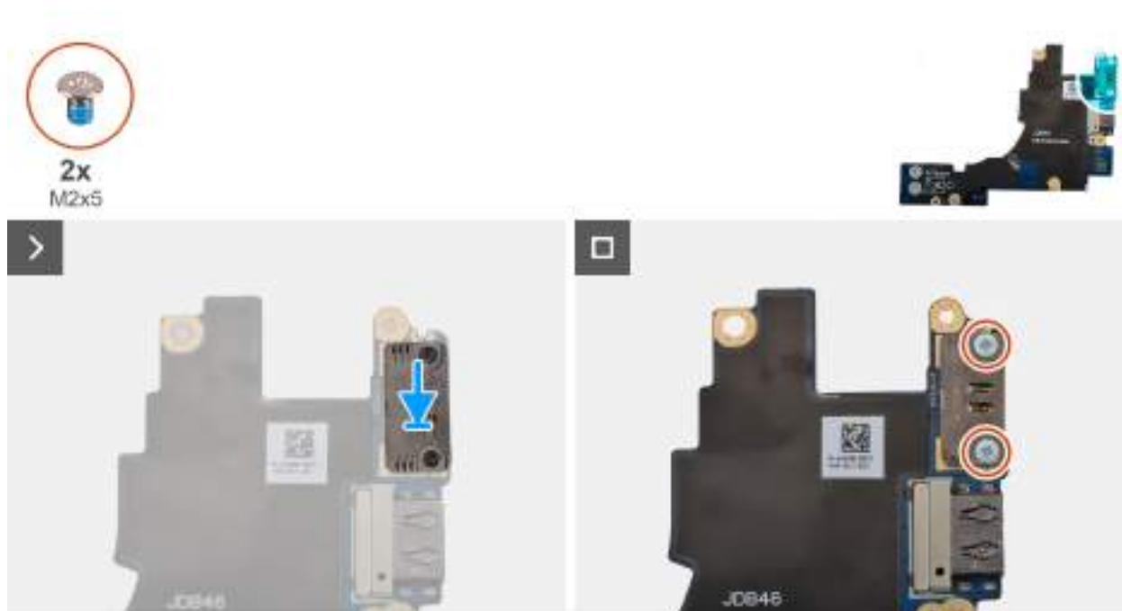
Obrázek 54. Installing the left USB Type-C module
