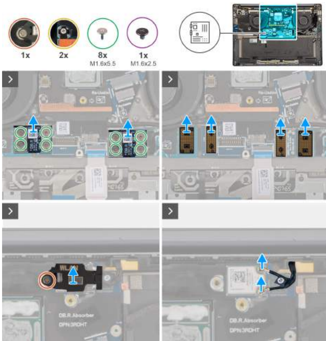
Obrázek 65. Removing the system board
