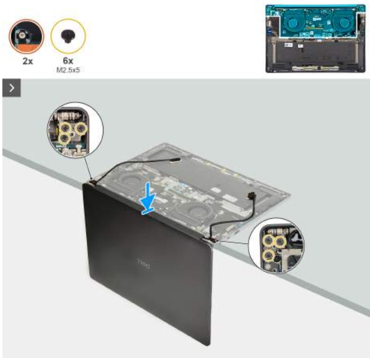
Obrázek 62. Installing the display assembly
