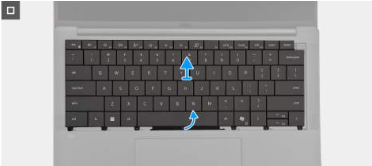
Obrázek 73. Removing the keyboard assembly
