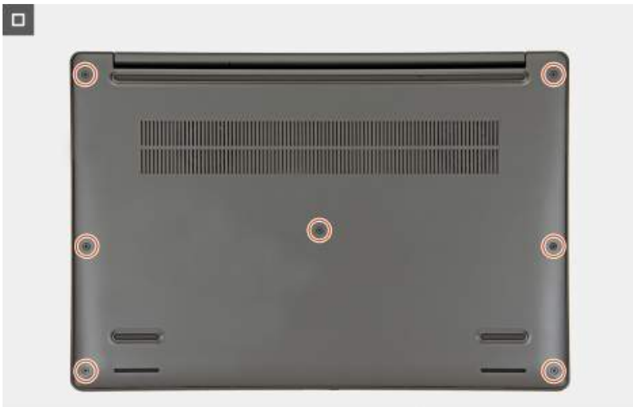
Obrázek 19. Tighten the captive screws
