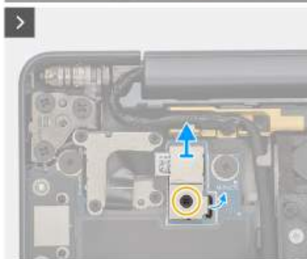
Obrázek 41. Removing the screws
