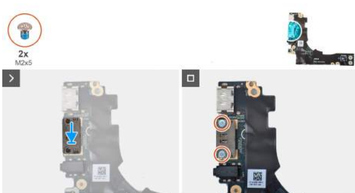
Obrázek 56. Installing the right USB Type-C module
