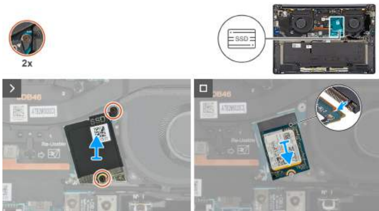
Obrázek 23. Removing the SSD
