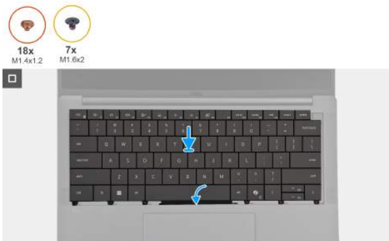
Obrázek 74. Installing the keyboard assembly
