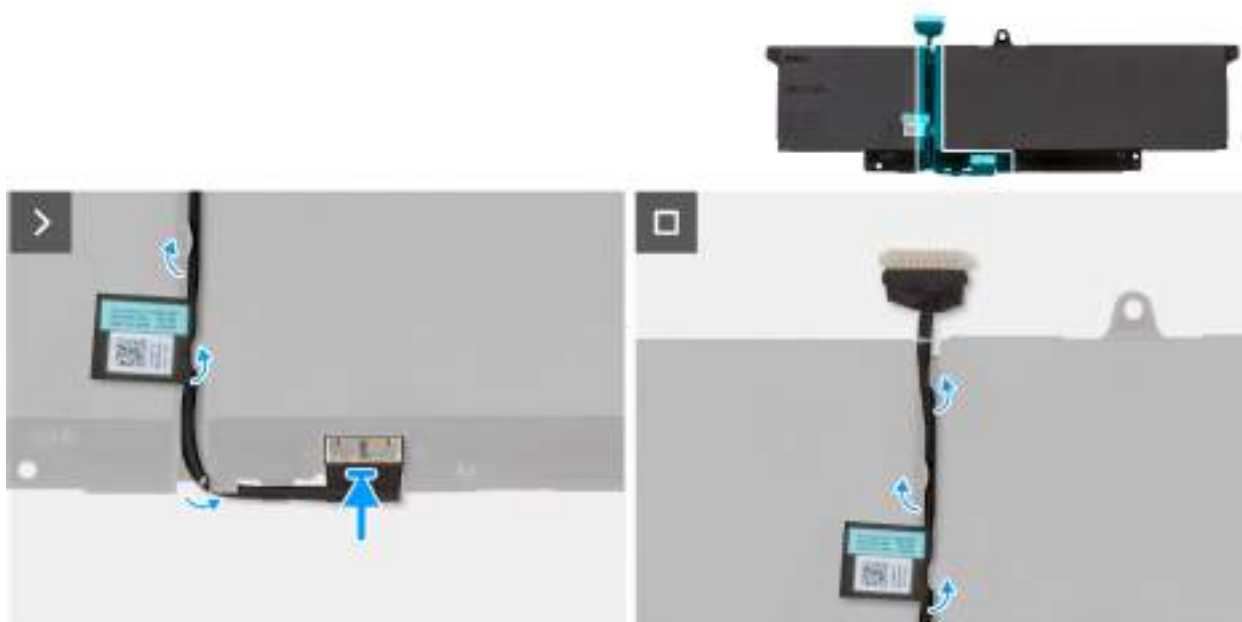
Obrázek 9. Vedení kabelu baterie
