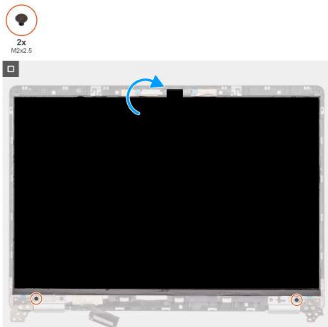
Obrázek 54. Montáž obrazovky displeje
