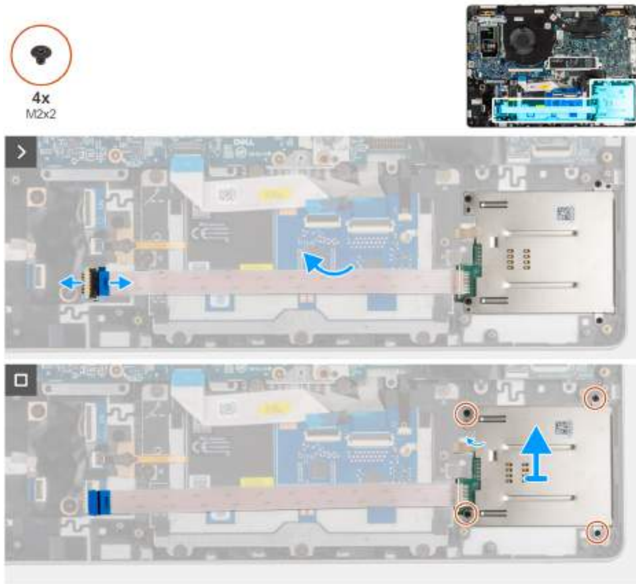
Obrázek 24. Demontáž čtečky čipových karet
