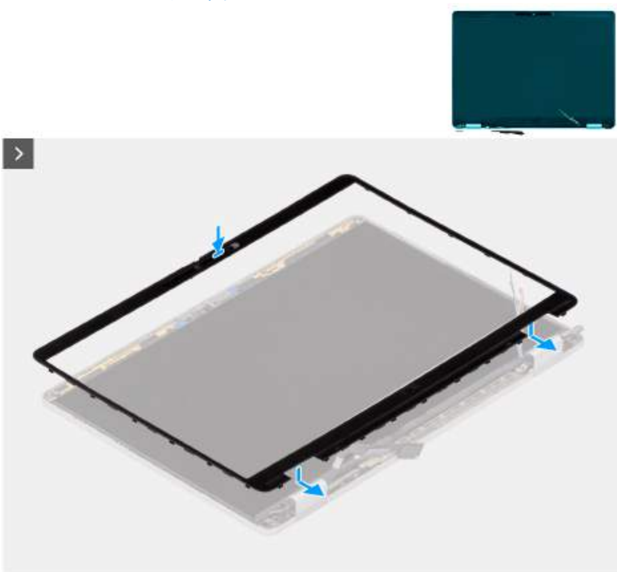
Obrázek 48. Montáž čelního krytu displeje
