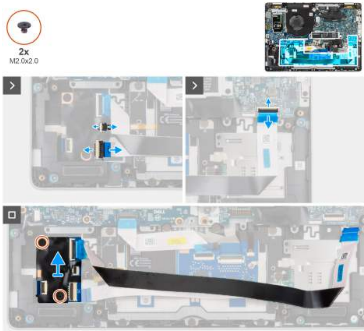
Obrázek 22. Demontáž dceřiné desky USH
