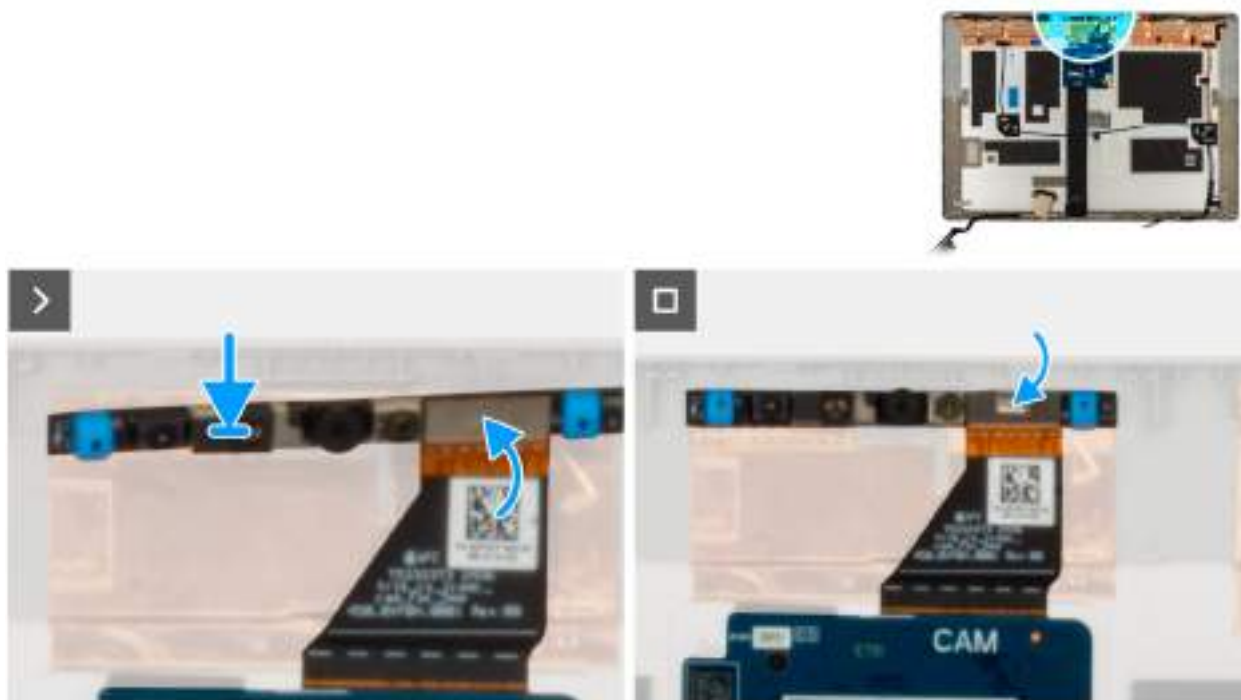
Obrázek 39. Instalace kabelu modulu kamery
