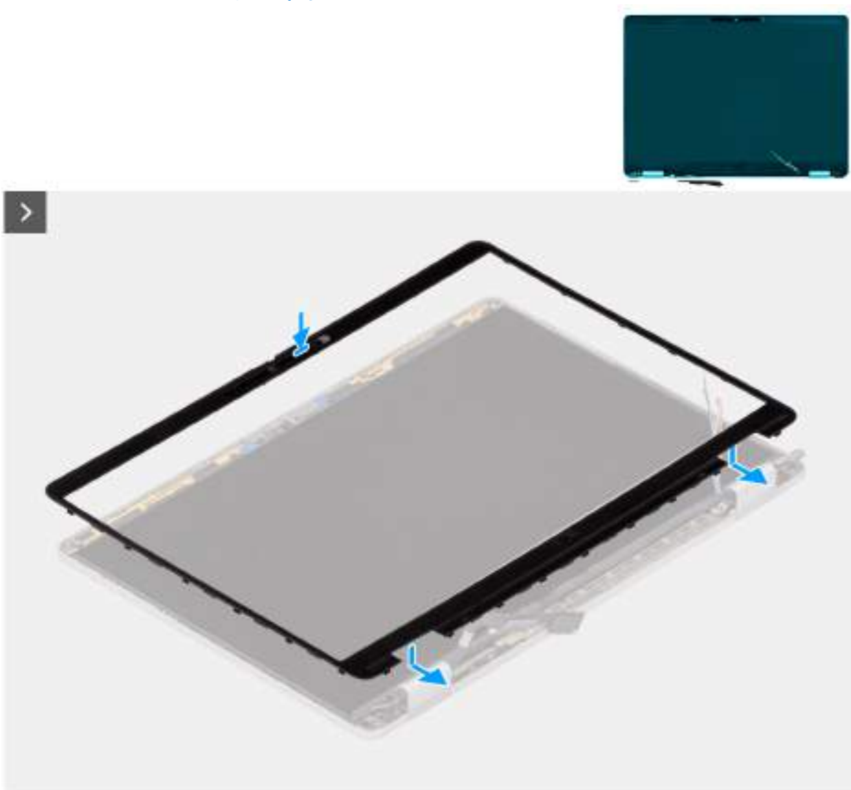
Obrázek 29. Montáž čelního krytu displeje
