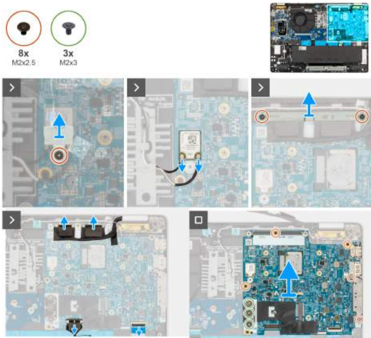
Obrázek 49. Demontáž základní desky
