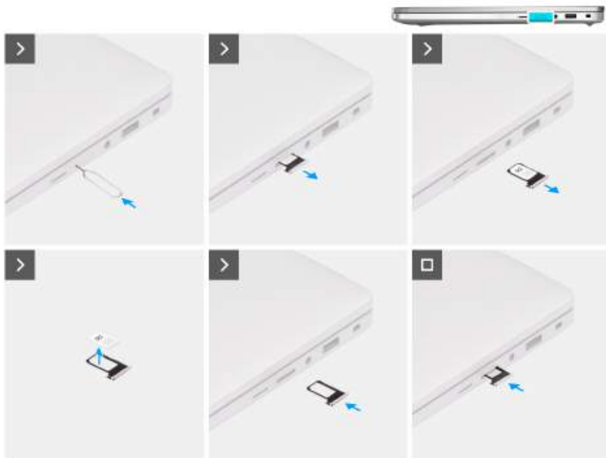
Obrázek 4. Vyjmutí držáku karty SIM
