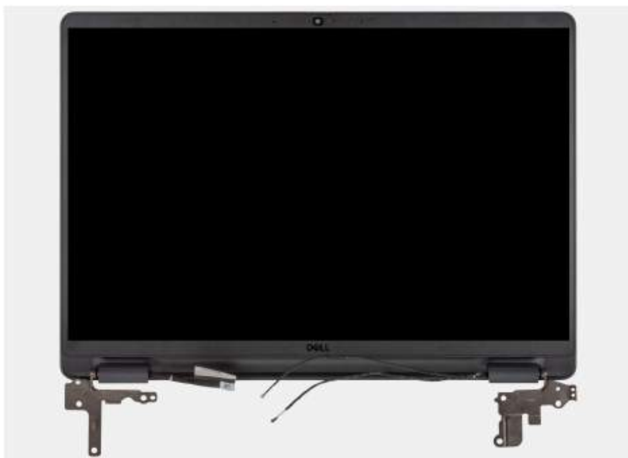
Obrázek 74. Demontáž sestavy displeje
