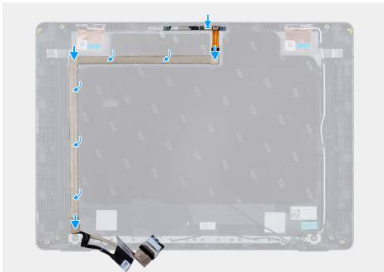
Obrázek 95. Montáž kabelu eDP
