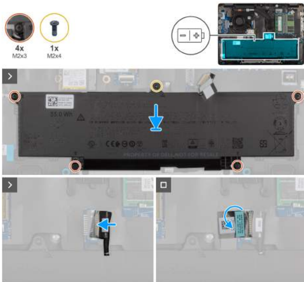
Obrázek 18. Vložení baterie
