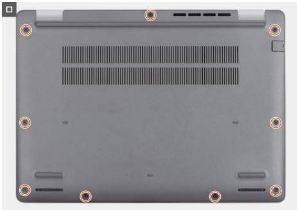
Obrázek 16. Nasazení spodního krytu
