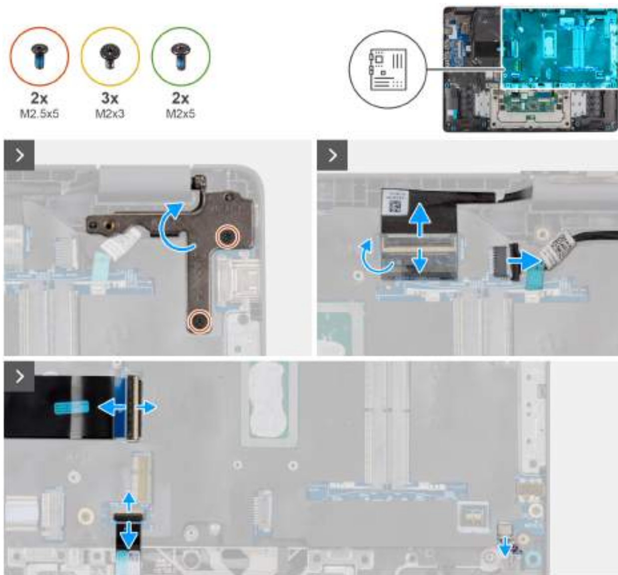
Obrázek 47. Demontáž základní desky
