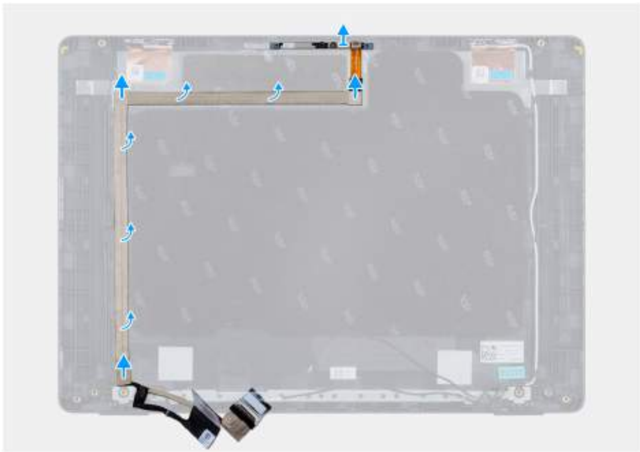
Obrázek 94. Vyjmutí kabelu eDP
