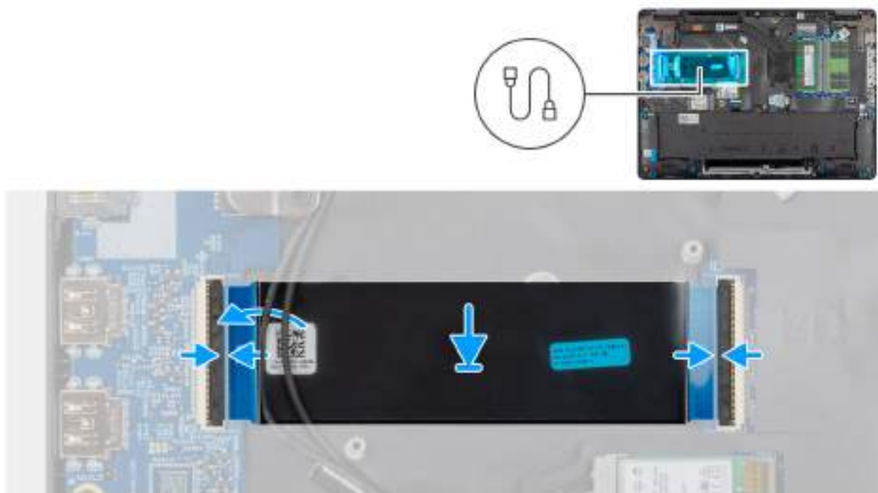
Obrázek 43. Montáž kabelu FPC desky I/O
