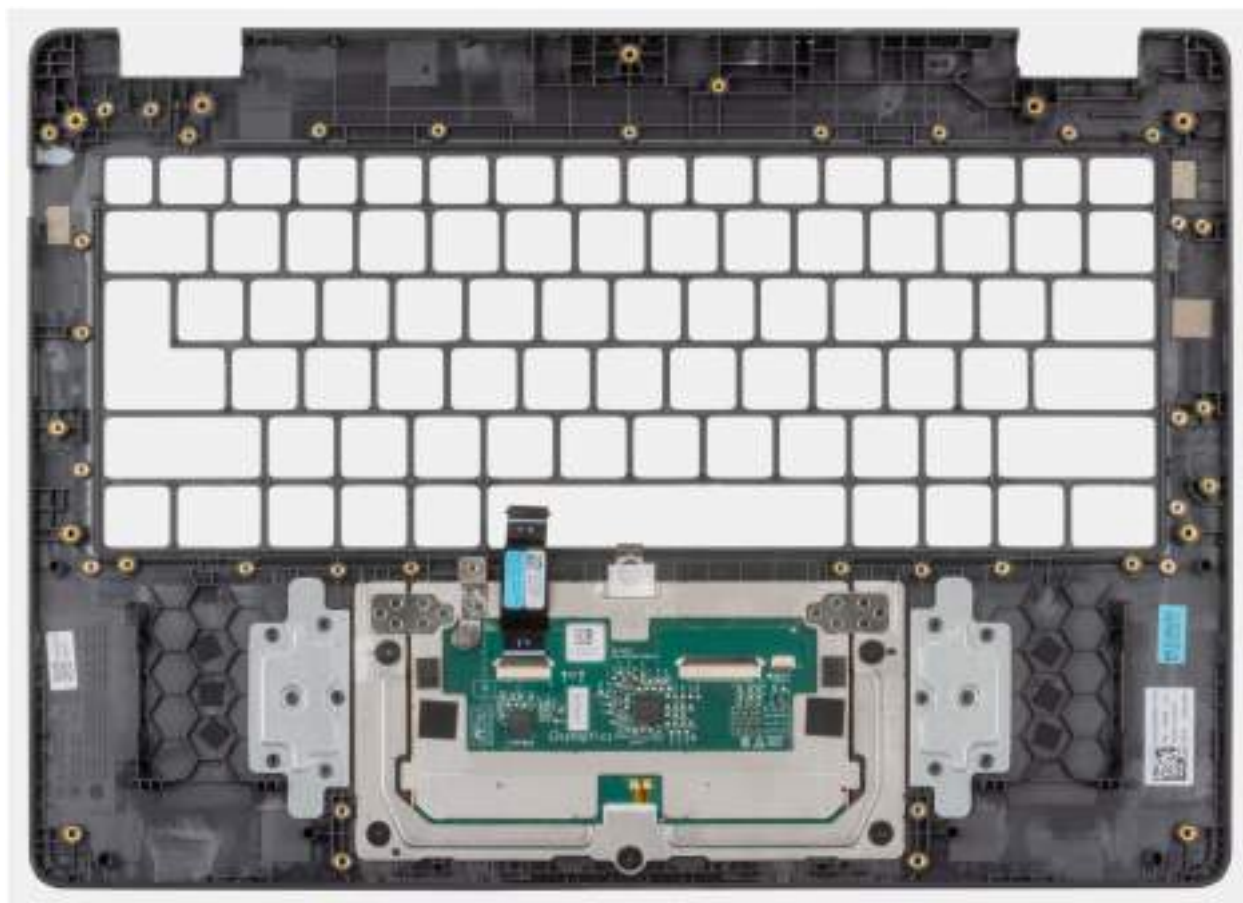
Obrázek 71. Montáž sestavy opěrky pro dlaň
