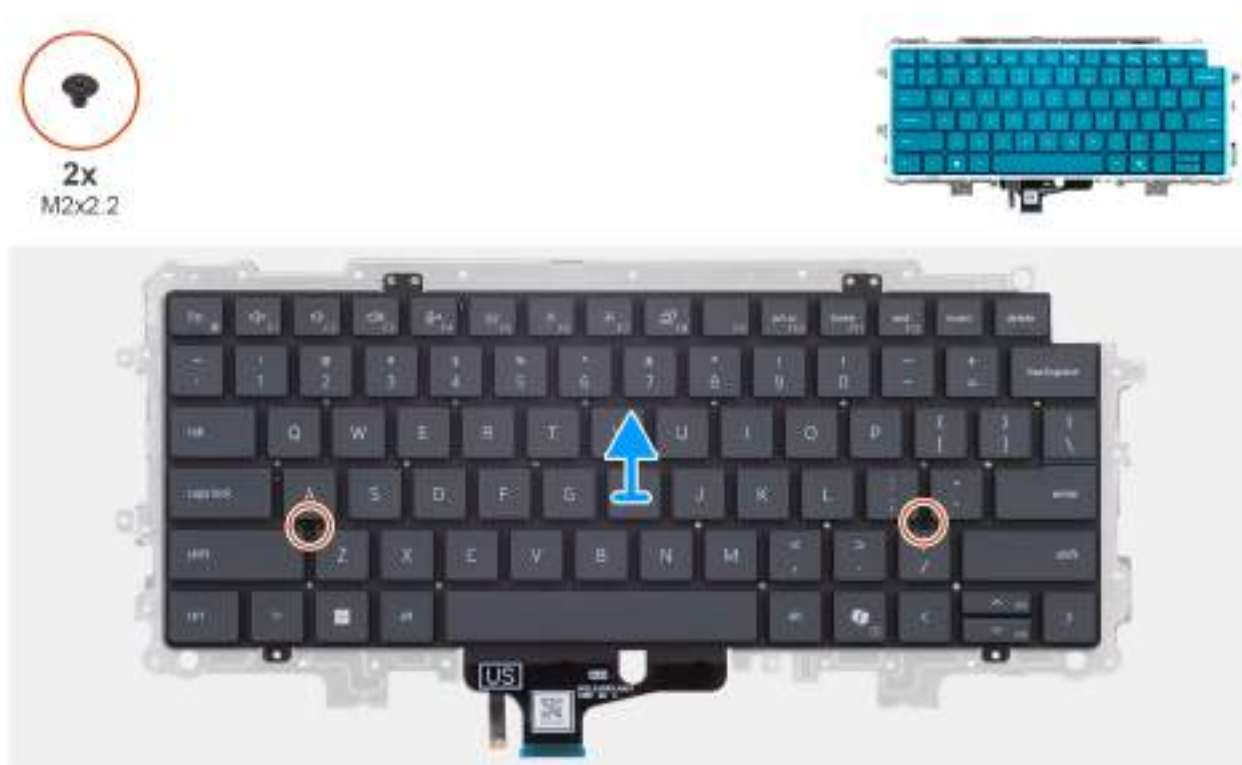
Obrázek 66. Demontáž podpůrné desky klávesnice
