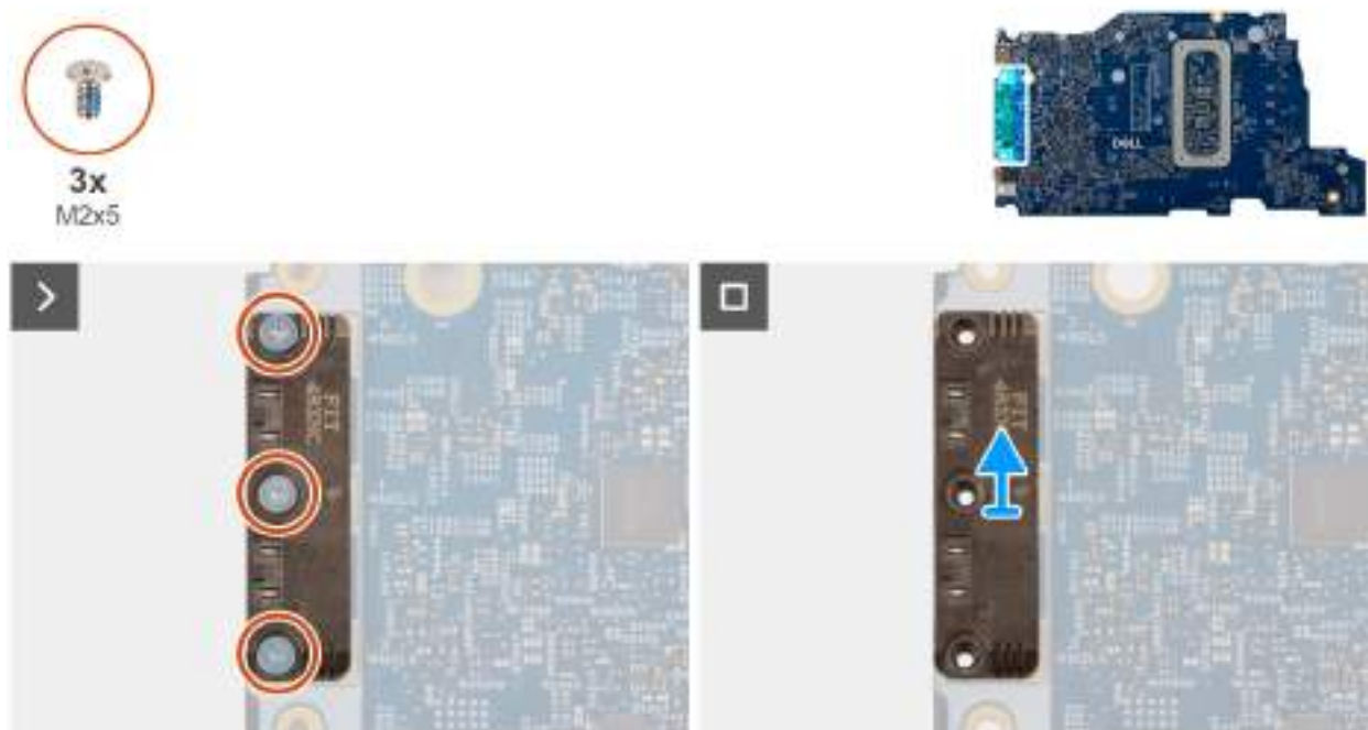
Obrázek 58. Demontáž modulu USB Type-C
