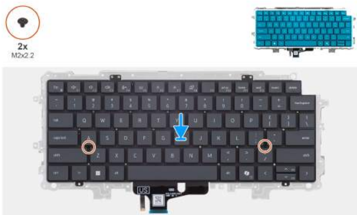
Obrázek 69. Montáž podpůrné desky klávesnice
