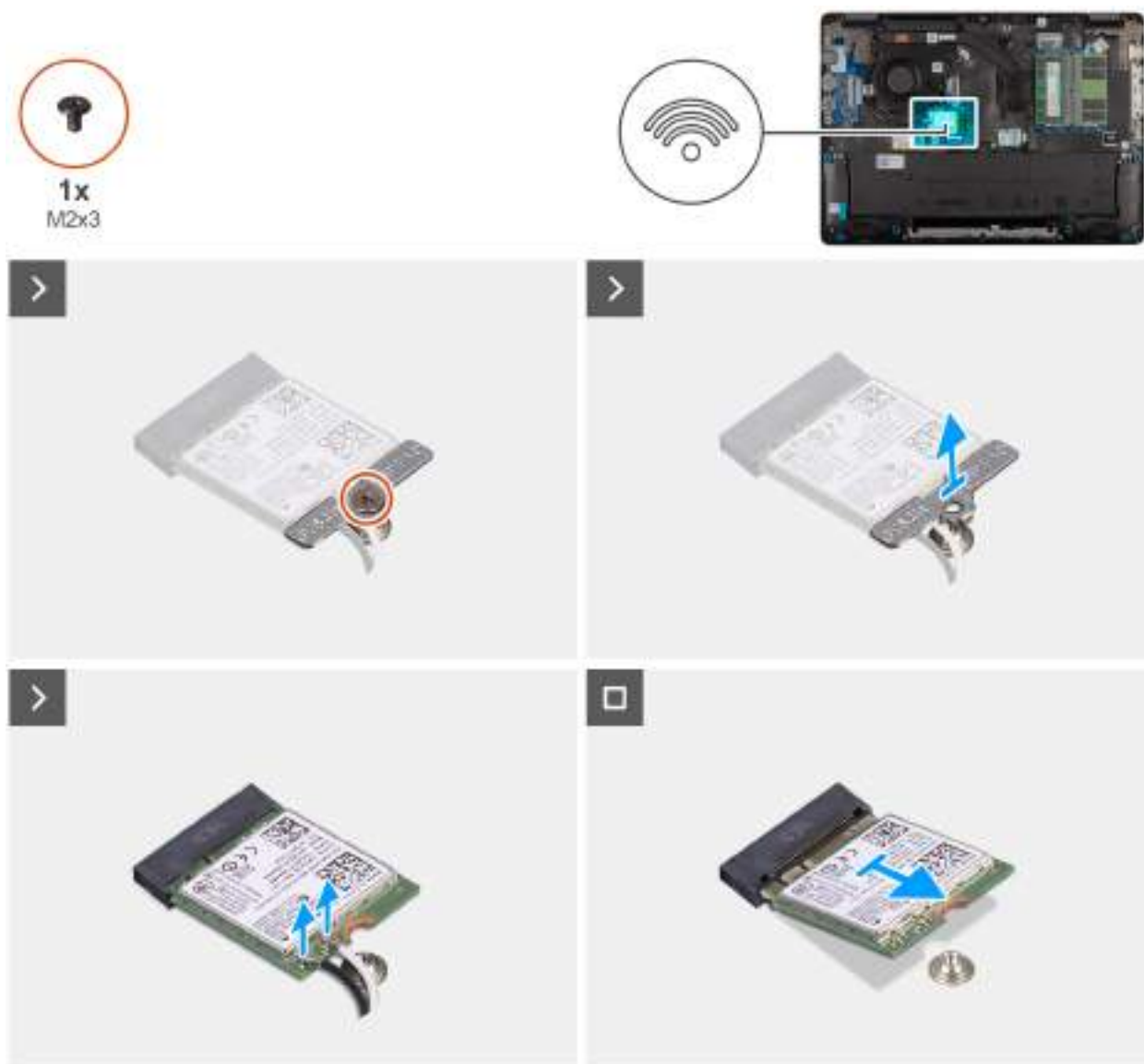
Obrázek 25. Demontáž bezdrátové karty
