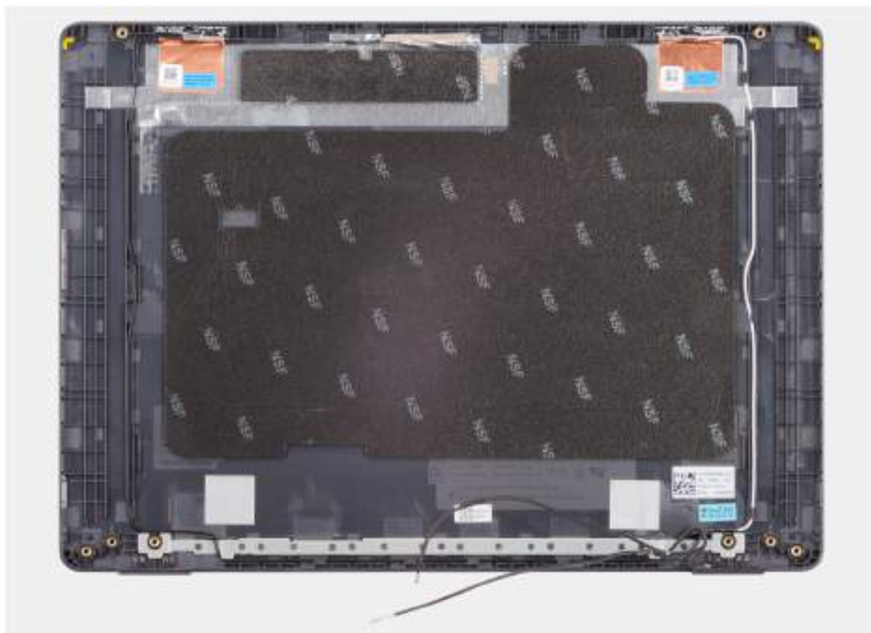
Obrázek 97. Montáž sestavy zadního krytu displeje
